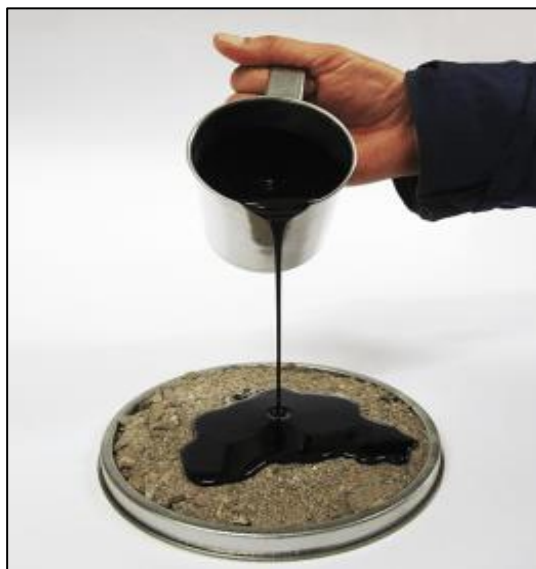
Figura 6. asfalto en estado líquido MC-30.
