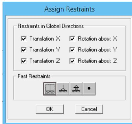
Figura 42 Apoyos fijos en la base en el software E.T.A.B.S.
