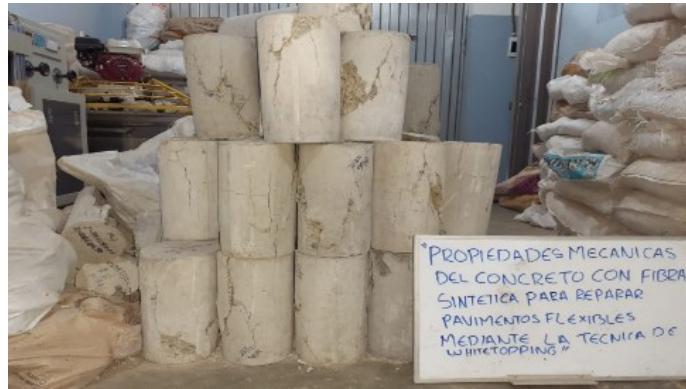
Fotografía 16. Probetas después de las roturas.
