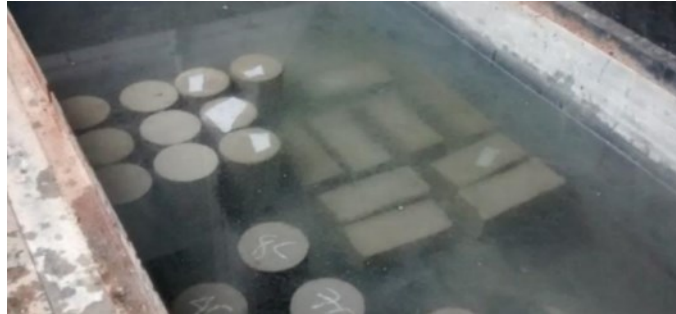
Fotografía 10. Curado de las probetas y viga.
