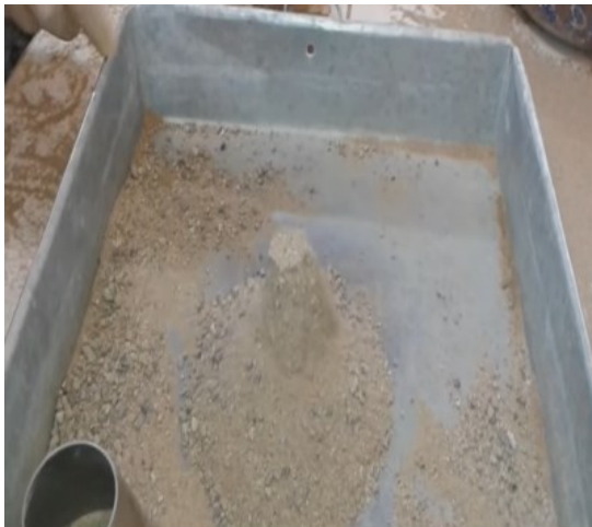
Fotografía 3. Agregado fino en la prueba cónico y uso del picnómetro.
