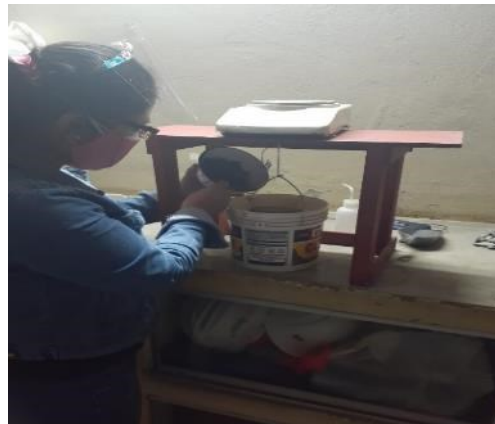
Fotografía 2. Agregado grueso sumergido y peso sumergido dentro de la canastilla.
