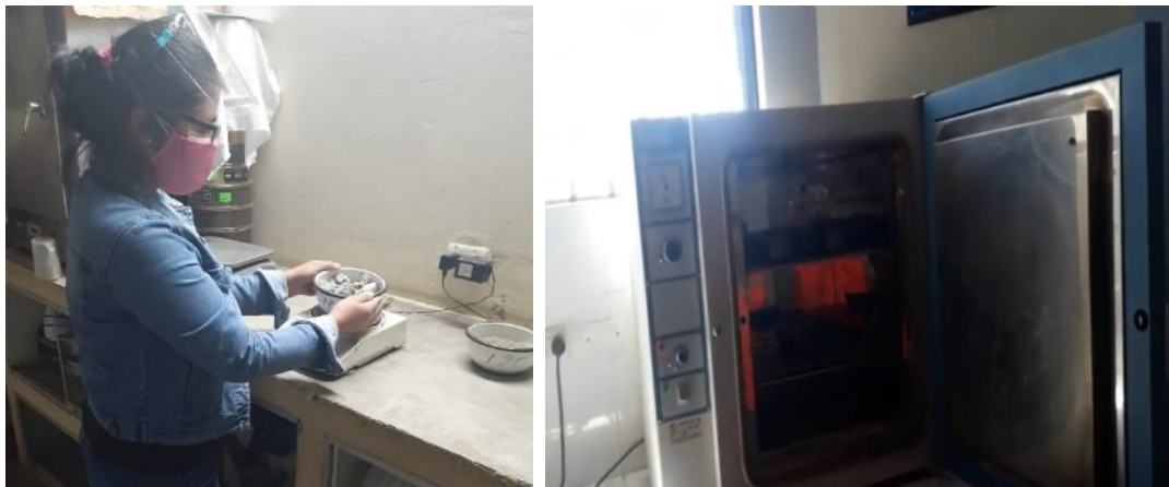
Fotografía 1. Muestra del agregado y secado en el horno.
