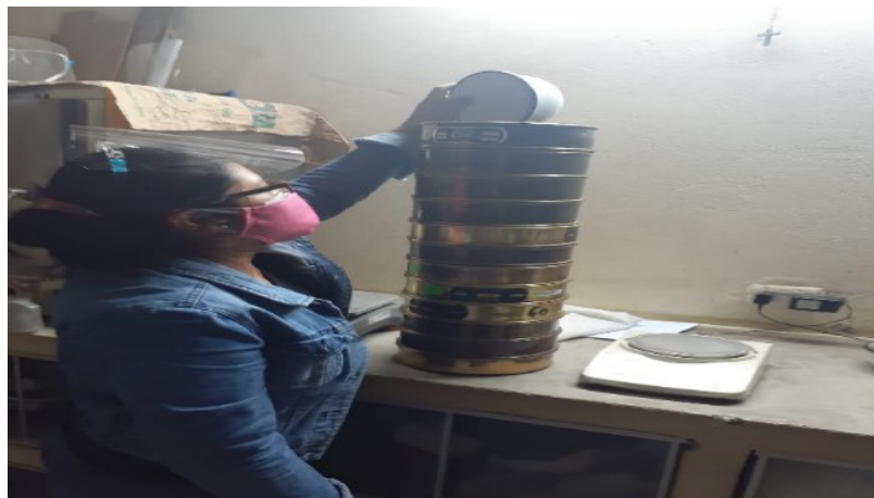
Fotografía 6. Tamizado del agregado grueso.
