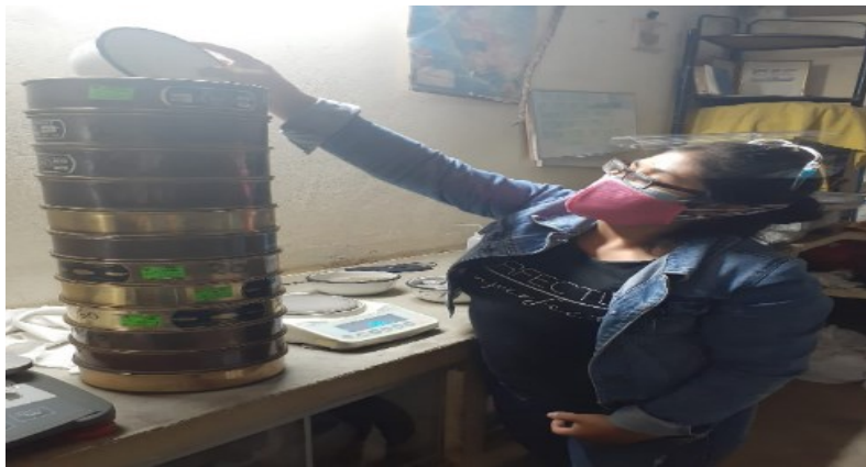
Fotografía 7. Tamizado del agregado fino.
