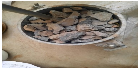
Fotografía 4. Compactado del agregado grueso
