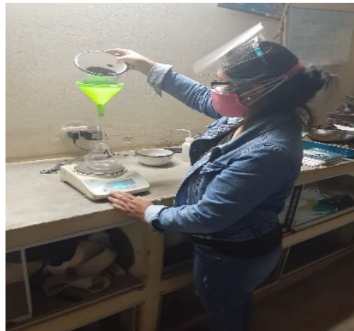
Fotografía 3. Agregado fino en la prueba cónico y uso del picnómetro.
