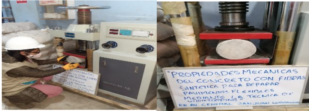
Fotografía 13. Ensayo de resistencia a la tracción por comprensión diametral
