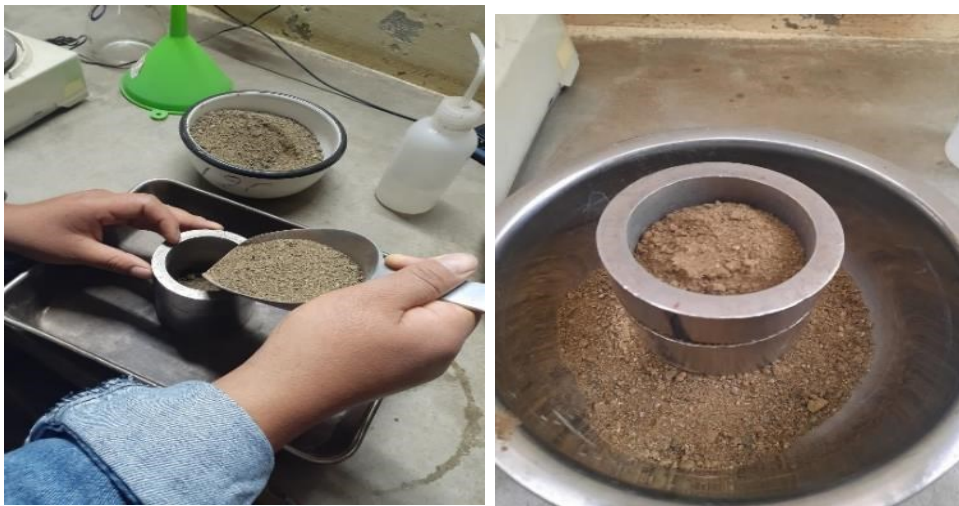
Fotografía 5. Compactado de agregado fino.
