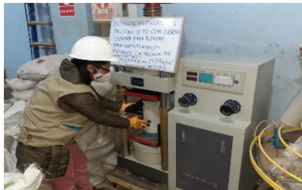
Fotografía 14. Ensayo de resistencia a compresión.
