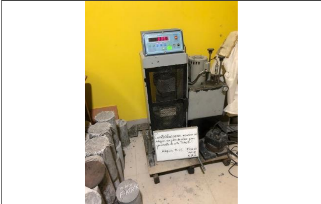
Vista 24: Ensayo A Compresión De La Muestra M-25
