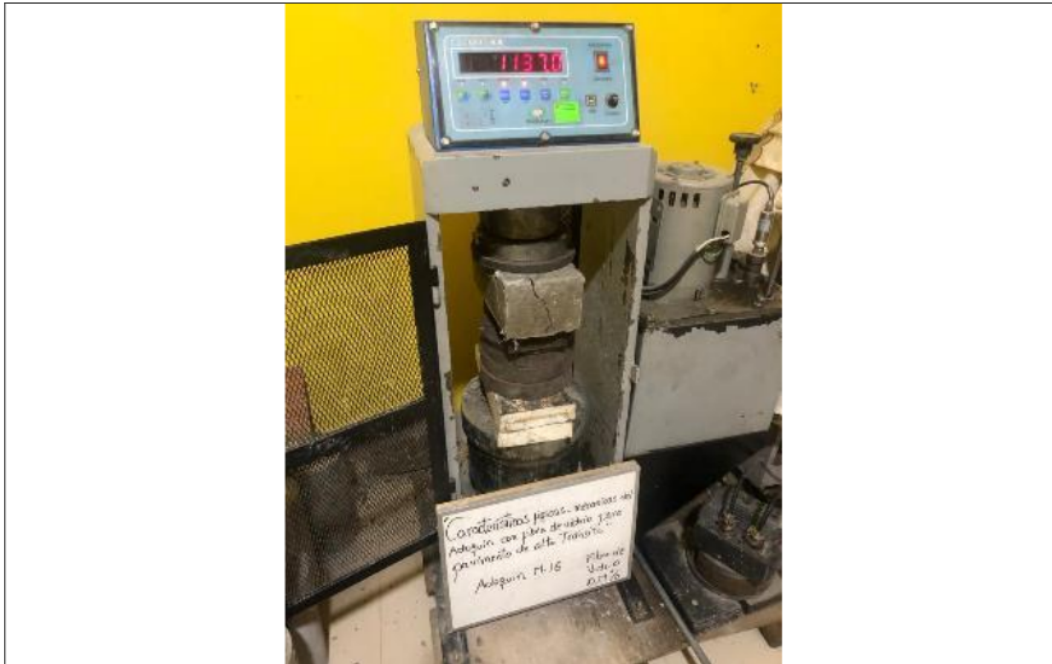
Vista 21: Ensayo A Compresión De La Muestra M-16
