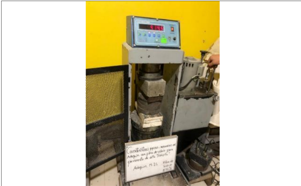
Vista 25: Ensayo A Compresión De La Muestra M-26
