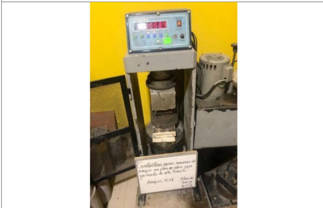
Vista 22: Ensayo A Compresión De La Muestra M-17
