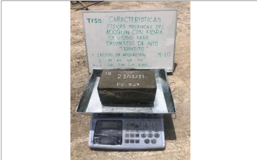
Vista 15: Ensayo de absorción y peso de adoquín M-10.
