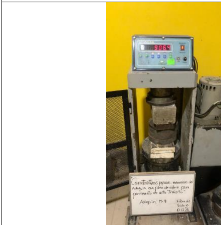
Vista 20: Ensayo A Compresión De La Muestra M-9
