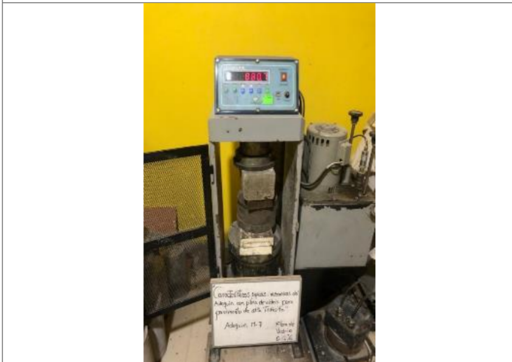
Vista 18: Ensayo A Compresión De La Muestra M-7
