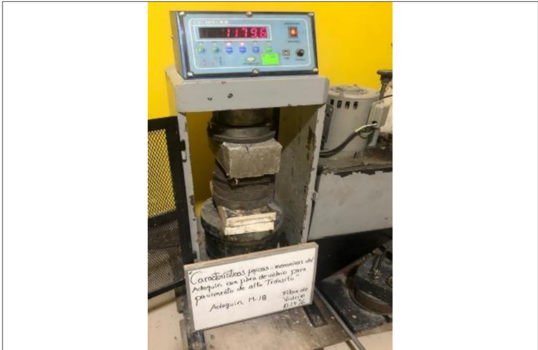
Vista 23: Ensayo A Compresión De La Muestra M-18
