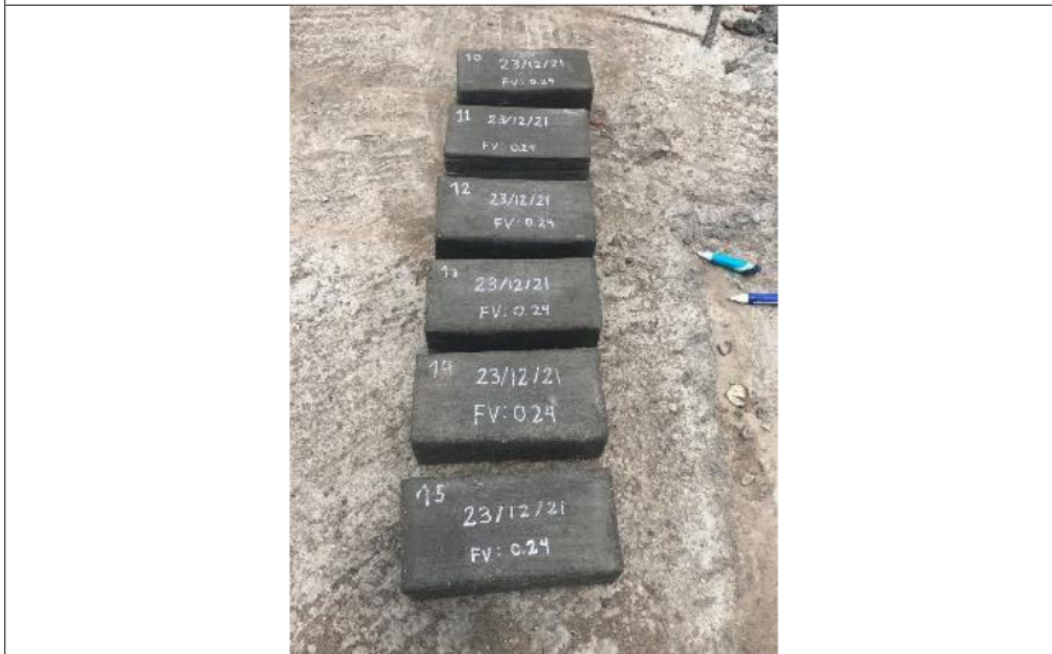
Vista 14: Desencofrado de adoquín y colocación los datos de la muestra.
