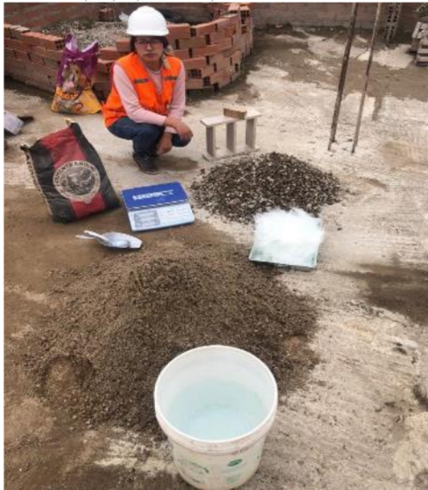
Vista 01: Vista panorámica de materiales; AG, AF, CEMENTO, AGUA Y FIBRA.
