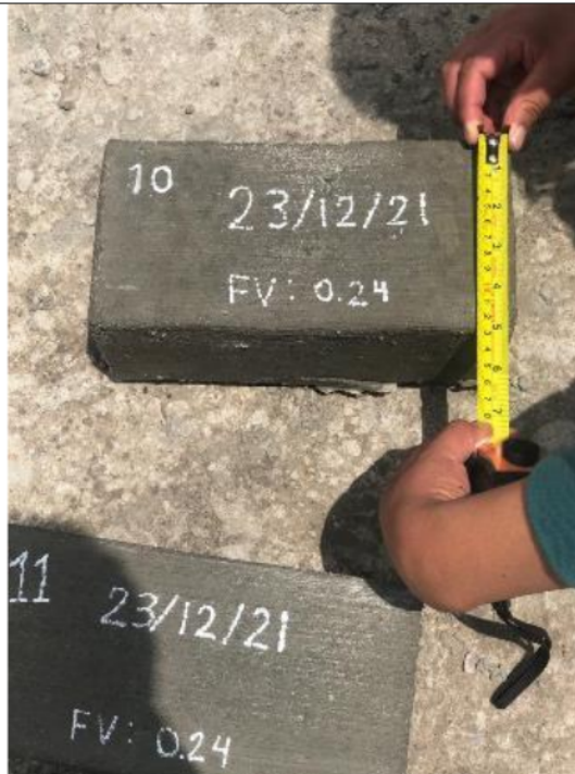
Vista 11: Medida de ancho de adoquín 12.5 cm.
