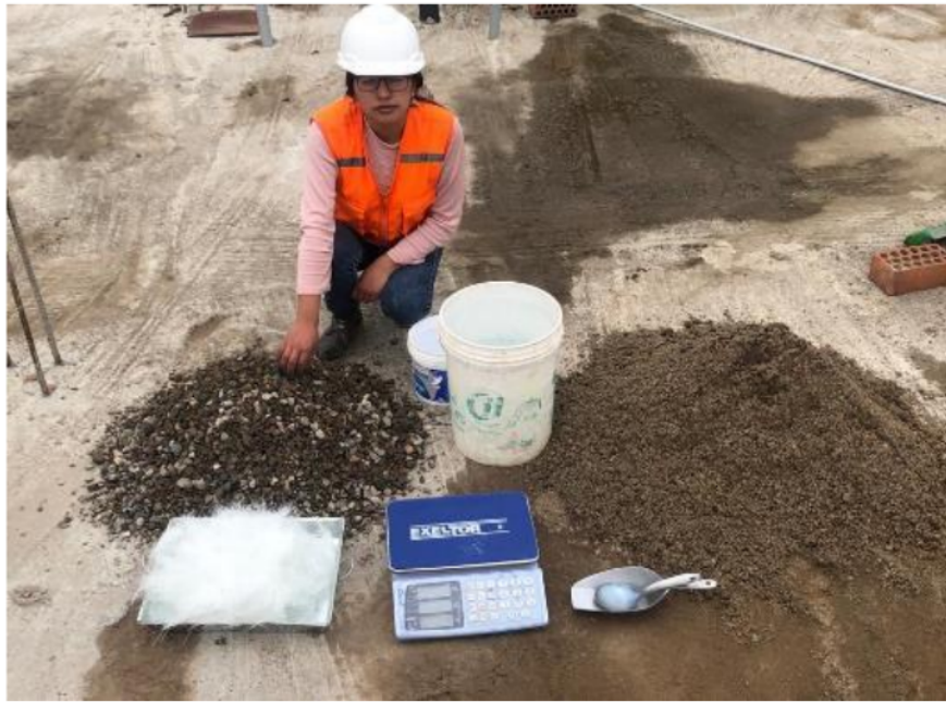
Vista 01: Vista panorámica de materiales; AG, AF, CEMENTO, AGUA Y FIBRA.
