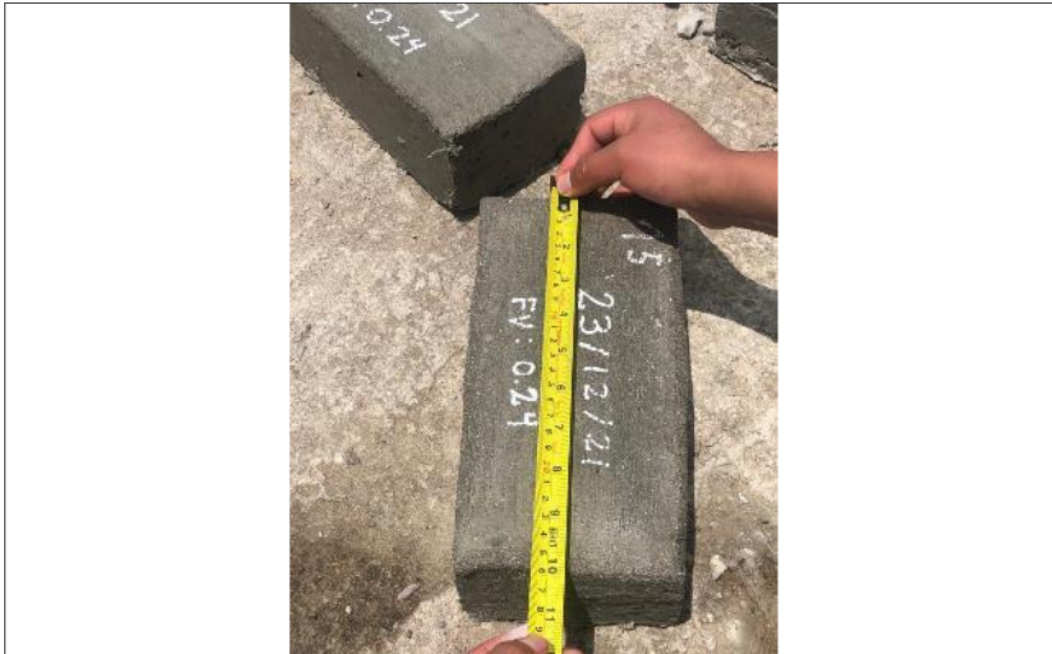
Vista 13: Medida de largo de adoquín 25 cm y E:10 cm.
