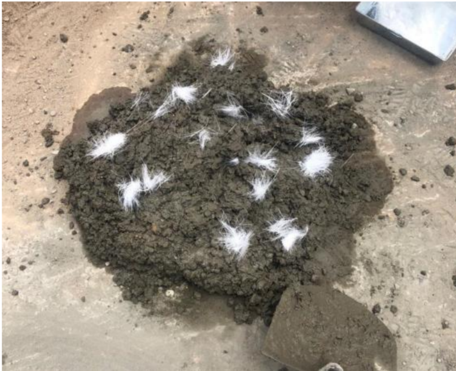
Vista 08: mezcla de Fibra de vidrio con el concreto.
