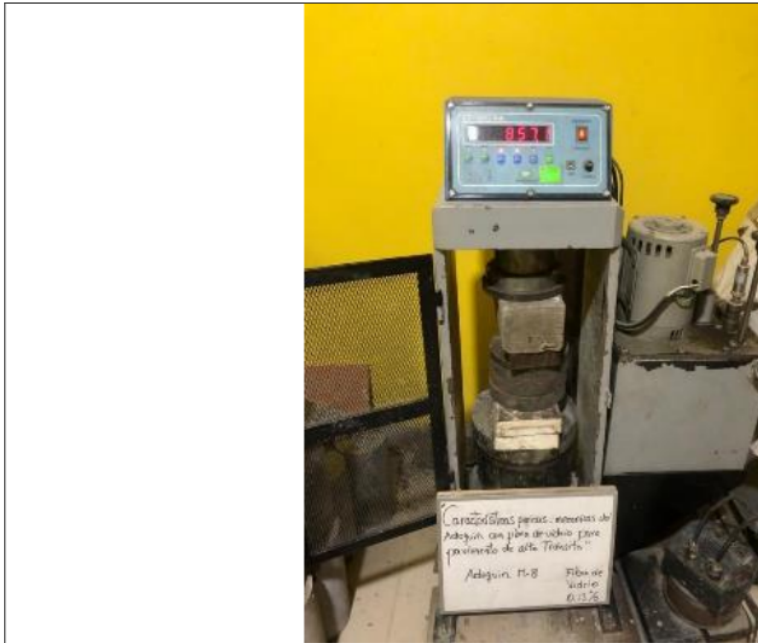
Vista 19: Ensayo A Compresión De La Muestra M-8
