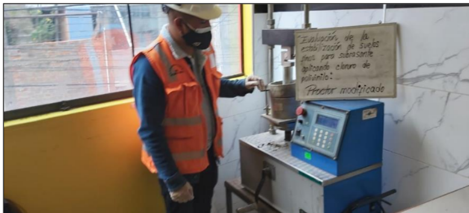
Fotografía 8. Ejecución del ensayo de Proctor modificado.
