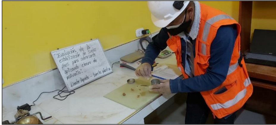
Fotografía 6. Vista de la realización de los cilindros con el suelo fino para determinar el límite plástico del suelo.
