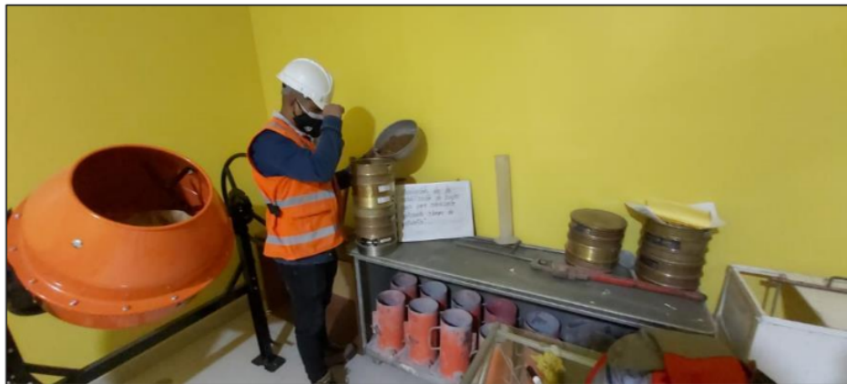
Fotografía 2. Ejecución del ensayo de análisis granulométrico del suelo.
