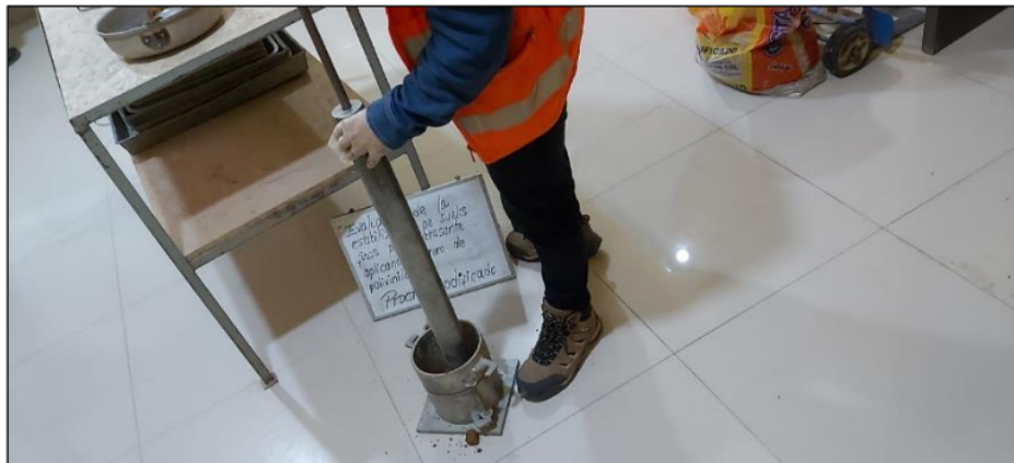
Fotografía 7. Compactación del suelo para realizar el ensayo de Proctor modificado.
