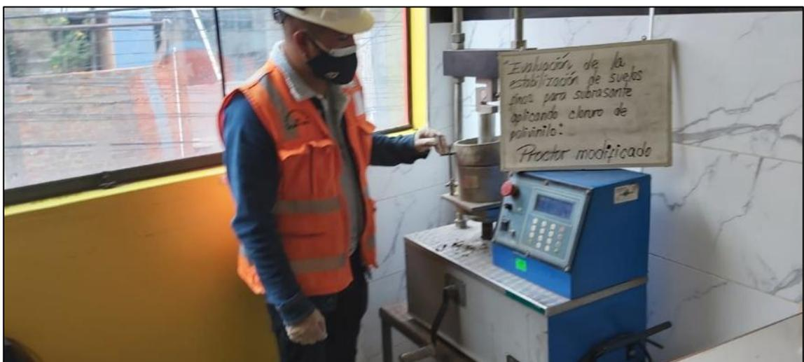
Fotografía 8. Ejecución del ensayo de Proctor modificado.
