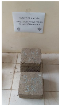
Grafico 61. Muestra 3% emulsión asfáltica - Succión
