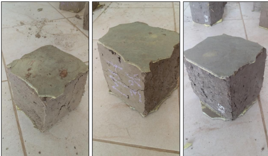
Muestras después del ensayo de resistencia a la compresión
