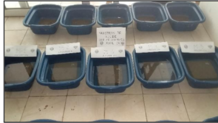
Grafico 74. Ensayo de absorción – unidades de adobe con 5% emulsión asfáltica
