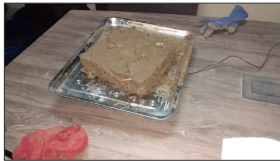
Las muestras de adobe tradicional no soportaron la prueba de absorción terminaron desintegrándose , haciéndose imposible el pesado
