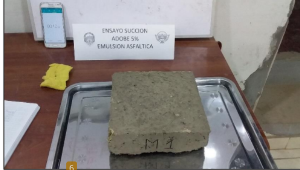
Grafico 66. Prueba de succión (1 min)
