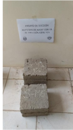
Grafico 60. Muestra 1% emulsión asfáltica – Succión
