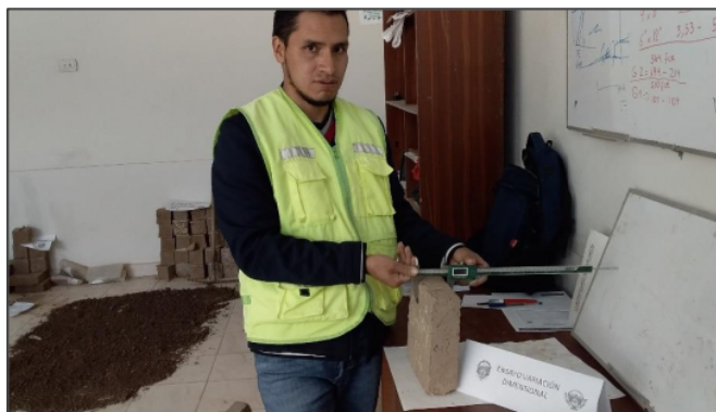
Grafico 58. Registro de datos - ensayo variación dimensional
