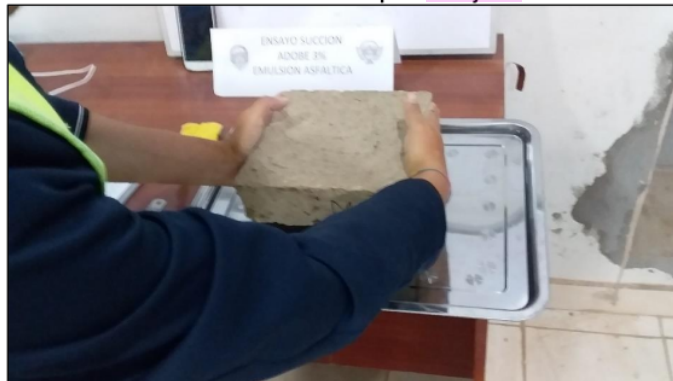
Grafico 65. Colocado de muestras para ensayo de succion
