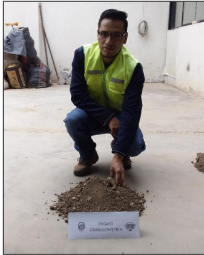
Selección de muestra y cuarteo para ensayo de granulometría
