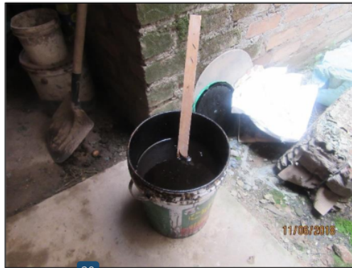
Grafico 44. Emulsión asfáltica de rotura rápida
