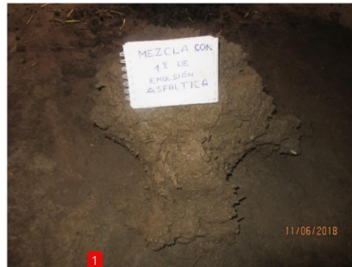
Grafico 46. Mezcla con 1% de emulsión asfáltica
