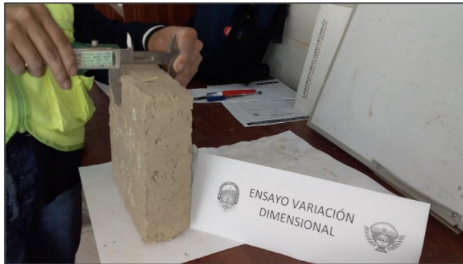
Grafico 57. Vernier digital utilizado para la medición
