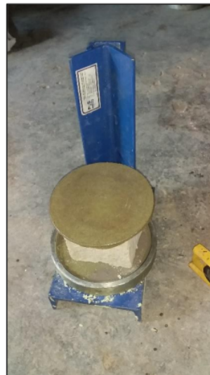
Refrentado de muestras con azufre y material pasante de la malla N° 100
