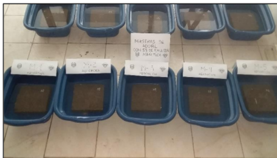
Muestras sumergidas con 3% y 5% de emulsión asfáltica (ensayo absorción)
