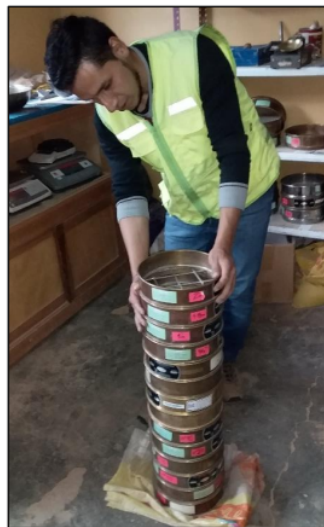
Proceso de tamizado de muestra
