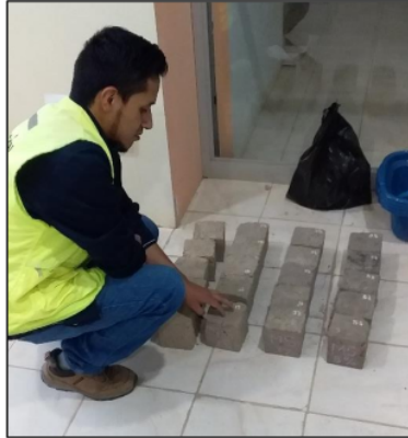
Grafico 76. Muestras para ensayo resistencia a la compresión
