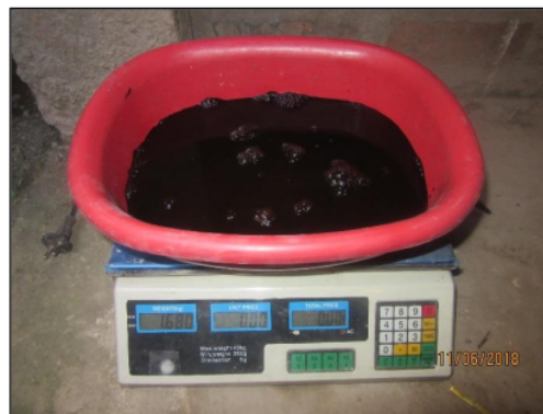
Grafico 45. Pesado de la emulsion asfaltica
