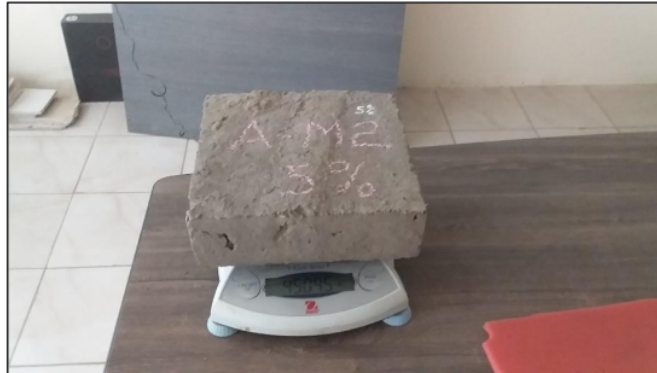
Grafico 70. Peso de las muestras – ensayo de absorción
