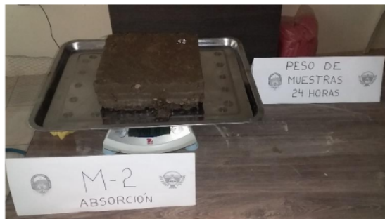
Pesado de las muestras de con 5% de emulsión asfáltica después de la inmersión (24 horas)
