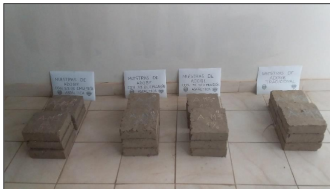
Grafico 69. Muestras preparadas para ensayo de absorción
