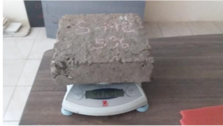
Pesado de muestras para el ensayo de succión
