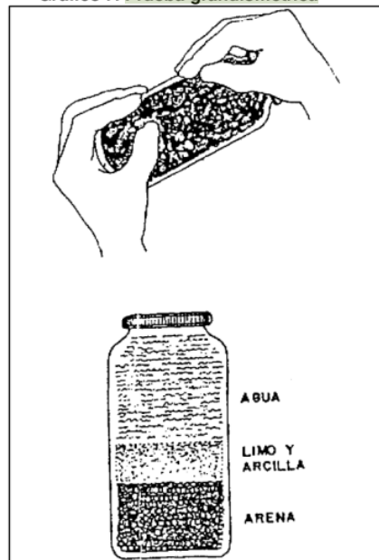
22 Grafico 7. Prueba granulométrica
