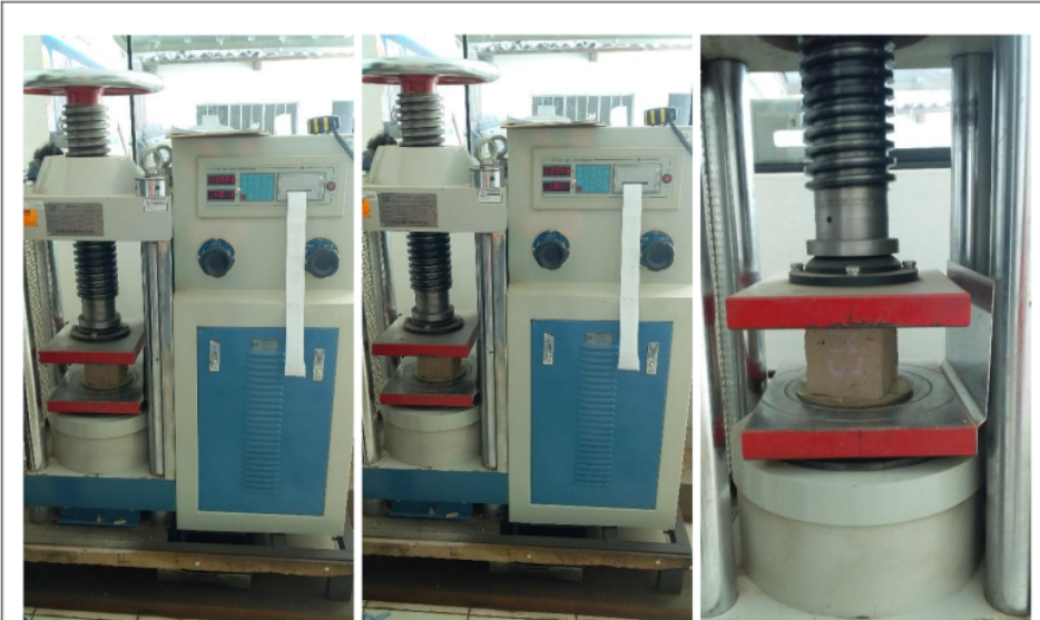
Ejecución del ensayo de resistencia a la compresión
