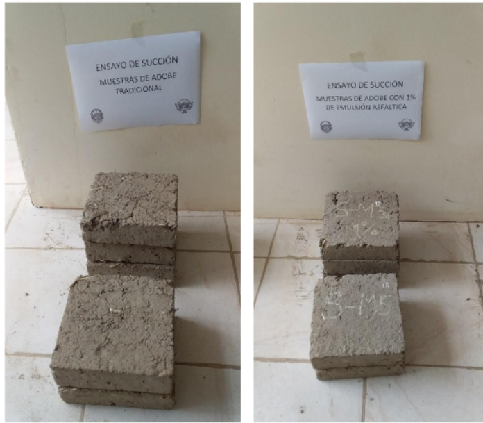
Muestras con incorporación de 0% y 1% de emulsión asfáltica para ensayo de succión
