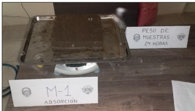
Grafico 75. Peso de las muestras después del ensayo de absorción
