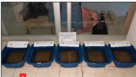
Grafico 71. Ensayo de absorción – unidad de albañilería de adobe tradicional
