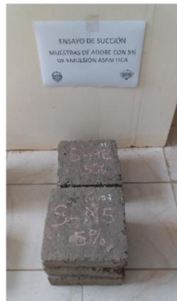
Grafico 62. Muestra 5% emulsión asfáltica – succión
