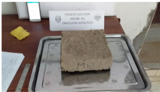
Colocado de muestra en la bandeja durante 1 min.
