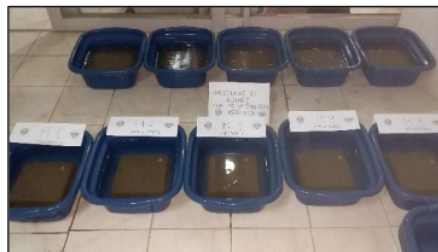
Grafico 72. Ensayo de absorción – unidades de adobe con 1% emulsión asfáltica
