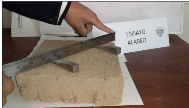
Grafico 55. Medición de alabeo para superficie cóncava
