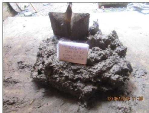
Grafico 48. Mezcla con 5% de emulsión asfáltica
