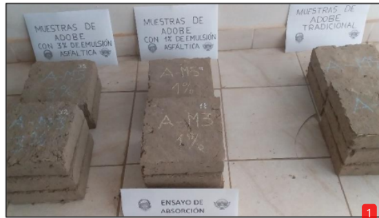
Muestras con incorporación de 0% y 1% de emulsión asfáltica para ensayo de absorción
