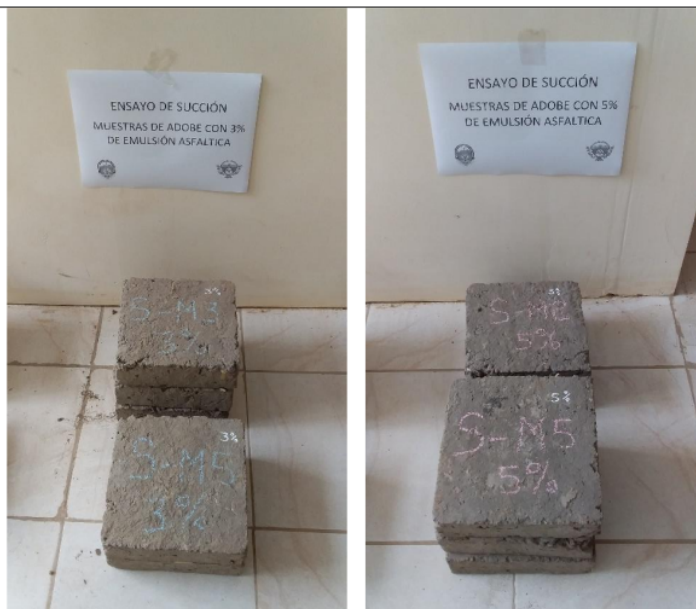
Muestras con incorporación de 3% y 5% de emulsión asfáltica para ensayo de succión
