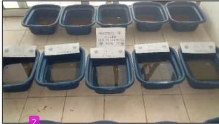
Grafico 73. Ensayo de absorción – unidades de adobe con 3% emulsión asfáltica
