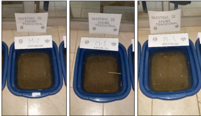
Las muestras de adobe tradicional no soportaron la prueba de absorción terminaron desintegrándose , haciéndose imposible el pesado
