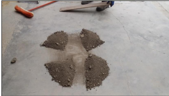
Grafico 51. Proceso de cuarteo para ensayo de granulometría
