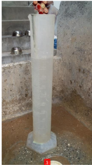
Probeta graduada de 500 ml para controlar cantidad de agua para ensayo de absorción
