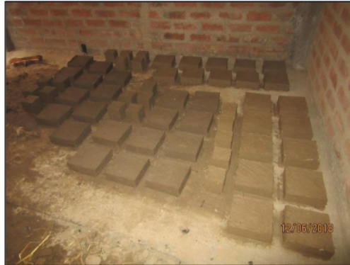
1 Grafico 49. Unidades de adobe tradicional y con incorporación de emulsión asfáltica al 1%,3% y 5%
