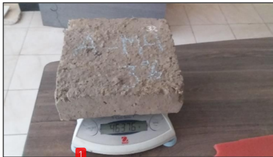
Pesado de muestras para ensayo de absorción
