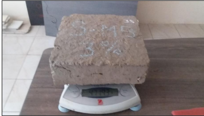
Gráfico 63. Pesado de muestras ensayo succión antes del ensayo
