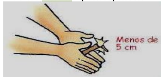
Grafico 9. Resultado 2 - prueba de plasticidad
