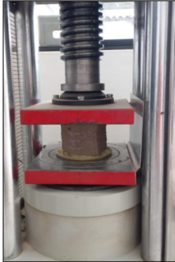
Grafico 80. Colocado de muestra en la maquina
