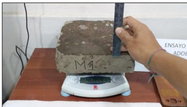
Grafico 68. Peso de la unidad después del ensayo de succión
