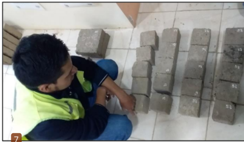
Muestras totales para ensayo de resistencia a la compresión
