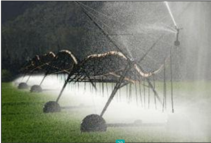
Figura 15. Sistema ramales desplazables de riego por aspersion Fuente: (Ministerio de Agricultura, Pesca y Alimentación, s.f.)
