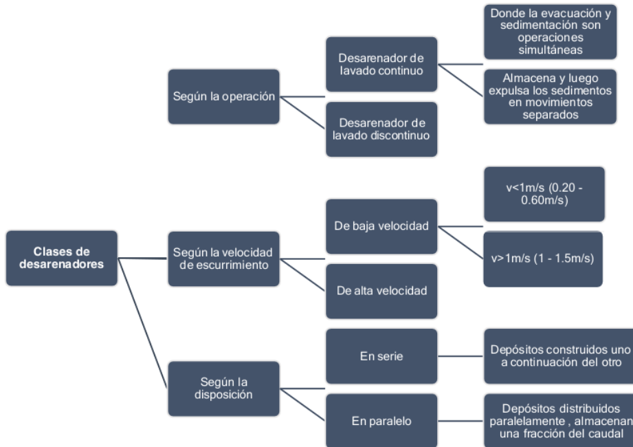
Figura 19. Clases de desarenadores Fuente: (Villón, 2005)
