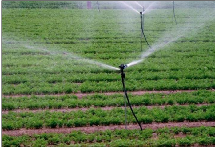
Figura 13. Sistema móvil semifijo de riego por aspersión Fuente: (Ministerio de Agricultura, Pesca y Alimentación, s.f.)
