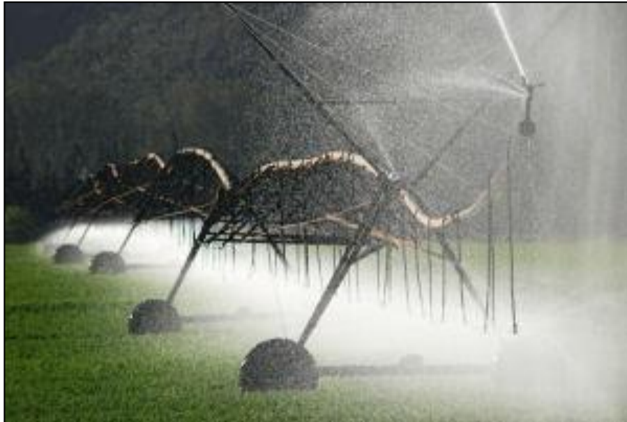
Figura 15. Sistema ramales desplazables de riego por aspersión Fuente: (Ministerio de Agricultura, Pesca y Alimentación, s.f.)
