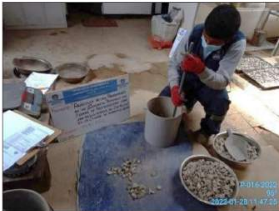
Figura N° 12: Ensayo de peso unitario suelto y compactado del agregado para el concreto permeable
