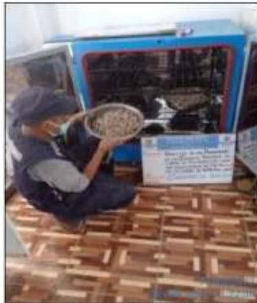
6 Figura N° 10: Ensayo de contenido de humedad de los agregados para la elaboración del concreto permeable
