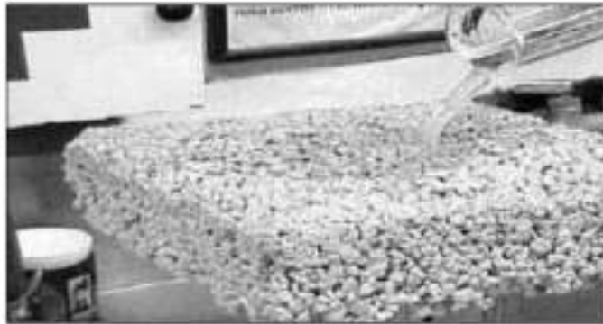
Figura N° 6: Concreto permeable permite la percolación de aguas de lluvias
