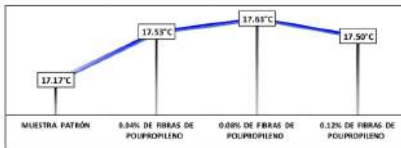
Gráfico N° 7: Comportamiento de la temperatura del concreto permeable al ser adicionado las fibras de polipropileno
