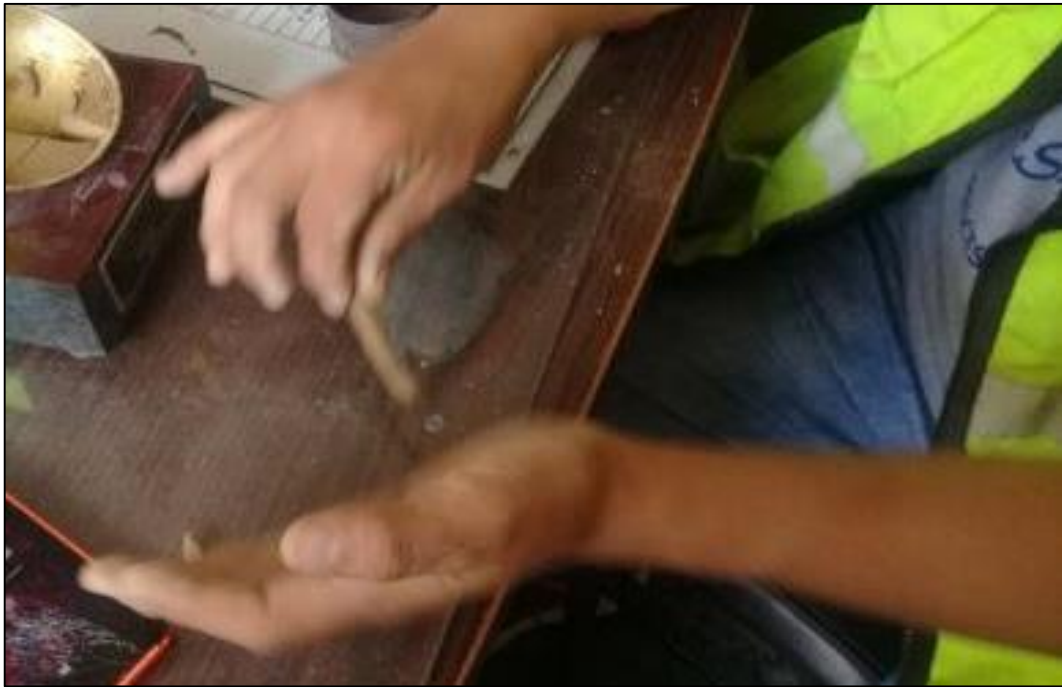
Figura N° 2: Ensayo de límite plástico.
