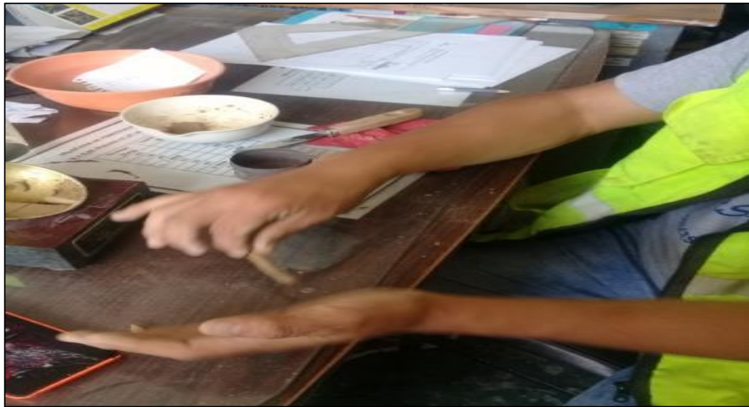
Figura N° 12: Amasado de la muestra para la plasticidad.
