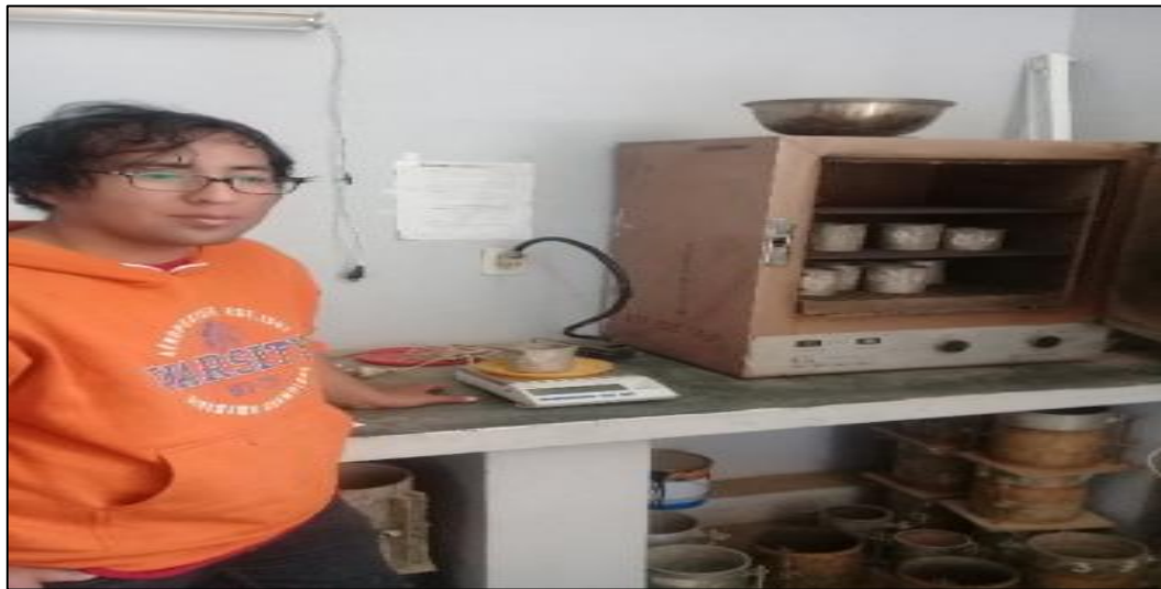
Figura N° 7: Se determinó el peso de una de las muestras para su posterior ingreso al horno.
