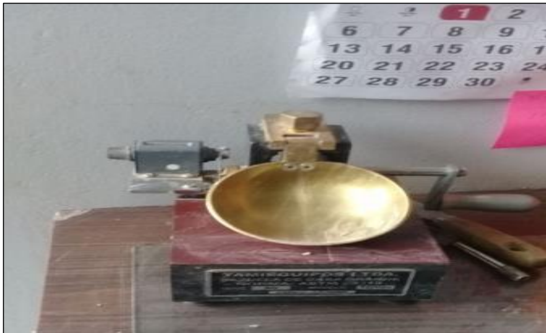
Figura N° 1: Ensayo de límite líquido
