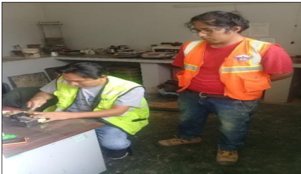
Figura N° 10: Preparación de la cuchara de Casagrande
