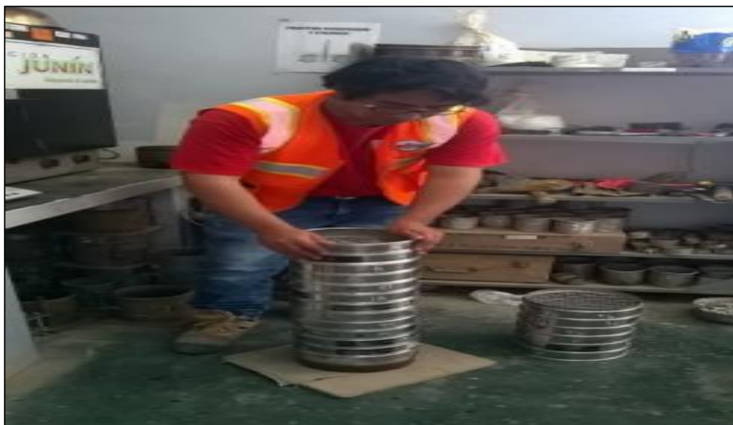
Figura N° 9: Tamizado de material
