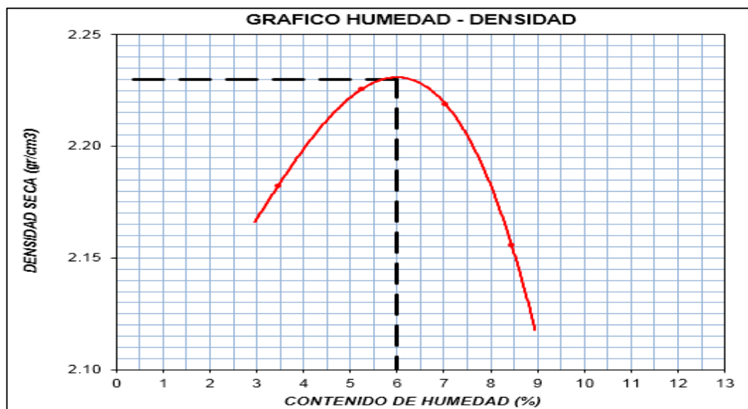
Gráfico N° 27. Curva de compactación: Método “A” - Cantera Estrella
