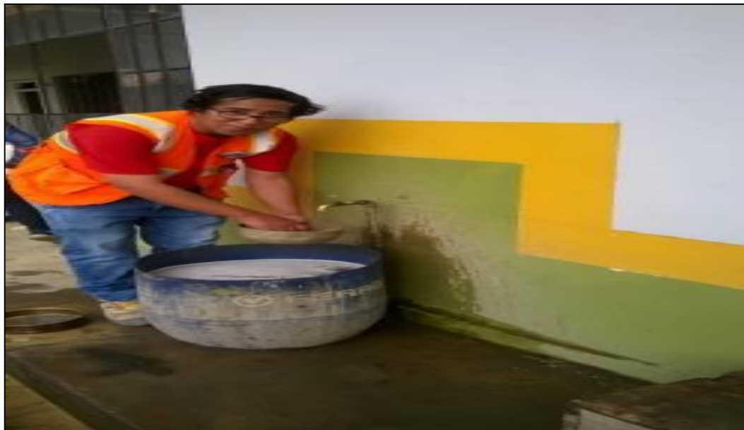
Figura N° 8: Lavado de muestra por el tamiz N° 200
