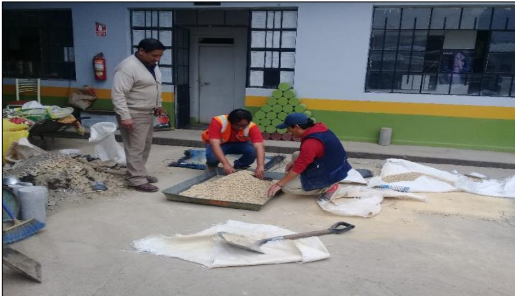
Figura N° 15: Cuarteo de una de las muestras de la cantera.
