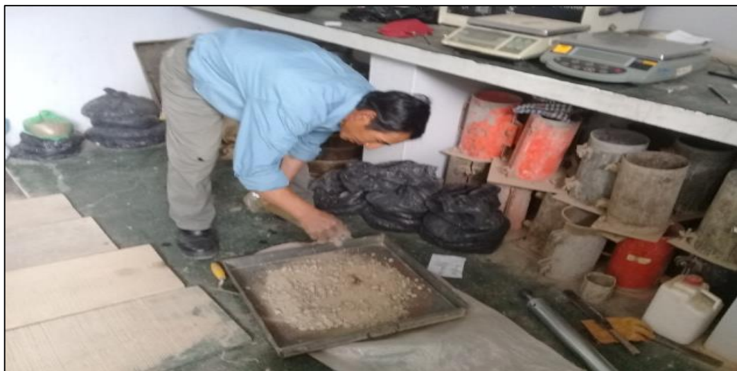
Figura N° 17: Preparación de los especímenes para el ensayo de Proctor modificado.
