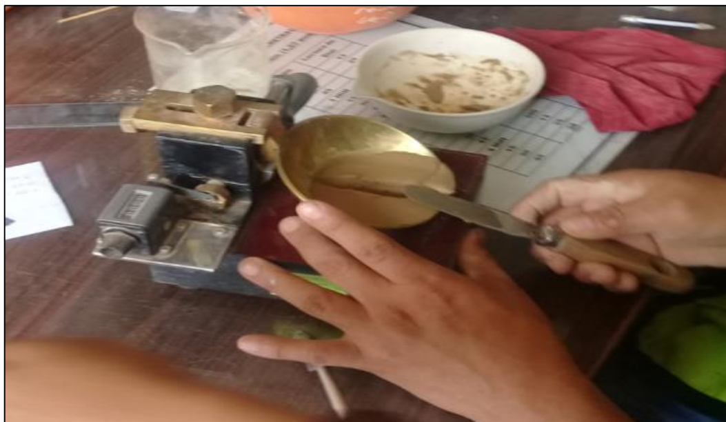
Figura N° 11: Después de dividir el la masa de suelo de la cazuela
