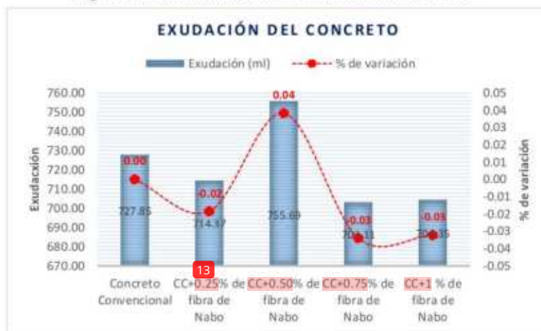
Figura 21. Resultados de exudación del concreto
