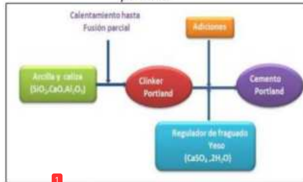
Figura 4. Procedimiento de la elaboración del cemento portland.
