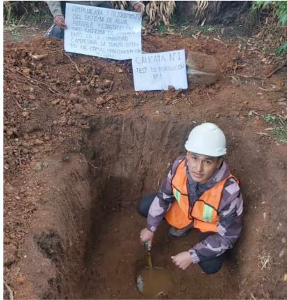
Imagen N° 01.- Realización del ensayo de test de percolación N°1, calcata N°1.
