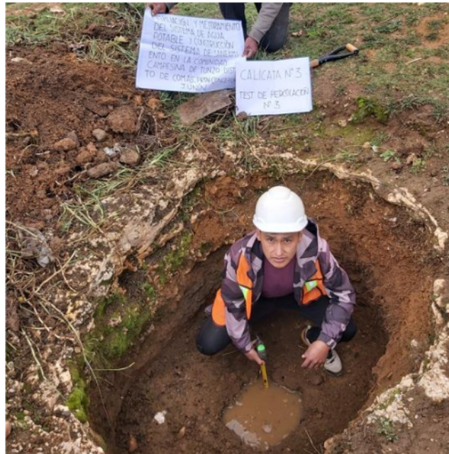
Imagen N° 03.- Realización del ensayo de test de percolación N°3, calicata N°3.
