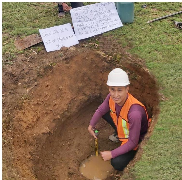
Imagen N° 04.- Procedimiento del ensayo de test de percolación N°4, calicata N°4.
