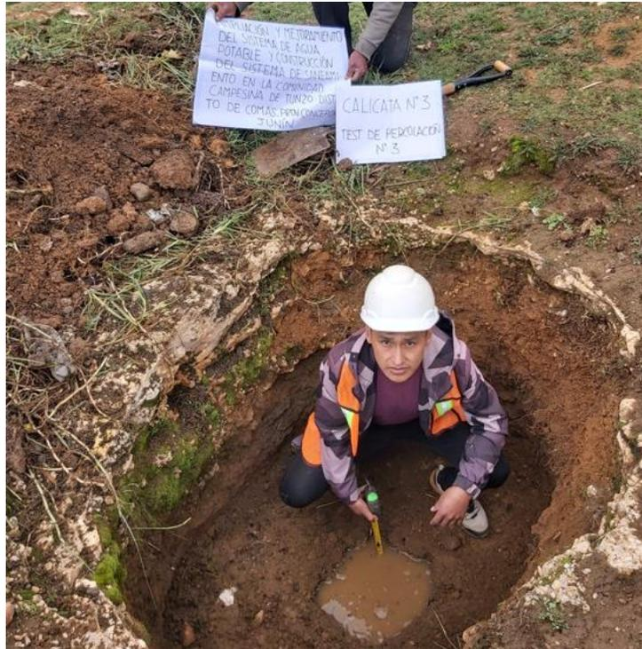
Imagen N° 03.- Procedimiento del ensayo de test de percolación N°3, calicata N°3.
