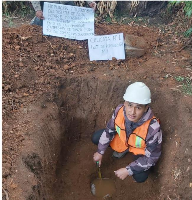
Imagen N° 01.- Procedimiento del ensayo de test de percolación N°1, calicata N°1.
