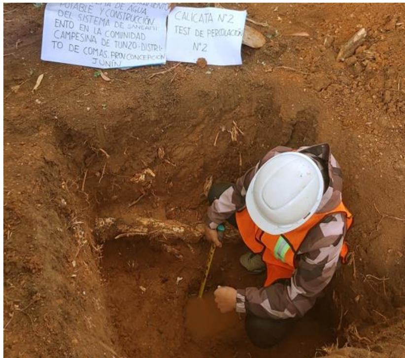
Imagen N° 02.- Procedimiento del ensayo de test de percolación N°2, calicata N°2.
