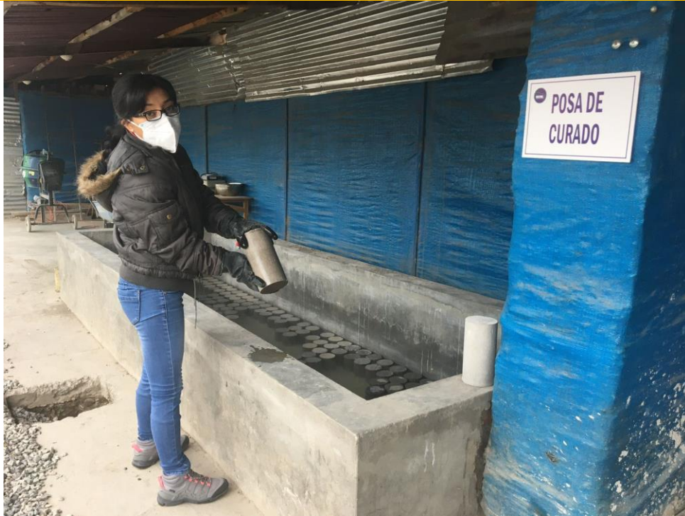
FOTOGRAFÍA N 33: PROBETAS RETIRADAS DEL POZO PARA ENSAYO
