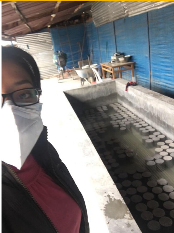
FOTOGRAFÍA N 30: PROBETAS EN EL POZO DE CURADO
