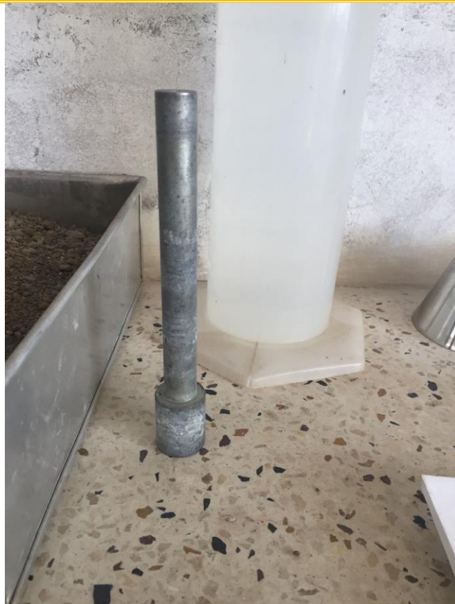
FOTOGRAFÍA N 18: VARILLA PARA EL CONO DE KANSAS
