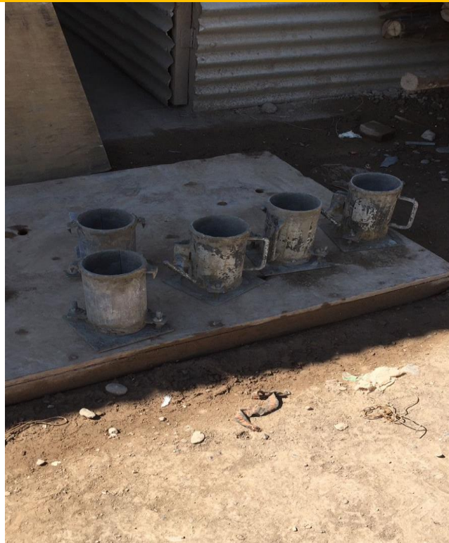
FOTOGRAFÍA N 26: PROBETAS A USAR DEBIDAMENTE EMBARRADAS CON COMPONENTE ANTIDESMOLDANTE
