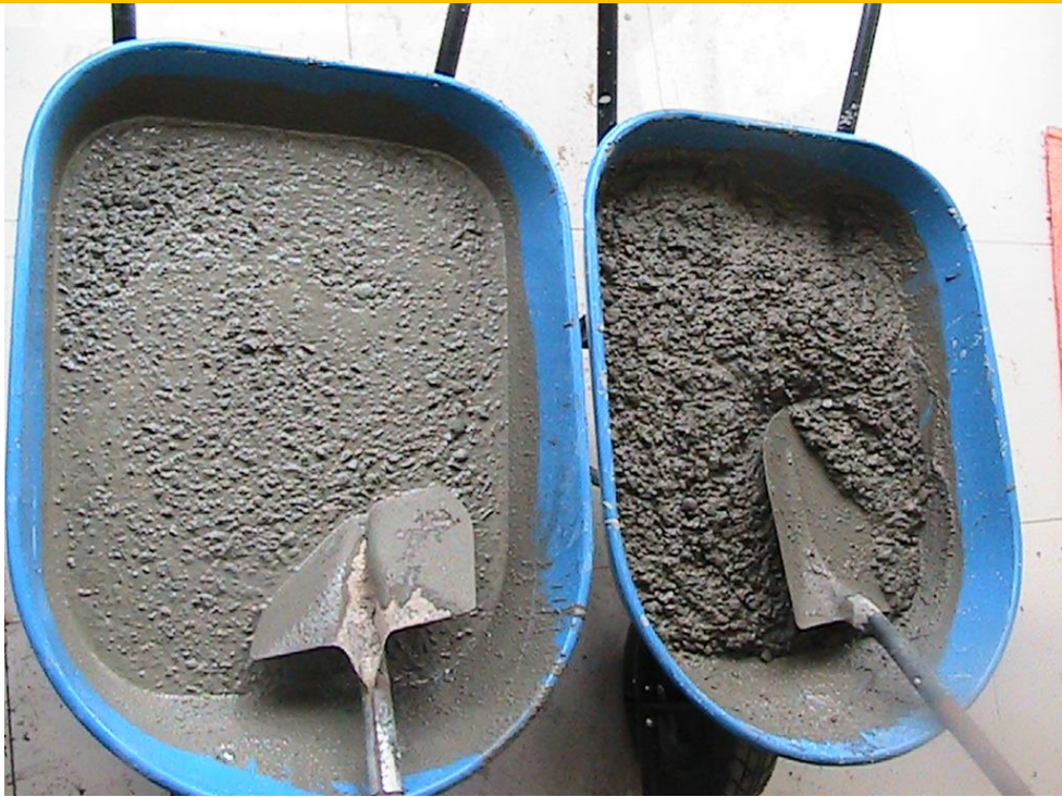
FOTOGRAFÍA N 21: PREPARADO PARA EL ENSAYO DE SLUMP
