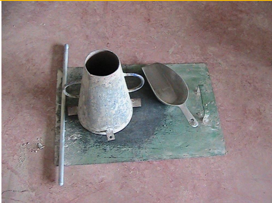
FOTOGRAFÍA N 17: CONO DE ABRAMS
