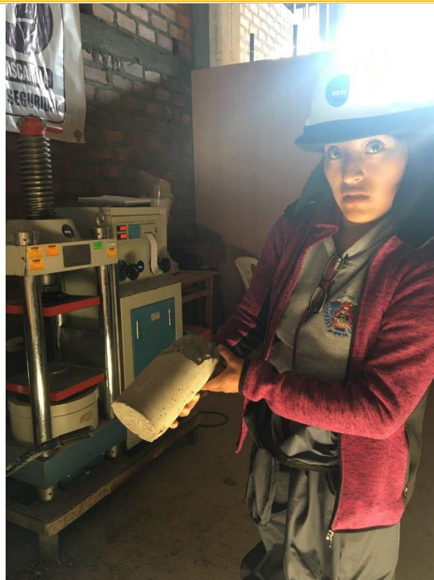
FOTOGRAFÍA N 34: PROBETAS LISTAS PARA EL ENSAYO DE COMPRESIÓN AXIAL
