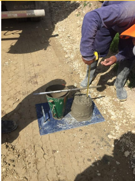
FOTOGRAFÍA N 28: ENSAYO DE ASENTAMIENTO
