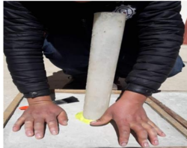
Inicio del ensayo de permeabilidad Muestra 01.
