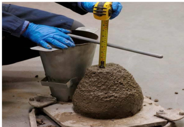
Figura 8 Ensayo de asentamiento con el cono de abrams Fuente: Elaboración propia.
