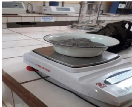
Pesado de cemento
