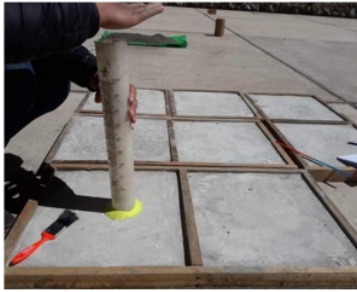
Colocación para el ensayo de permeabilidad Muestra 02.
