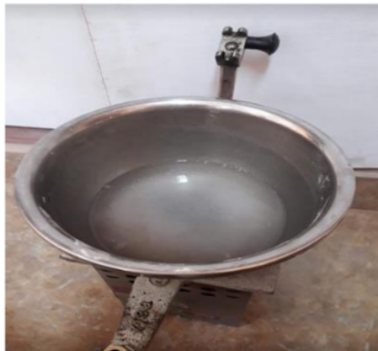
Aplicación del impermeabilizante jabonado de alumbre en la Muestra 02
