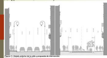
Figura 11. Estado anterior de la calle y propuesta de intervención Fuente: Autoridad del Espacio Público
