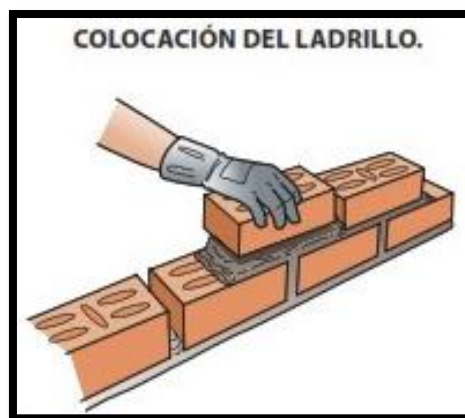
Figura N°74 Detalle Asentado de ladrillo
