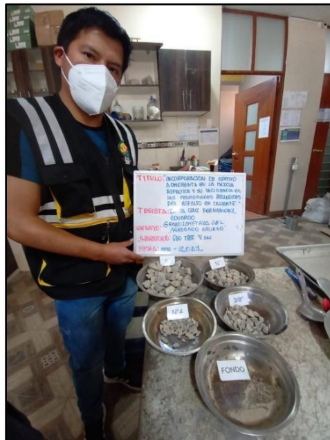
Fotografía N° 2: Ensayo de granulometría del agregado grueso (piedra chancada de \frac{3}{8} " ), para la mezcla asfáltica en caliente (MAC) EN LA EG-2013, según MTC E-204, ASTM D-422.
