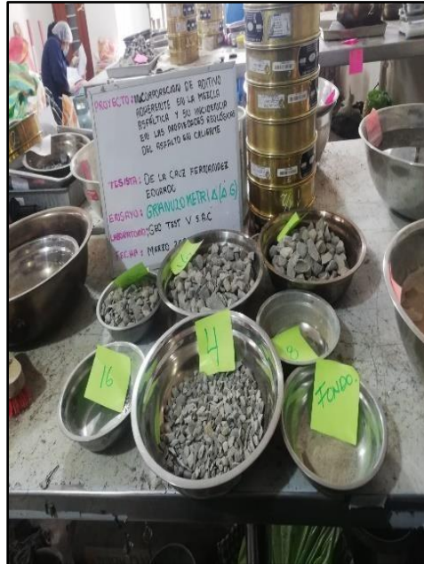
Fotografía N° 1: Ensayo de granulometría del agregado grueso (piedra chancada de \frac{3}{4} " ), para la mezcla asfáltica en caliente (MAC) EN LA EG-2013, según MTC E-204, ASTM D-422.
