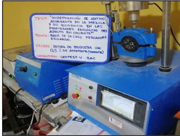
Fotografía N° 19: Ensayo Marshall incrementando aditivo mejorador de adherencia con el óptimo de (5.9). según la MTC E-504, NTP 339.132
