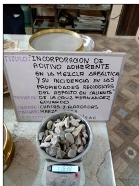
Fotografía N° 14: Ensayo de Partículas Chatas y Alargadas: ASTM 4791, NTP 400.4
