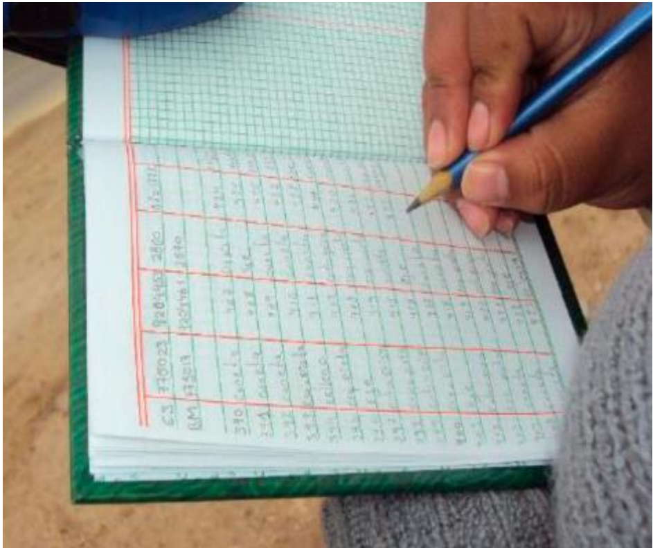
Figura 16- Anotaciones de lectura de la estación total
