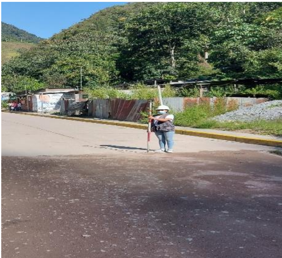
Figura 14- Vista del personal sujetando el prisma en el km-10+500
