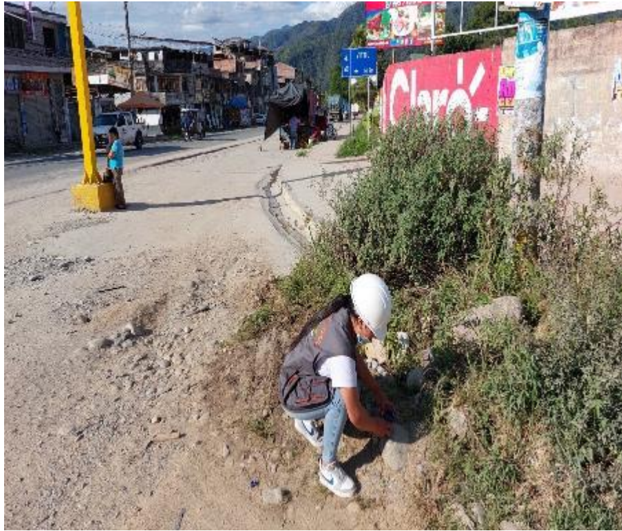
Figura 3 – toma de coordenadas con GPS en BM-01
