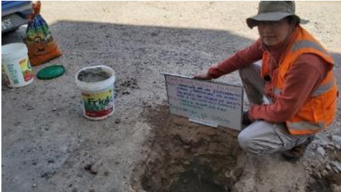
Fotografía 3. Estado final de la calicata de la cual se ha obtenido las muestras de suelo.
