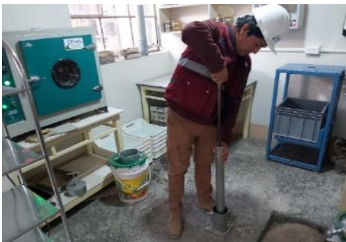
Fotografía 12. Realización de la compactación para la determinación del ensayo de Proctor modificado.
