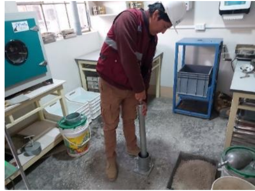
Fotografía 13. Compactación de la muestra óptima para el desarrollo del ensayo de CBR.
