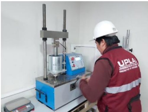
Fotografía 15. Determinación del ensayo de CBR con 0.1'' y 0.2'' de penetración.
