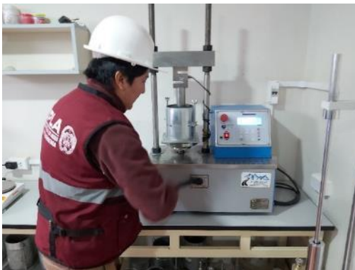
Fotografía 14. Colocación de la muestra en la máquina de CBR.
