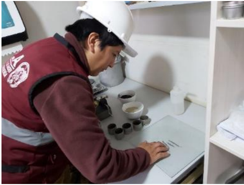
Fotografía 9. Determinación de Límite plástico del suelo con la adición de ceniza de carbón.
