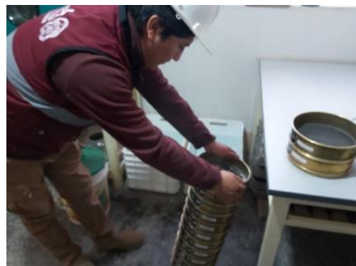
Fotografía 6. Realización del ensayo de granulometría de manera manual.
