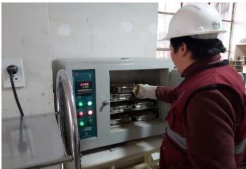
Fotografía 11. Colocación de muestras de suelos en el horno para la determinación del LL, LP e IP.
