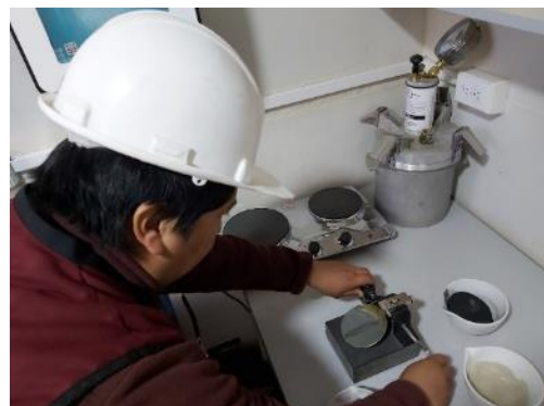
Fotografía 8. Vista del ensayo de límite líquido del suelo con adición de ceniza de carbón.
