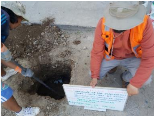
Fotografía 2. Verificación de la profundidad de la calicata en la zona de estudio.
