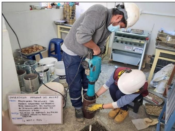
Fotografía 24. Vista del compactado de la mezcla de agregados y cemento por medio de un martillo de compactación.
