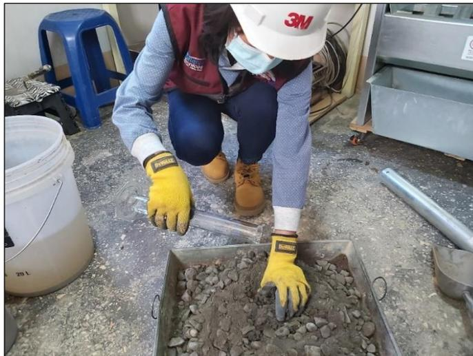
Fotografía 23. Vista del mezclado del agregado con cemento para la compactación del mismo, según la NTP 339.141.
