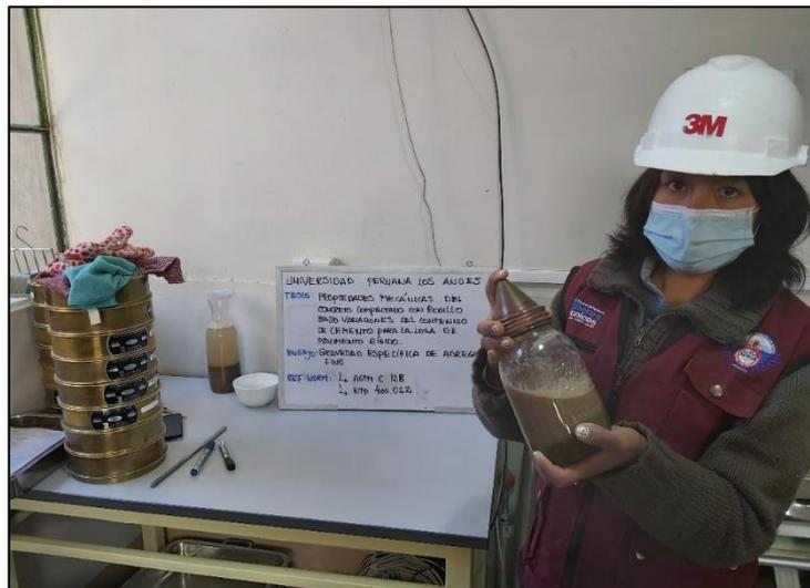
Fotografía 17. Vista de la eliminación de las burbujas de aire en el picnómetro.
