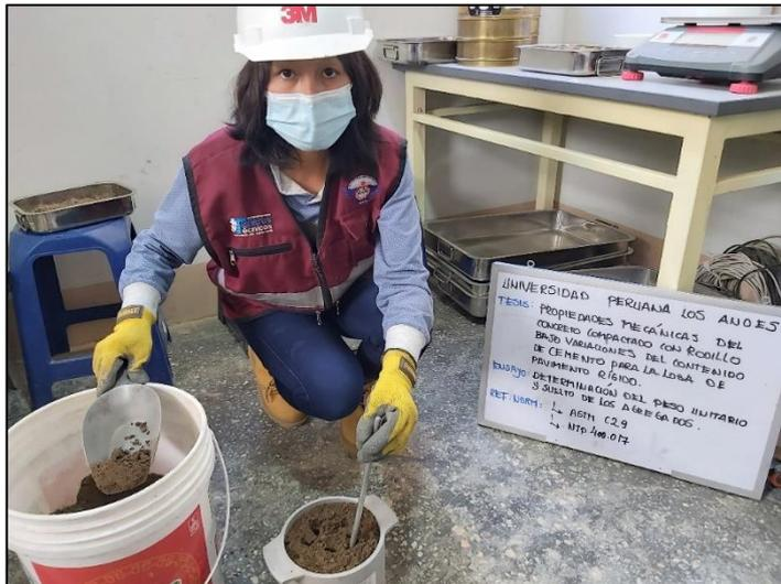
Fotografía 11. Vista de la determinación de los pesos unitarios suelto y compactado del agregado fino, de acuerdo a la NTP 400.017.
