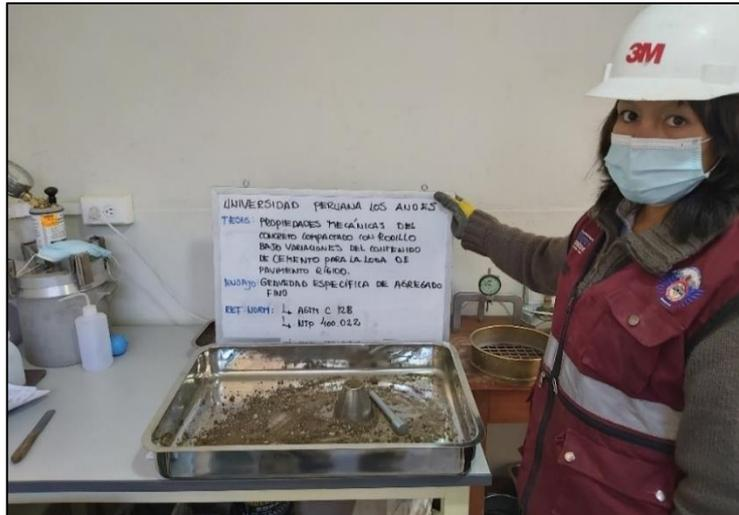
Fotografía 16. Vista de la determinación de la condición de saturado superficialmente del agregado fino.
