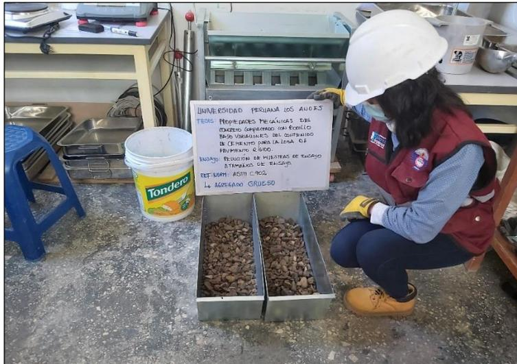
Fotografía 4. Cuarteo en laboratorio del agregado grueso, según la NTP 400.043.
