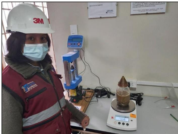
Fotografía 18. Vista del registro del peso del picnómetro.
