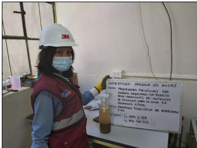
Fotografía 15. Vista de la inmersión del agregado fino por 24 horas para la obtención de la gravedad específica del mismo, de acuerdo a la NTP 400.022.
