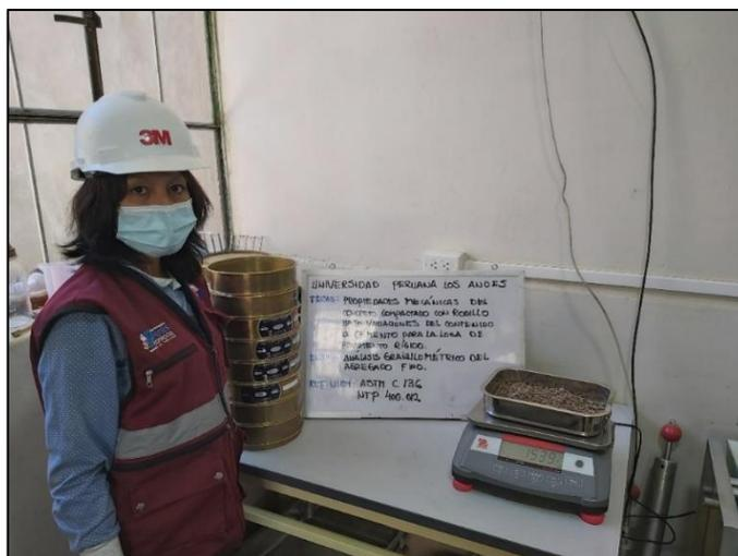
Fotografía 9. Análisis granulométrico del agregado fino de acuerdo a la NTP 400.012.
