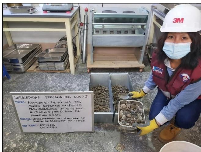
Fotografía 6. Vista de la extracción del agregado grueso para la determinación del contenido de humedad.
