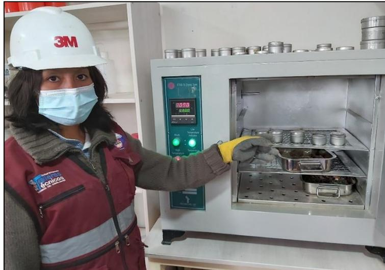
Fotografía 22. Vista de la puesta en el horno de los agregados.
