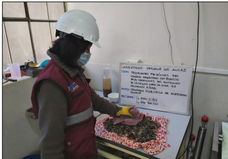
Fotografía 20. Vista del secado superficialmente de los agregados grueso para alcanzar la condición de saturado superficialmente.
