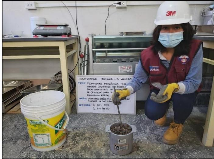
Fotografía 13. Vista de la determinación de los pesos unitarios suelto y compactado del agregado grueso, de acuerdo a la NTP 400.017.
