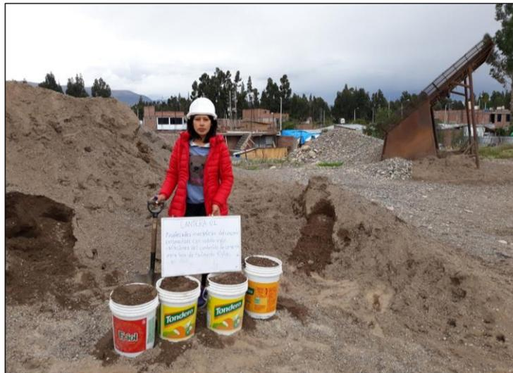
Fotografía 2. Muestreo en cantera del agregado fino.
