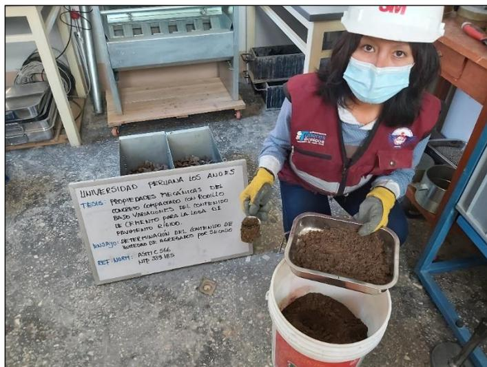
Fotografía 5. Vista de la extracción del agregado fino para la determinación del contenido de humedad.
