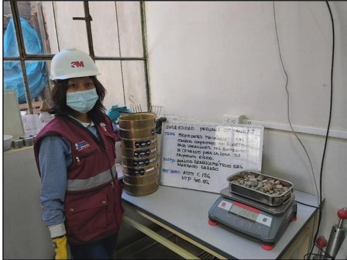
Fotografía 10. Análisis granulométrico del agregado grueso de acuerdo a la NTP 400.012.
