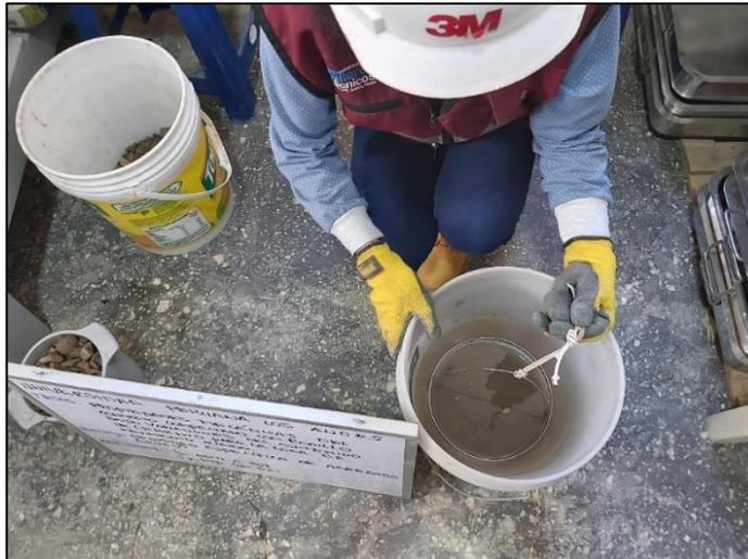
Fotografía 19. Vista de la inmersión por 24 horas del agregado grueso para la determinación de la gravedad específica del mismo, de acuerdo a la NTP 400.021.
