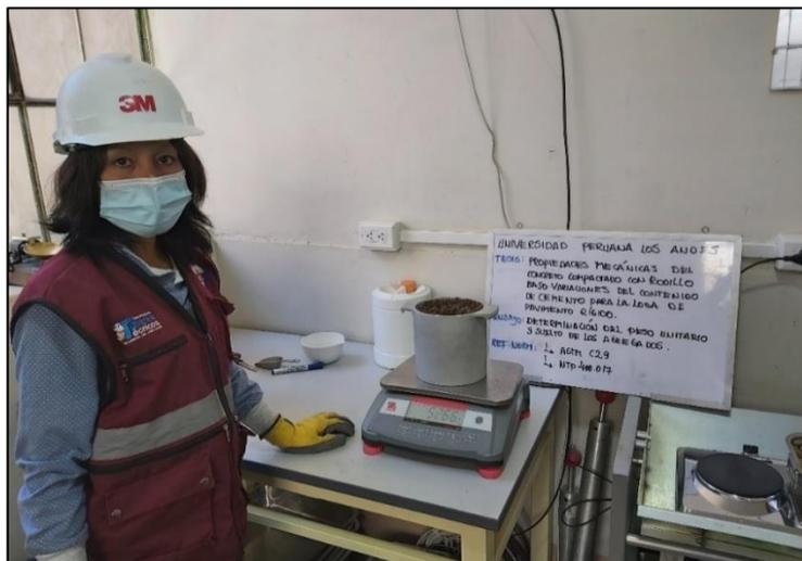
Fotografía 12. Vista del registro del peso del agregado fino.
