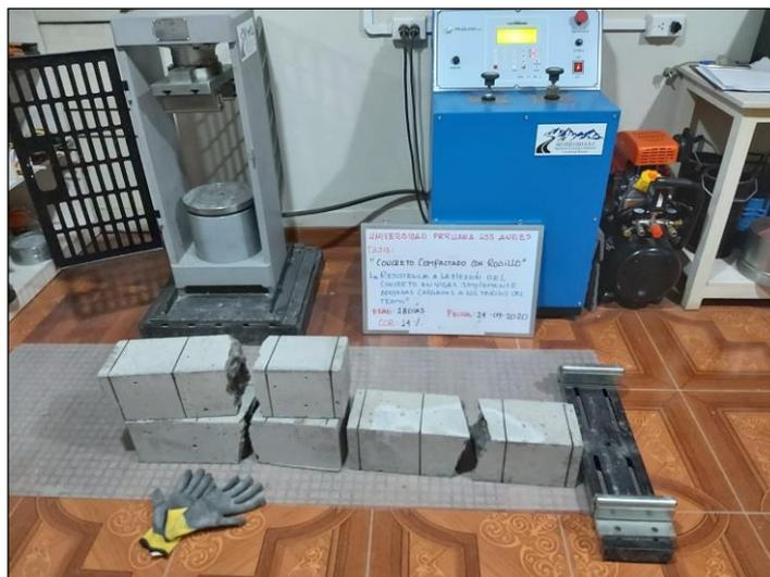
Fotografía 29. Vista de las vigas roturadas.
