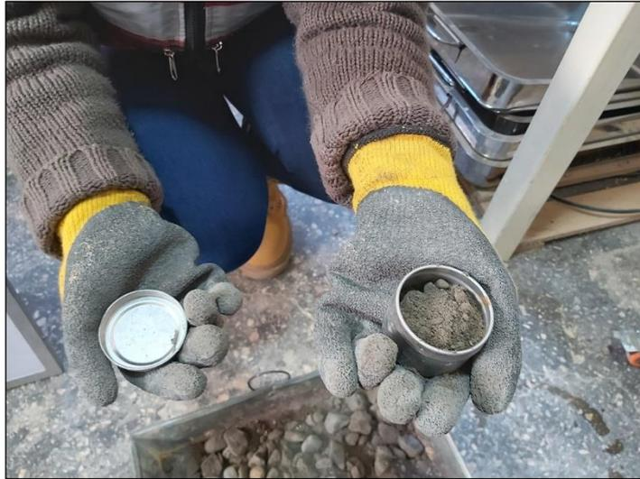
Fotografía 25. Vista de la determinación del contenido de humedad de cada una de las muestras.
