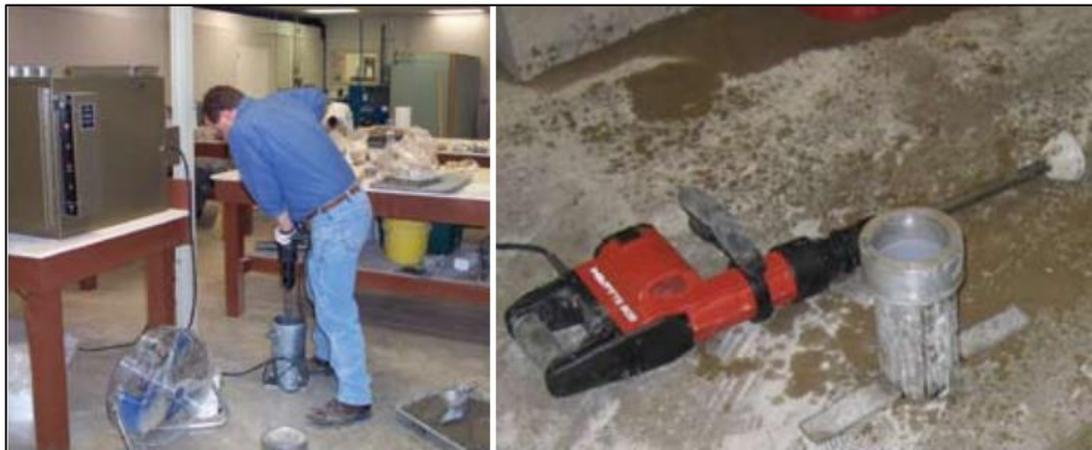
Figura 4. Elaboración de cilindros de concreto compactado con rodillo.
