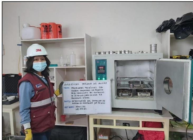
Fotografía 8. Muestras de agregados al horno para determinar el contenido de humedad.
