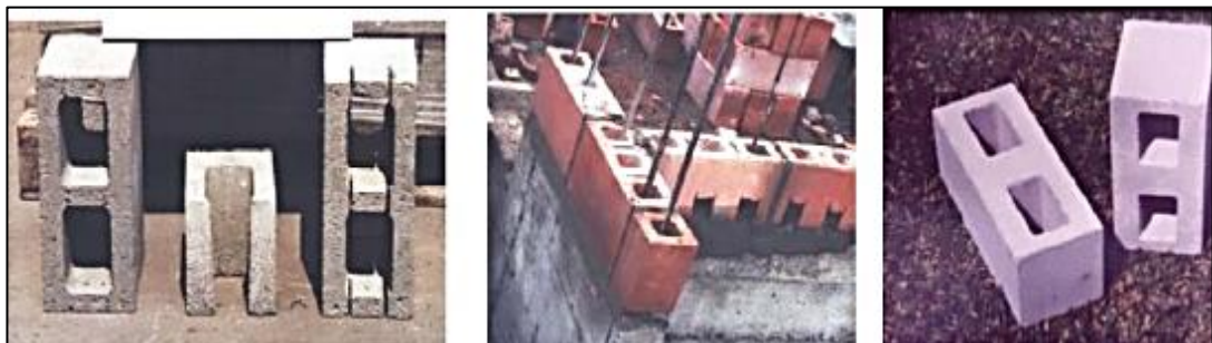
Figura N° 6. Elementos de albañilería alveolar, se muestran celdas que tienen la capacidad de alojar un refuerzo vertical como se observa en la figura por lo que en su mayoría son usados en la construcción de muros armados.
