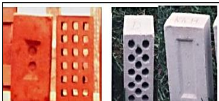
Figura N° 7. Unidades de albañilería maciza y sólida, se observa en la figura excesivos huecos que son muy frágiles y poco resistentes al esfuerzo de corte generado por los sismos, además de que se trituran fácilmente después de que se generan las grietas diagonales en los muros durante el sismo.
