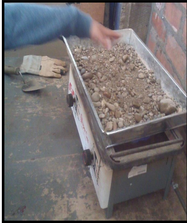
Secando la muestra para así poder tamizar correctamente
