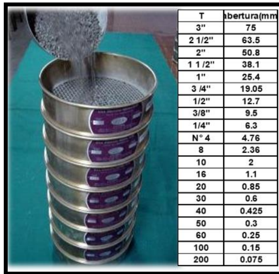
Figura 21: Juego de tamices para el ensayo granulométrico.
