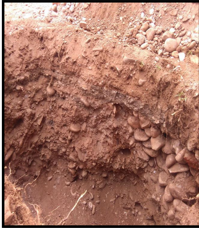
Vista general del tipo característico de tipo de suelo granular del distrito de El Tambo-Umuto
