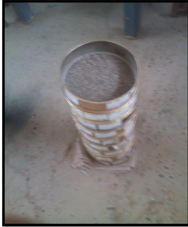
Juego de tamices para el respectivo ensayo granulometrico.
