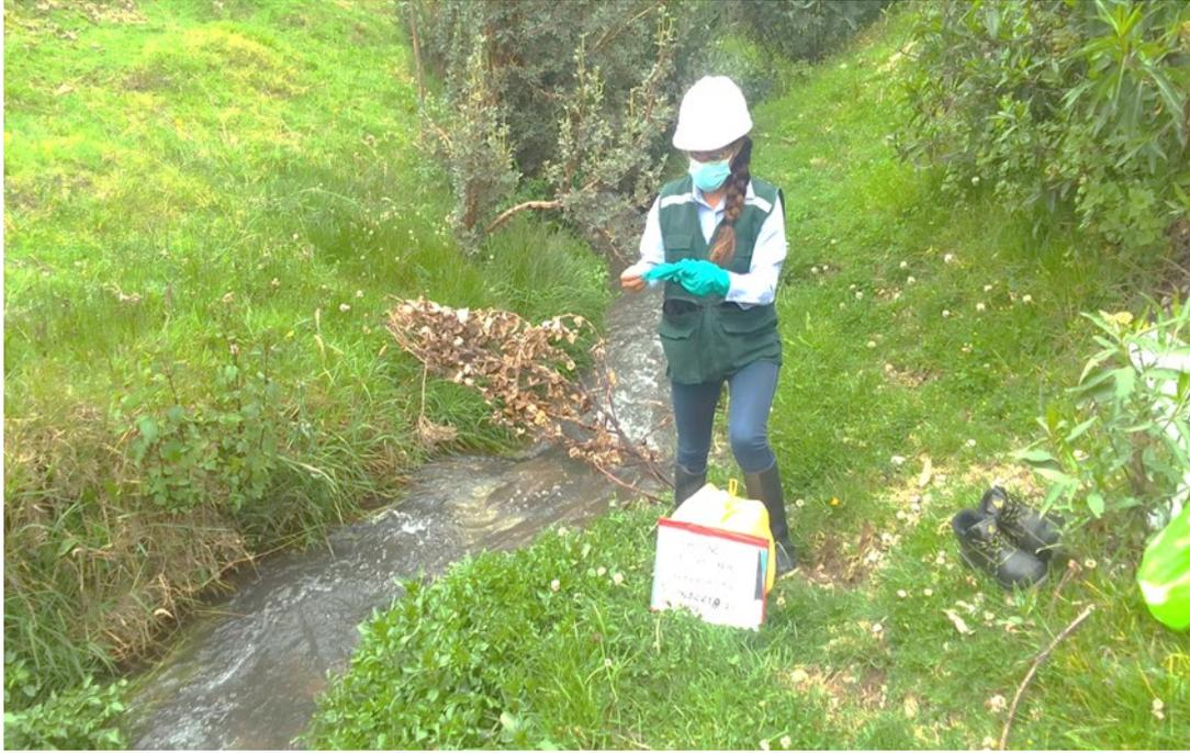
*Fotografía N° 3.* Se toma muestra del agua residual para muestra de PH y solidos totales según lo establece la normativa D.S N° 003-2010-MINAM
