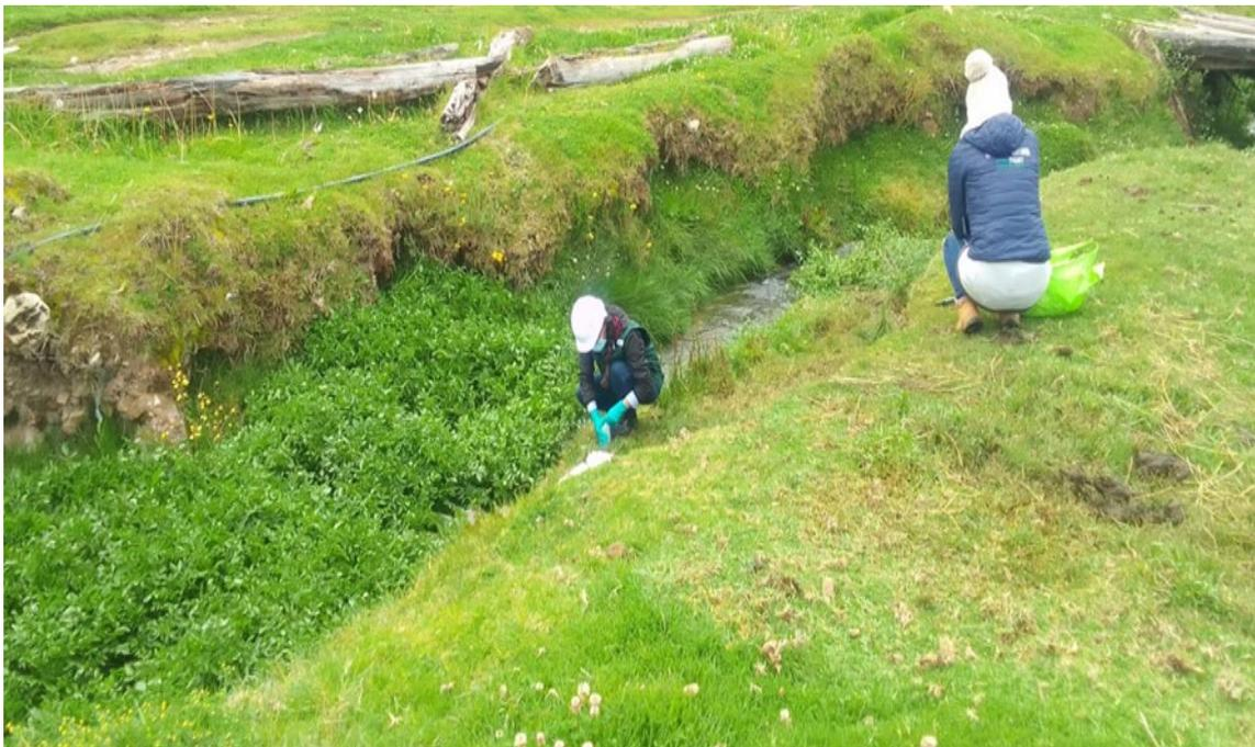
Fotografía N° 2. *Se toma muestra para coliformes fecales* según lo estable la normativa D.S N° 003-2010-MINAM
