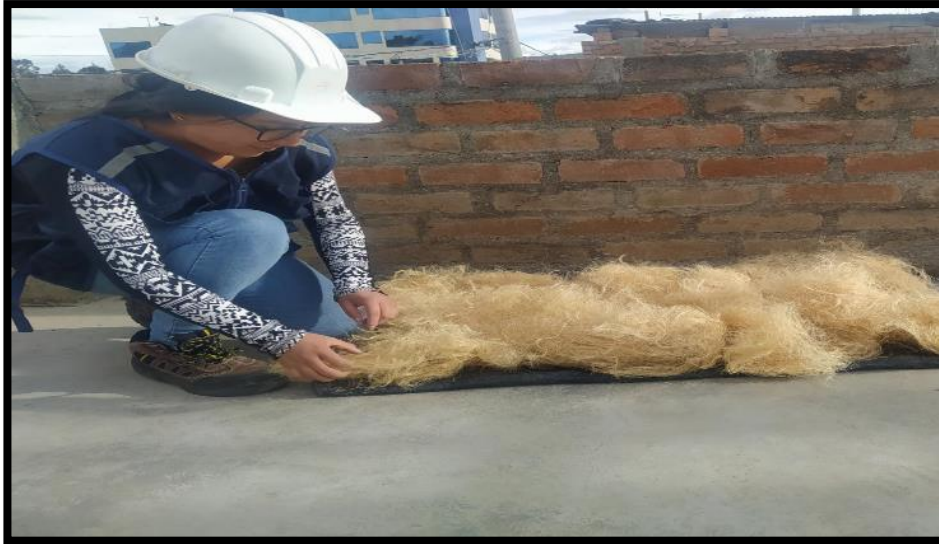
Figura 4:Proceso de obtención de Fibras de Agave
