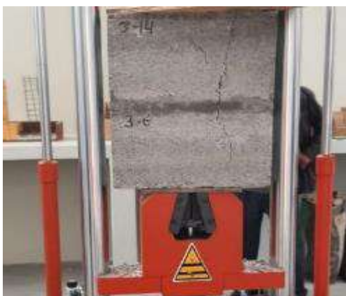
Figura 17: Tipo de falla cónico y corte en pilas.
