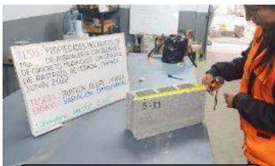
Figura 9: Ensayo de dimensionamiento en bloques de concreto.
