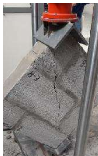
Figura 18: Tipo de falla de tensión diagonal en bloques.
