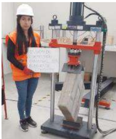
Figura 15: Ensayo de compresión diagonal en muretes de 60cmx60cm.
