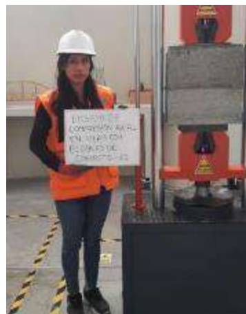
Figura 14: Ensayo de compresión axial en pilas de 2 hileras.
