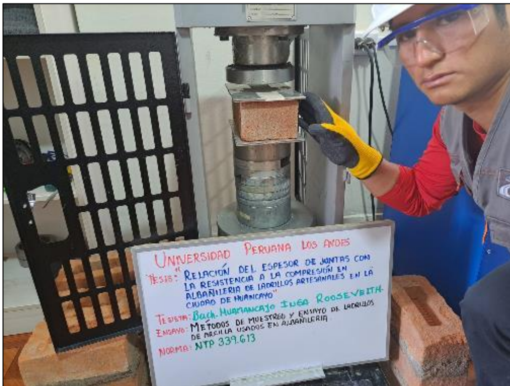
Fotografía 8. Medición de la resistencia a compresión de los ladrillos.
