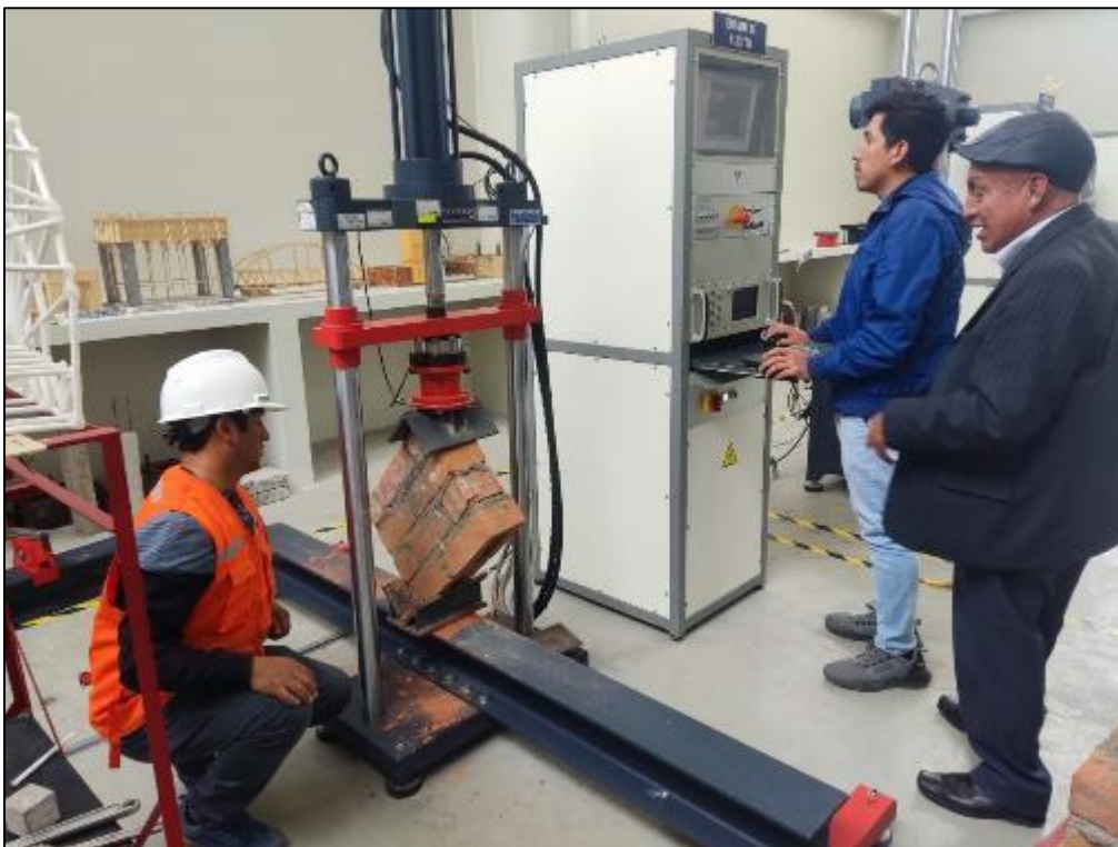
Fotografía 16. Vista de la rotura de muretes de albañilería.
