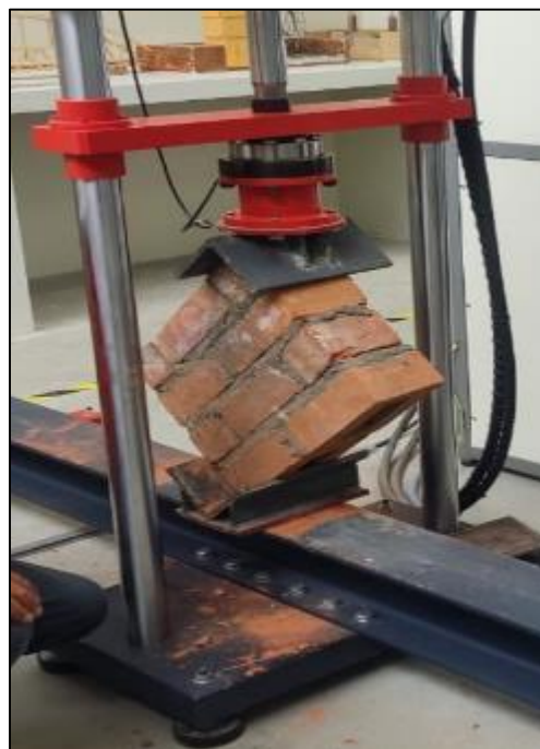
Figura 7. Ensayo de resistencia a la compresión diagonal de murete de albañilería.
