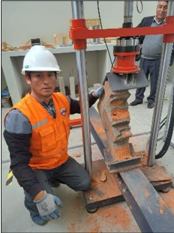
Fotografía 17. Vista de murete roturado.
