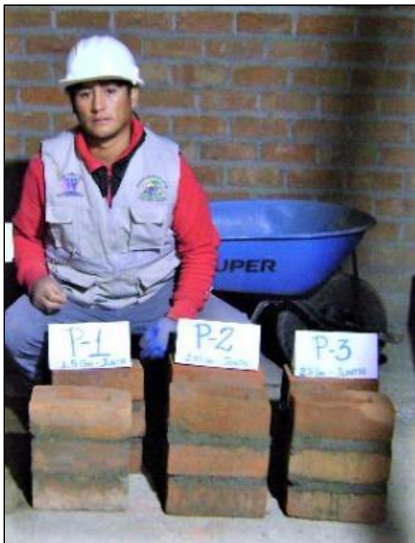
Fotografía 14. Vista de pilas de albañilería con diferentes espesores de juntas.
