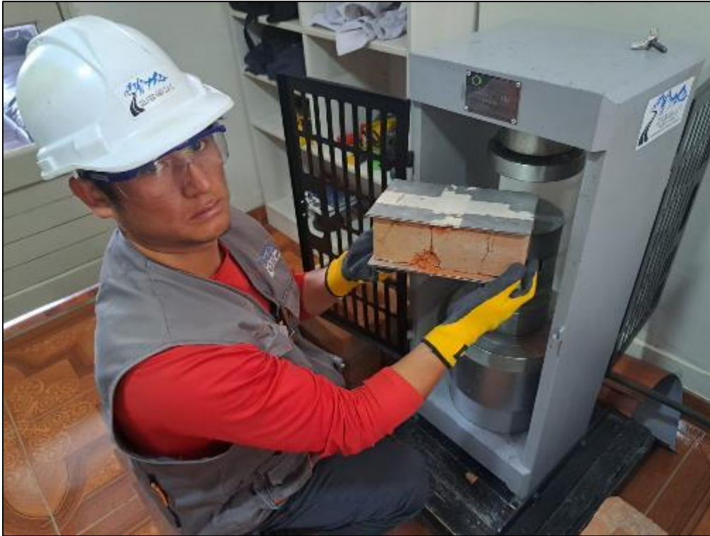
Fotografía 9. Vista del ladrillo roturado.
