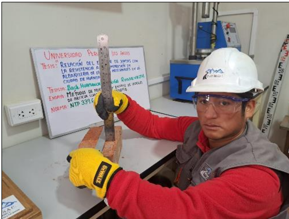
Fotografía 6. Medición del alabeo en los ladrillos.
