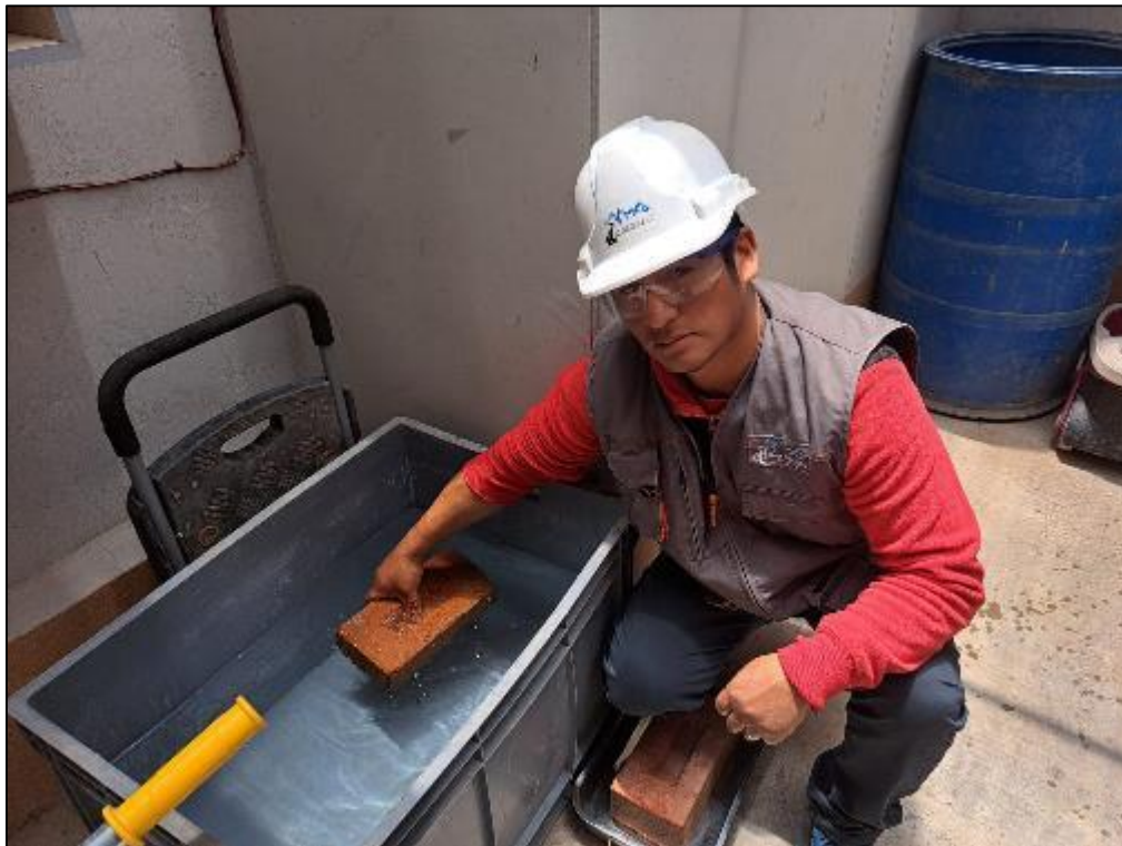
Fotografía 2. Vista del proceso de sumergido de los ladrillos para la medición de la absorción.
