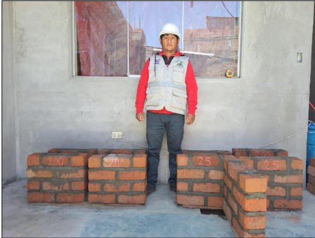
Fotografía 11. Vista de los muretes de albañilería con diferentes espesores de juntas.
