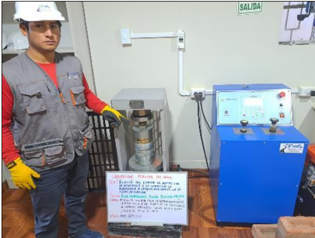
Fotografía 7. Medición de la resistencia a compresión del mortero empleado en la investigación.
