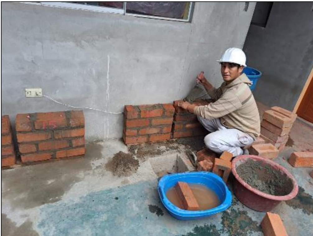
Fotografía 10. Elaboración de muretes de albañilería a ensayar.
