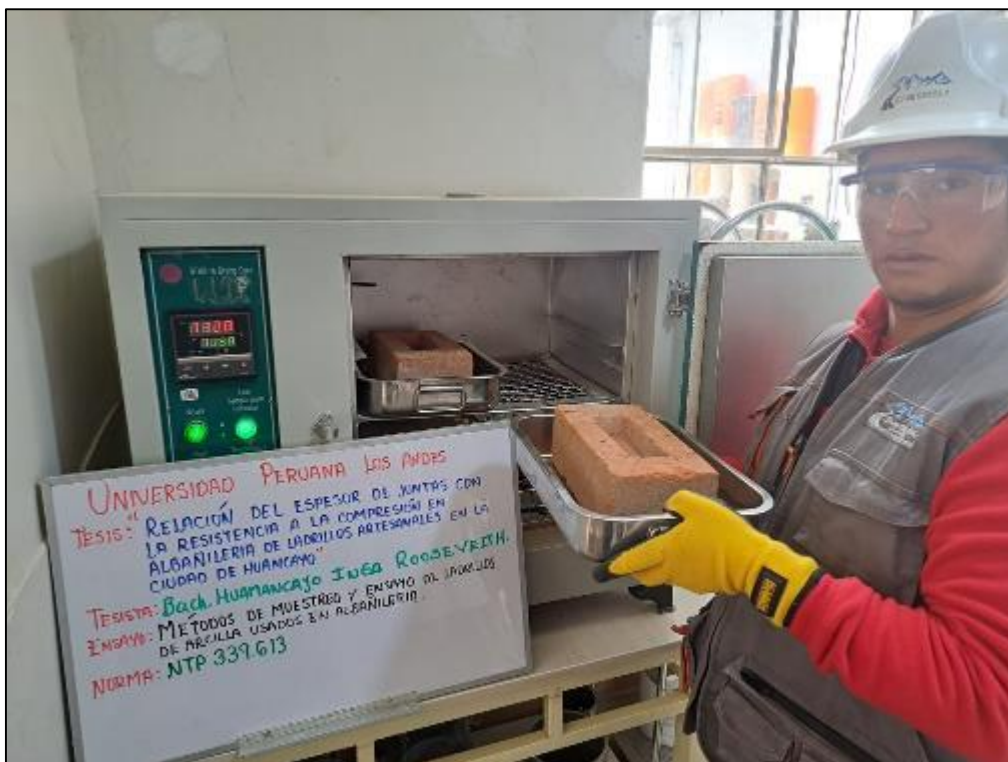
Fotografía 4. Secado en horno de los ladrillos.
