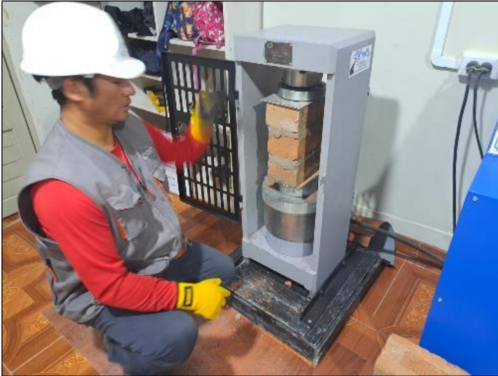
Fotografía 15. Rotura de pilas de albañilería.
