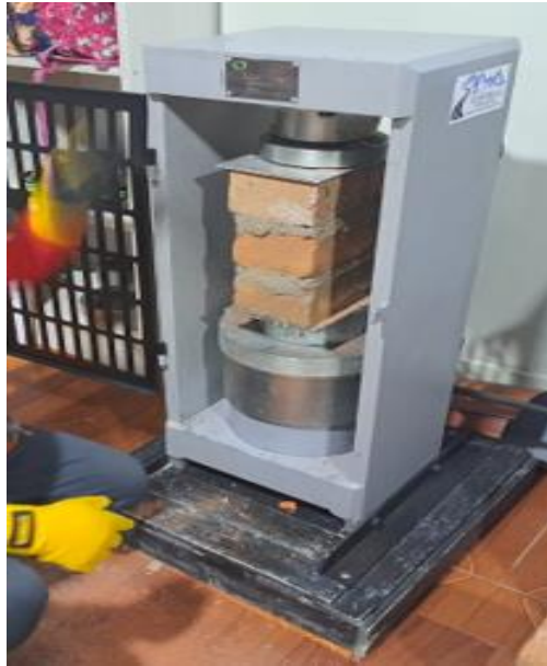
Figura 5. Ensayo de resistencia a la compresión axial de pila de albañilería.
