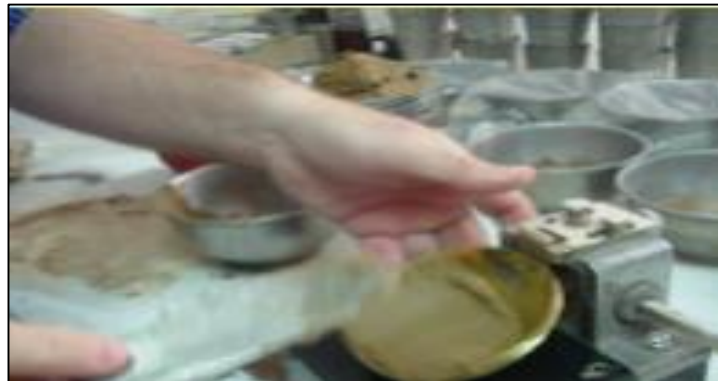
Figura 22: Muestra humedecida en la copa de casa grande y división de la muestra con acanalador.
