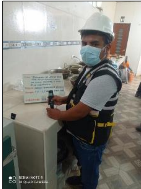
Fotografía N° 12: Ensayo de análisis de PH del suelo con adición 5% Base Seal. Según la NTP 339.176.
