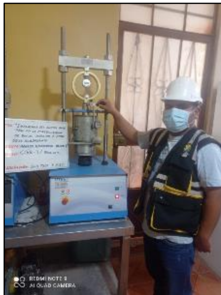
Fotografía N° 37: Ensayo para la determinación de un índice de resistencia del suelo, Lectura de penetración en el dial, 0.025 plg a 0.500 plg con adición de 7% de Base Seal. Según la norma 339.175:2002.
