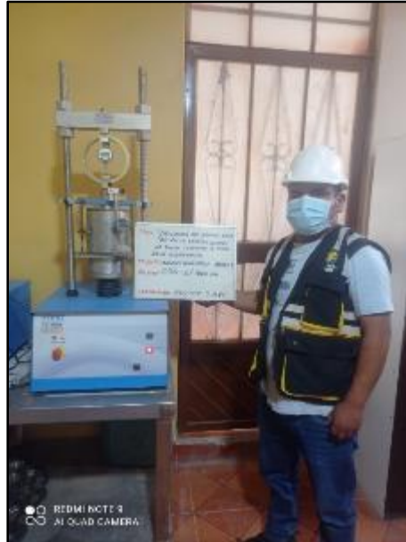
Fotografía N° 36: Ensayo para la determinación de un índice de resistencia del suelo, Lectura de penetración en el dial, 0.025 plg a 0.500 plg con adición de 5% de Base Seal. Según la norma 339.175:2002.
