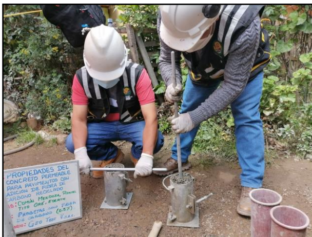
Fotografía N° 30: Elaboración de testigos cilíndricos para sus respectivos tipos de ensayos. Según la NTP 339.034 / ASTM C39
