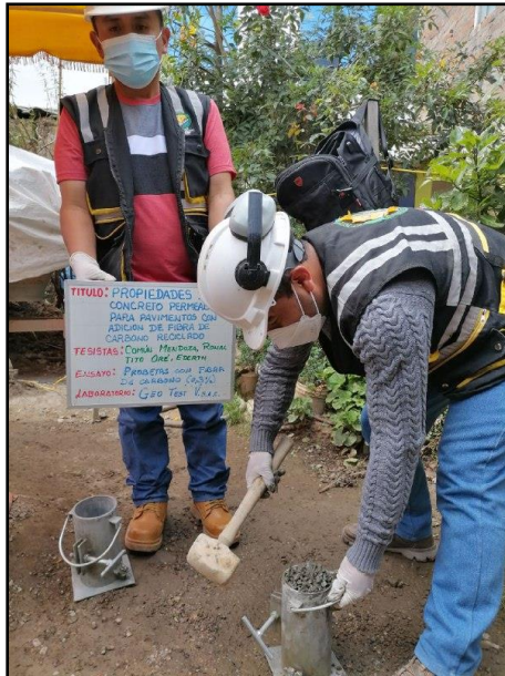
Fotografía N° 23: Elaboración de testigos cilíndricos para sus respectivos tipos de ensayos. Según la NTP 339.034 / ASTM C39
