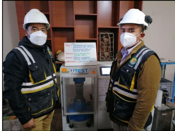
Fotografía N° 50: Introducción de probetas al equipo de compresión. Según la NTP 339.034 / ASTM C39.
