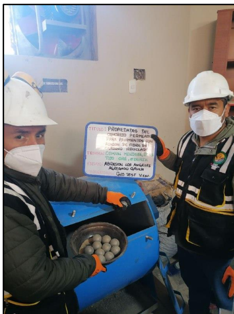
Fotografía N° 6: Colocación de esferas metálicas para la determinar el Método de ensayo normalizado para sacar el desgaste del agregado según la NTP 400 019
