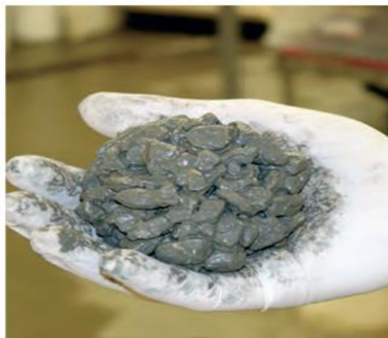
Figura 8: Aspecto del concreto poroso en estado fresco
