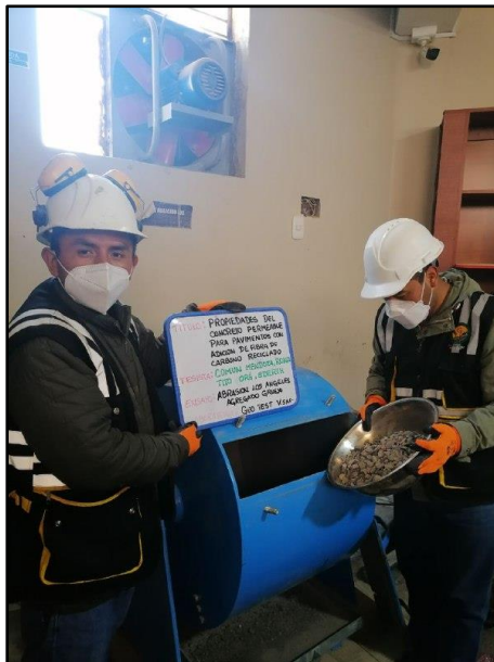
Fotografía N° 5: Realización del ensayo para determinar el Método de ensayo normalizado para sacar el desgaste del agregado según la NTP 400 019.
