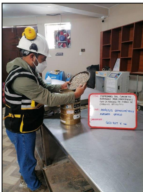
Fotografía N° 2: Ensayo de granulometría del agregado grueso, Tamaño Máximo Nominal (TMN) \frac{1}{2} "', aplico 6 de acuerdo a la NTP 400.012.
