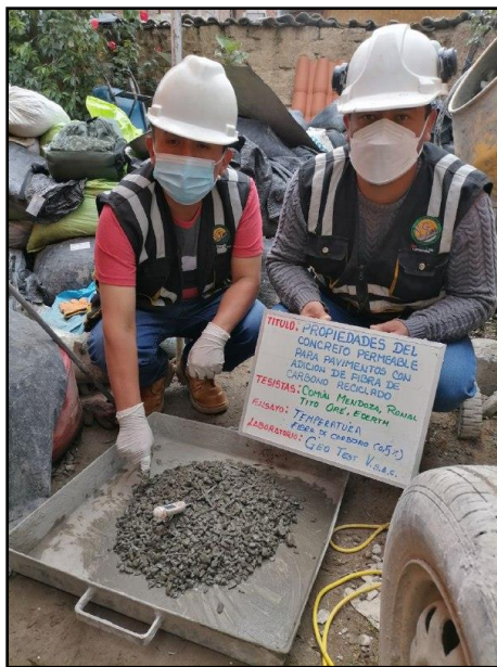
Fotografía N° 26: Medición de la temperatura del concreto permeable. Según NTP 339.184.
