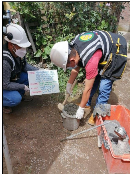
Fotografía N° 28: Control del contenido de aire del concreto fresco permeable por el método de presión. Según NTP 339.083.
