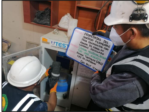
Fotografía N° 60: Introducción de probetas al equipo de compresión. Según la NTP 339.034 / ASTM C39.
