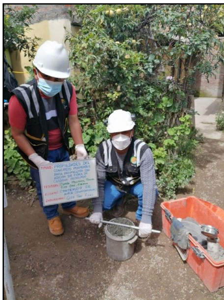
Fotografía N° 14: Control del contenido de aire del concreto fresco convencional por el método de presión. Según NTP 339.083
