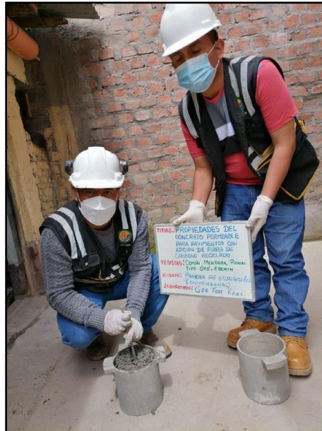
Fotografía N° 15: Control de la exudación del concreto convencional. Según NTP 339.077.
