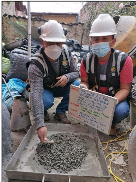
Fotografía N° 19: Medición de la temperatura del concreto permeable. Según NTP 339.184.
