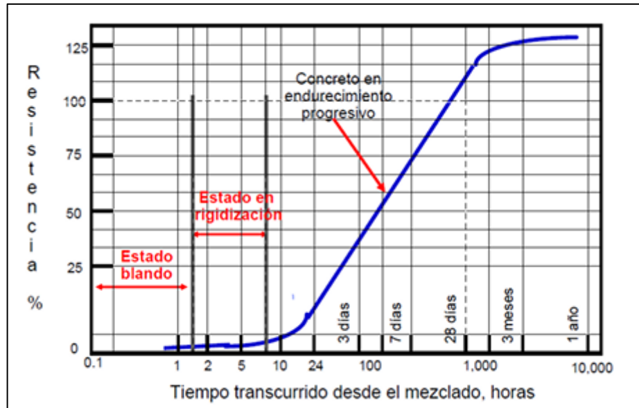
Figura 10: Proceso de endurecimiento del concreto permeable
