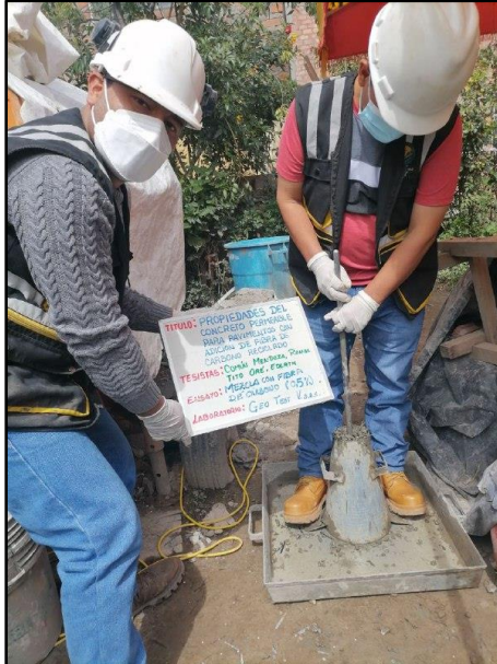
Fotografía N° 27: Medición del asentamiento del concreto fresco permeable. Según NTP 339.035.
