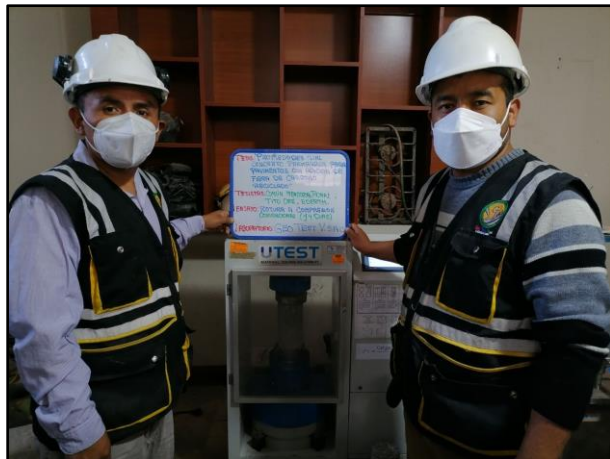
Fotografía N° 40: Introducción de probetas al equipo de compresión. Según la NTP 339.034 / ASTM C39.
