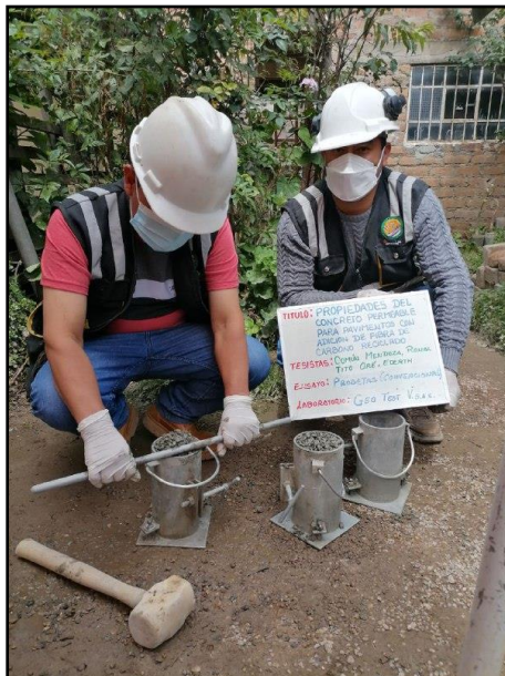
Fotografía N° 16: Elaboración de testigos cilíndricos para sus respectivos tipos de ensayos. Según la NTP 339.034 / ASTM C39.
