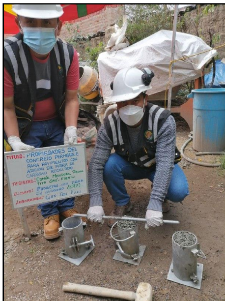
Fotografía N° 37: Elaboración de testigos cilíndricos para sus respectivos tipos de ensayos. Según la NTP 339.034 / ASTM C39
