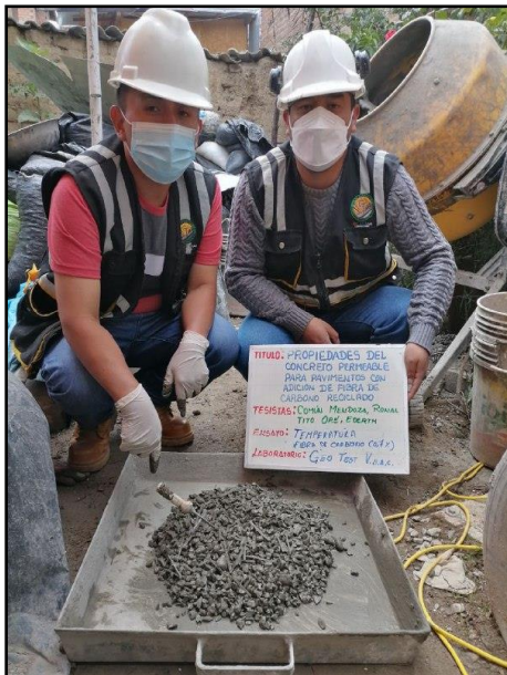
Fotografía N° 33: Medición de la temperatura del concreto permeable. Según NTP 339.184
