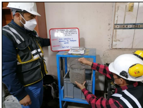
Fotografía N° 4: Colocado de la muestra saturada con superficie seca en la cesta de alambre para determinar su peso en agua a una temperatura 23°C. Según NTP 400.021.
