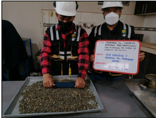
Fotografía N° 3: Realización del ensayo para determinar el Método de ensayo normalizado para peso específico y absorción del agregado grueso, según la NTP 400 021
