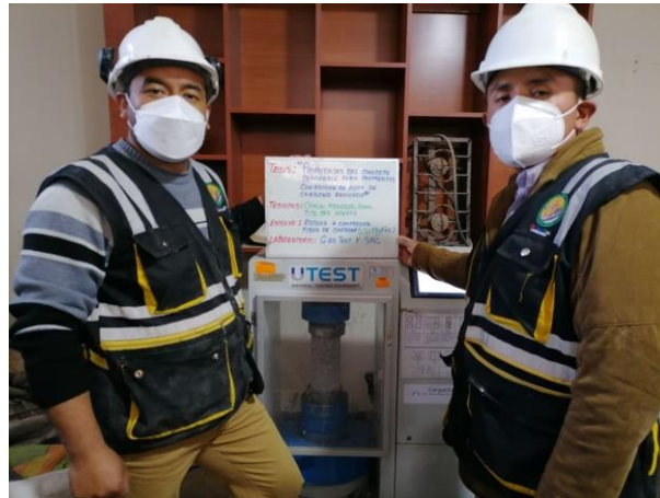
Fotografía N° 46: Introducción de probetas al equipo de compresión. Según la NTP 339.034 / ASTM C39.
