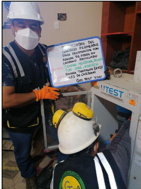
Fotografía N° 54: Introducción de probetas al equipo de compresión. Según la NTP 339.034 / ASTM C39.
