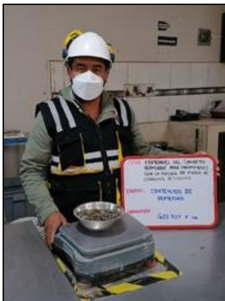
Fotografía N° 8: Desarrollo del ensayo para determinar el contenido de humedad se pesa para saber cuánto de humedad contiene inicialmente el agregado, según la NTP 339-185.
