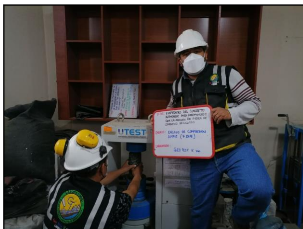
Fotografía N° 38: Introducción de probetas al equipo de compresión. Según la NTP 339.034 / ASTM C39.
