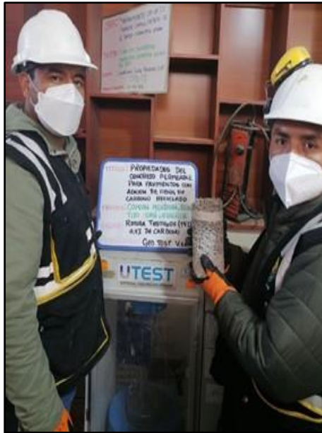
Fotografía N° 52: Introducción de probetas al equipo de compresión. Según la NTP 339.034 / ASTM C39.
