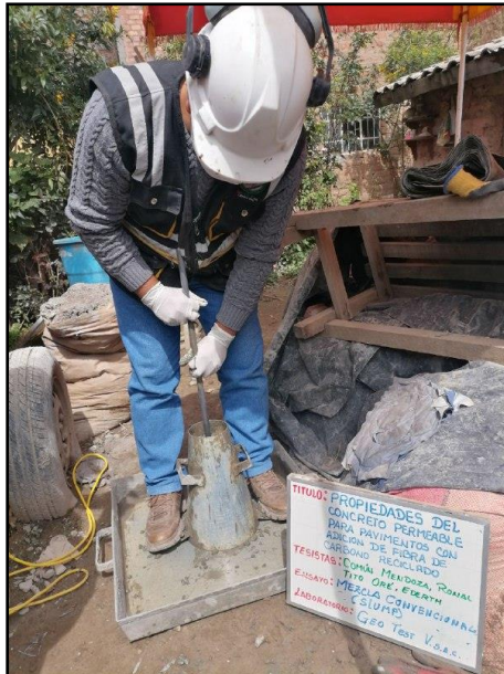
Fotografía N° 13: Medición del asentamiento del concreto fresco convencional. Según NTP 339.035.
