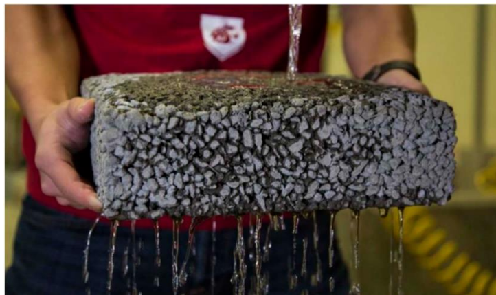
Figura 1: Prueba de permeabilidad de concreto permeable
