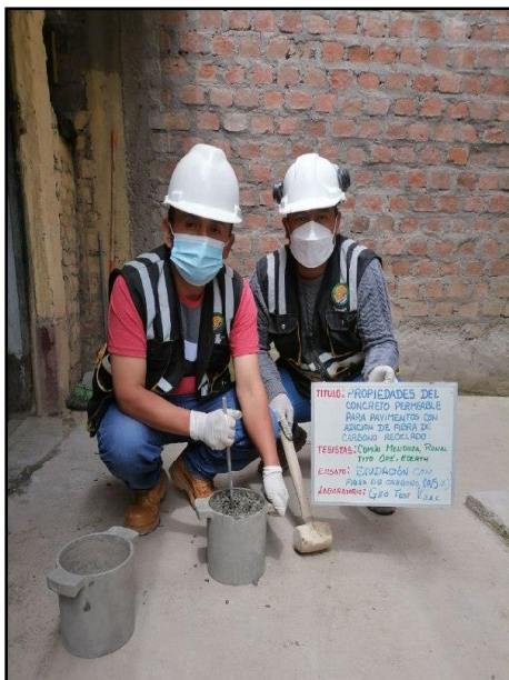
Fotografía N° 29: Determinación de la cantidad relativa de agua que exuda la muestra de concreto permeable en el estado fresco. Según NTP 339.077
