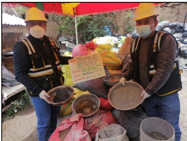
Fotografía N° 31: Vista de materiales tales como agregado grueso, cemento, agua y fibra para la elaboración del concreto convencional. Según NTP 339.183.
