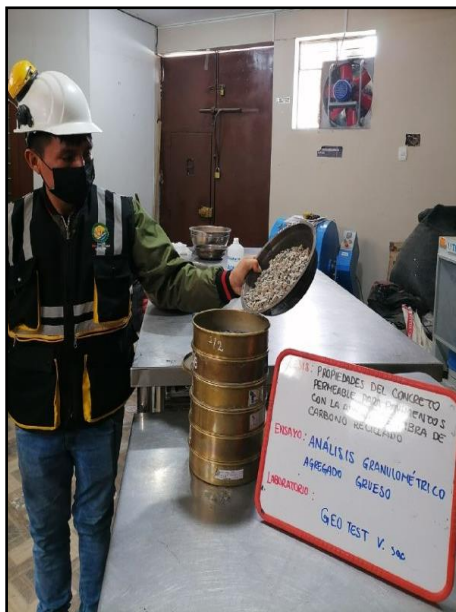
Fotografía N° 1: Ensayo de granulometría del agregado grueso, Tamaño Máximo Nominal (TMN) \frac{1}{2} "', aplico 6 de acuerdo a la NTP 400.012.
