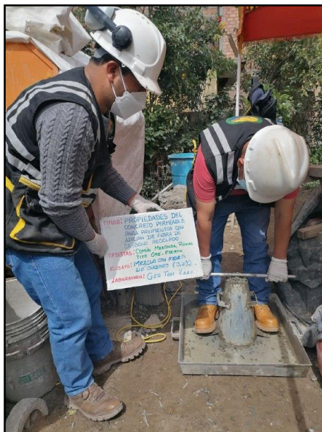
Fotografía N° 20: Medición del asentamiento del concreto fresco permeable. Según NTP 339.035.
