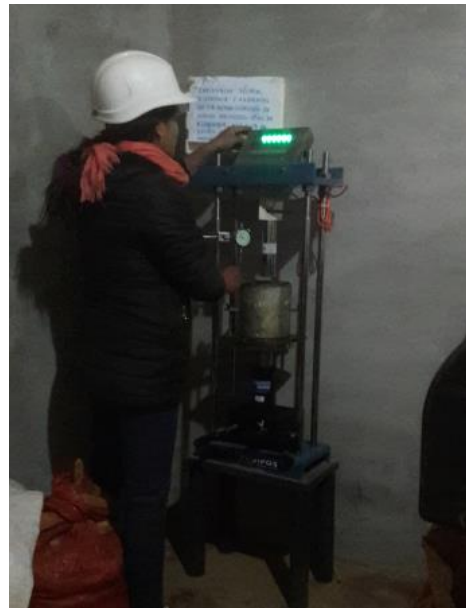
Imagen 29: Preparado de Probetas para Ensayo CBR
