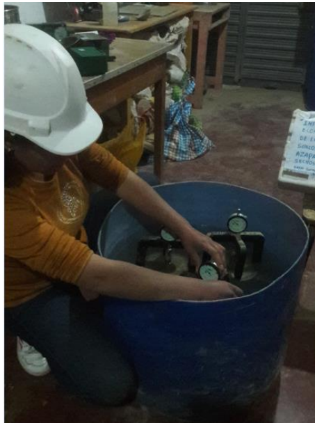
Imagen 27: Preparado de moldes para Sumergimiento (Ensayo CBR)
