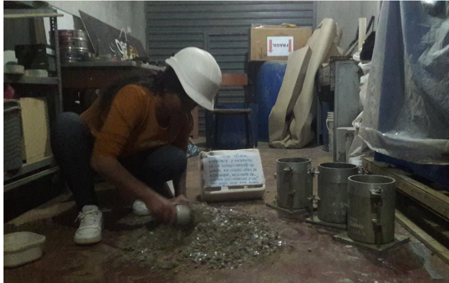
Imagen 25: Mezclado de suelo +PET + cal (Ensayo CBR)
