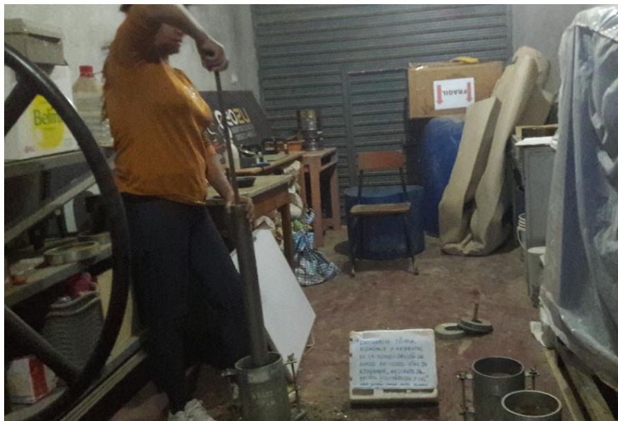
Imagen 26: Compactado de muestra + suelo + cal, antes de ensayo de CBR
