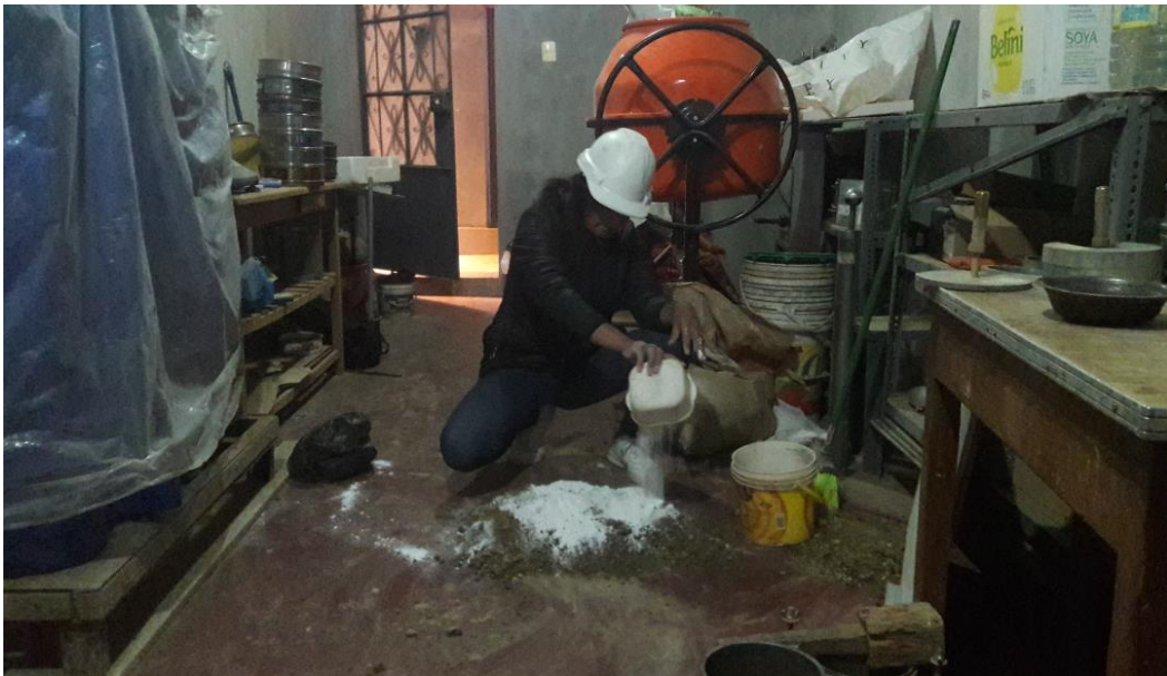
Imagen 20: Mezclado de suelo con cal para ensayo CBR
