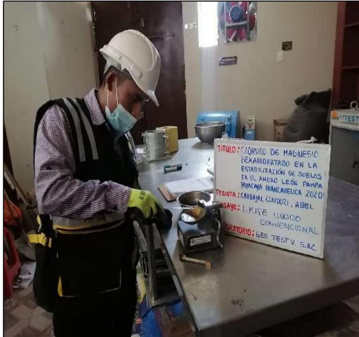
Fotografía N° 6: Ensayo de Limite Líquido con adición de 3% cloruro de magnesio. Según la NTP 339.129.
