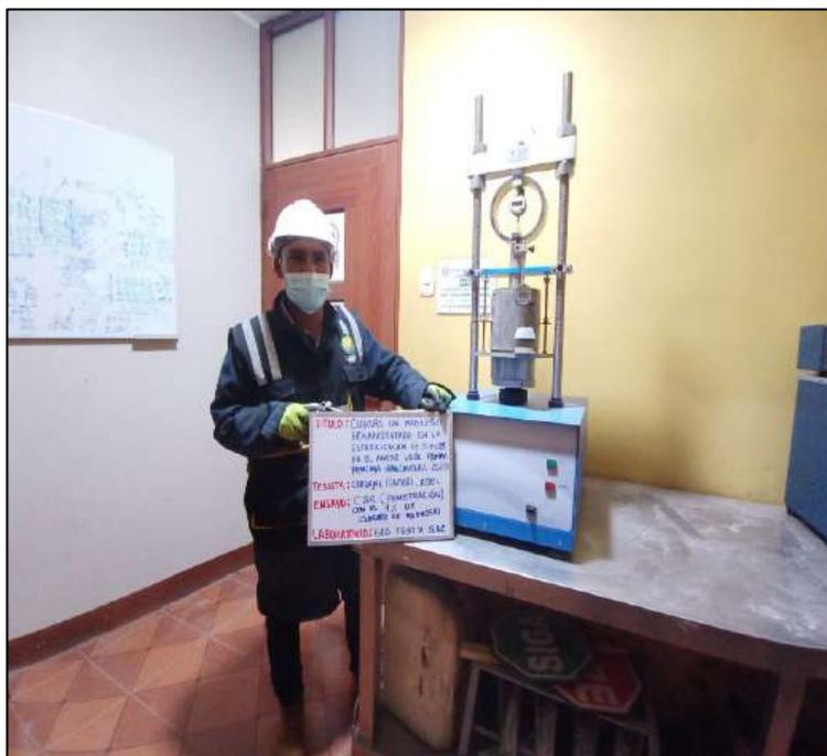
**Fotografía N° 28:** Ensayo para la determinación de un índice de resistencia del suelo, Lectura de penetración en el dial, 0.025 plg a 0.500 plg con adición de 5% cloruro de magnesio. Según la norma 339.175:2002.
