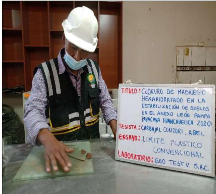
**Fotografía N° 10:** Ensayo de Límites Plástico con adición de 3% cloruro de magnesio. Según la NTP 339.129.
