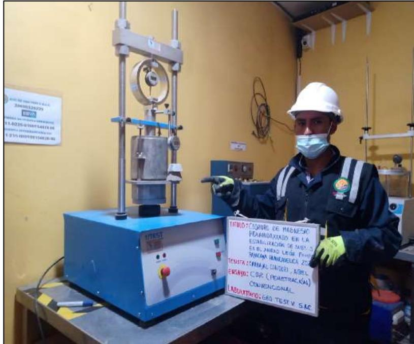
**Fotografía N° 26:** Ensayo para la determinación de un índice de resistencia del suelo, Lectura de penetración en el dial, 0.025 plg a 0.500 plg con adición de 3% cloruro de magnesio. Según la norma 339.175:2002.
