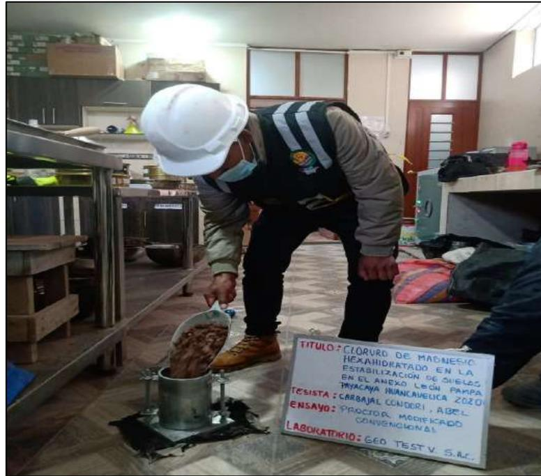
**Fotografía N° 14:** Apisonamiento del material dentro del molde en 5 capas, en un molde con 56 golpes, adición de 3% cloruro de magnesio Según la NTP 339.141.
