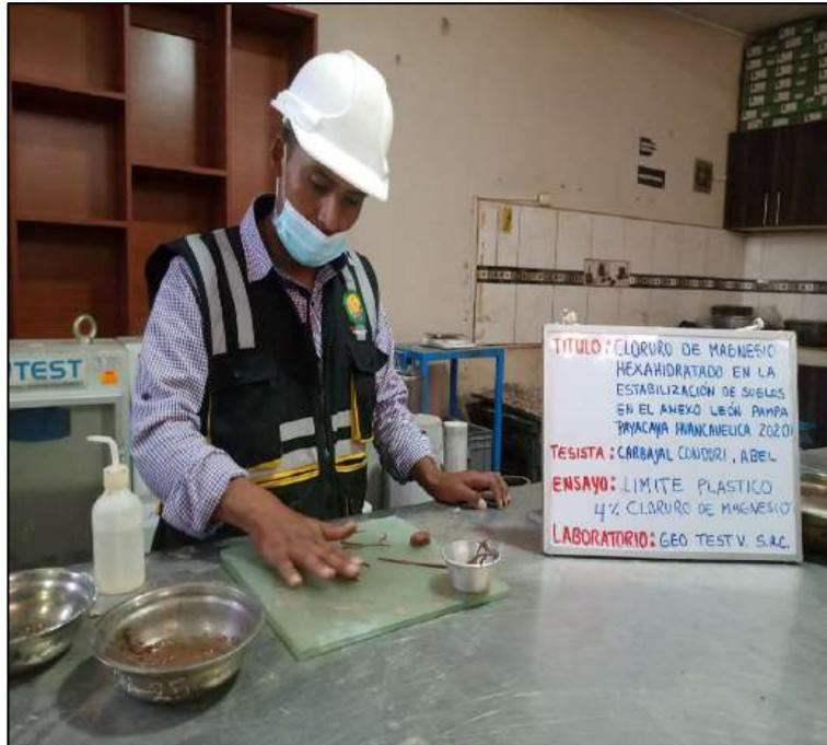
**Fotografía N° 12:** Ensayo de Límites Plástico con adición de 5% cloruro de magnesio. Según la NTP 339.129.
