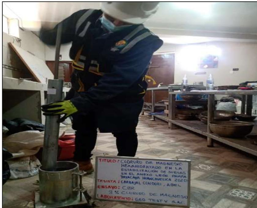
**Fotografía N° 19:** Apisonamiento del material dentro del molde en 5 capas, en un molde con 56 golpes, en el segundo molde por 25 golpes y en el tercer molde 12 golpes con adición 4% cloruro de magnesio. Según la NTP 339.175:2002.
