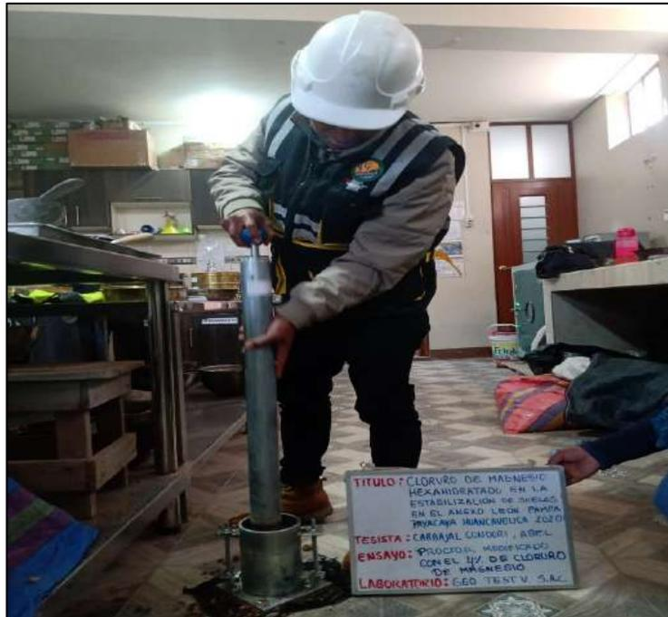
**Fotografía N° 16:** Apisonamiento del material dentro del molde en 5 capas, en un molde con 56 golpes, adición de 5% cloruro de magnesio Según la NTP 339.141.
