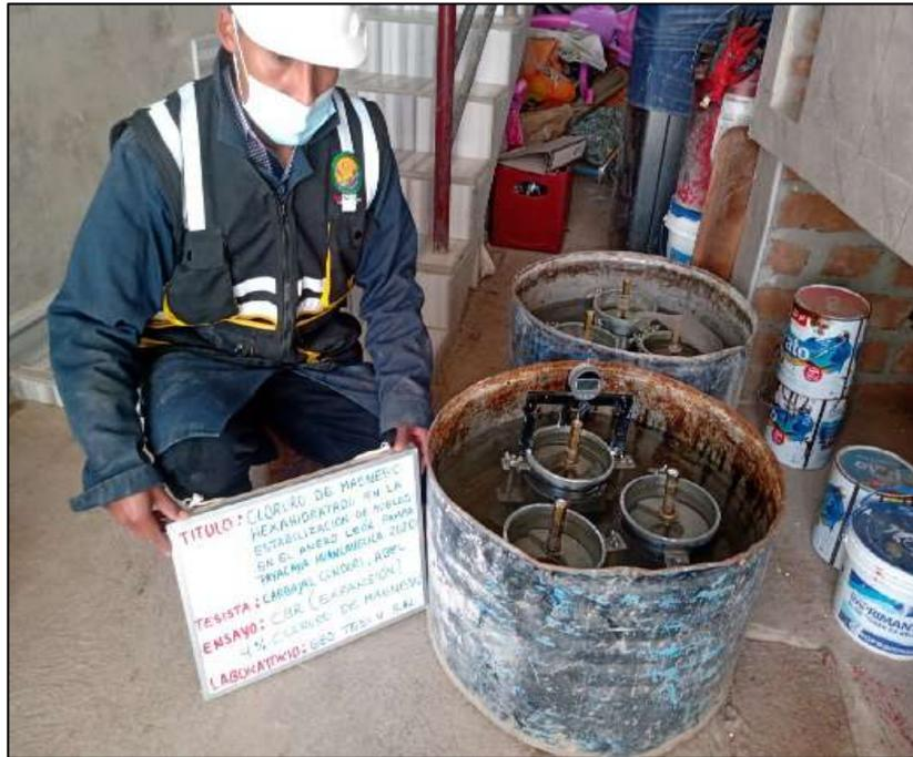
**Fotografía N° 24:** sumergido de los moldes por 96 horas siendo medido la expansión cada 24 horas con adición de % de cloruro de magnesio. Según la NTP 339.175:2002.
