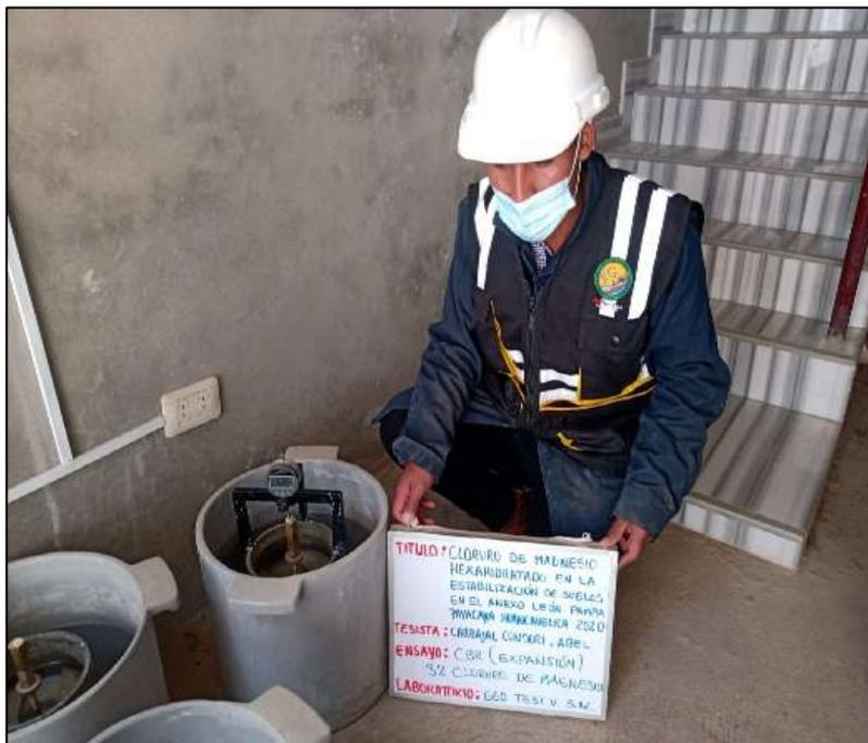
**Fotografía N° 23:** sumergido de los moldes por 96 horas siendo medido la expansión cada 24 horas con adición de 4% de cloruro de magnesio. Según la NTP 339.175:2002.
