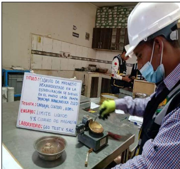
**Fotografía N° 8:** Ensayo de Limite Líquido con adición de 5% cloruro de magnesio. Según la NTP 339.129.
