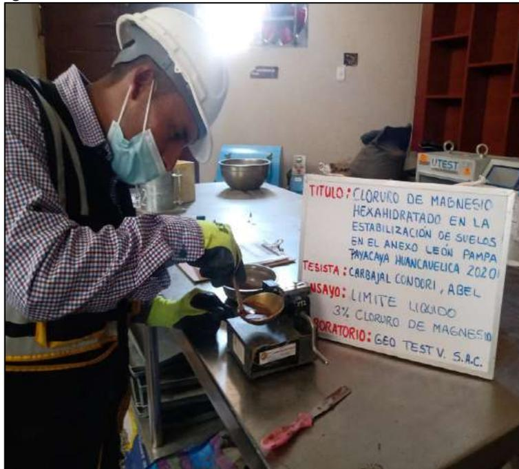
**Fotografía N° 7:** Ensayo de Limite Líquido con adición de 4% cloruro de magnesio. Según la NTP 339.129.
