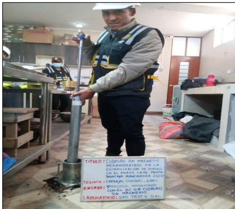
**Fotografía N° 15:** Apisonamiento del material dentro del molde en 5 capas, en un molde con 56 golpes, adición de 4% cloruro de magnesio r Según la NTP 339.141.
