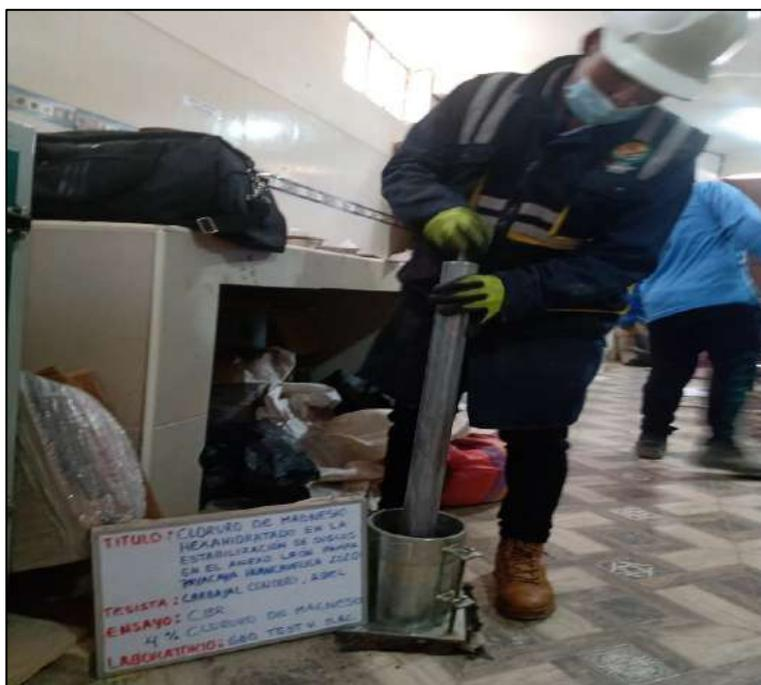
**Fotografía N° 20:** Apisonamiento del material dentro del molde en 5 capas, en un molde con 56 golpes, en el segundo molde por 25 golpes y en el tercer molde 12 golpes con adición 5% cloruro de magnesio. Según la NTP 339.175:2002.
