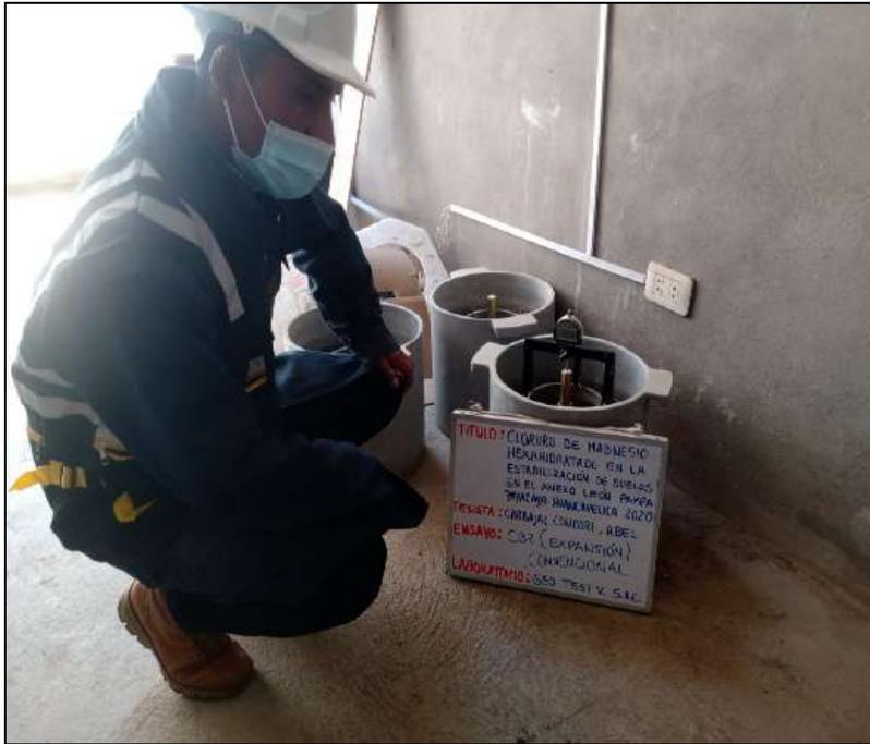
**Fotografía N° 22:** sumergido de los moldes por 96 horas siendo medido la expansión cada 24 horas con adición de 3% de cloruro de magnesio. Según la NTP 339.175:2002.
