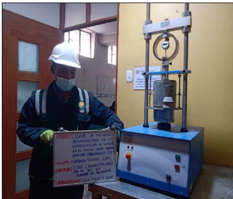
**Fotografía N° 27:** Ensayo para la determinación de un índice de resistencia del suelo, Lectura de penetración en el dial, 0.025 plg a 0.500 plg con adición de 4% cloruro de magnesio. Según la norma 339.175:2002.
