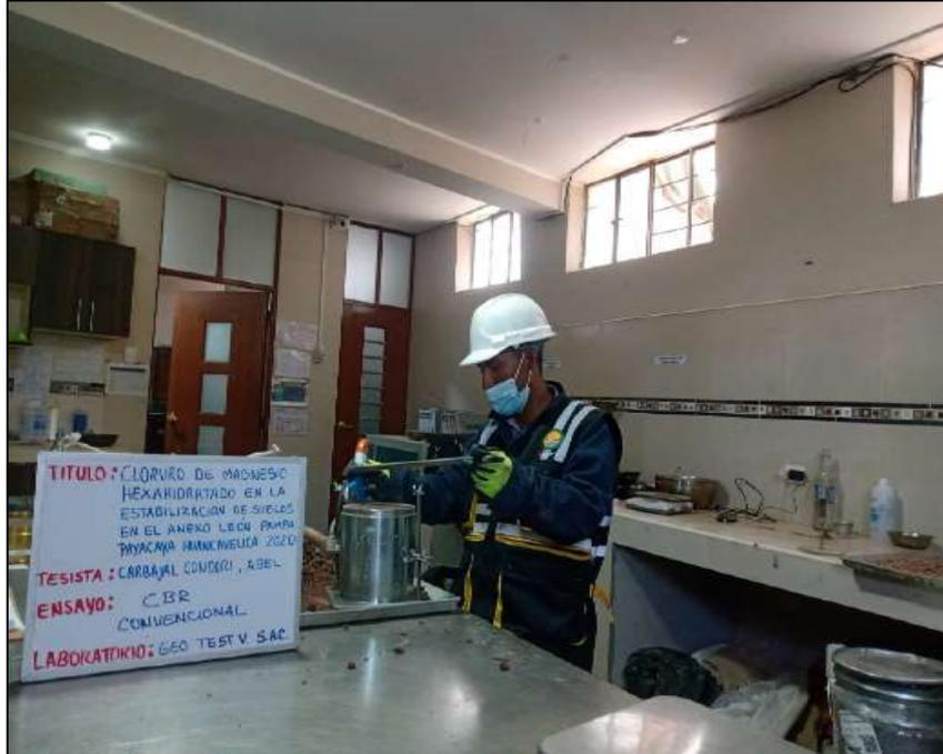
**Fotografía N° 18:** Apisonamiento del material dentro del molde en 5 capas, en un molde con 56 golpes, en el segundo molde por 25 golpes y en el tercer molde 12 golpes con adición 3% cloruro de magnesio. Según la NTP 339.175:2002.
