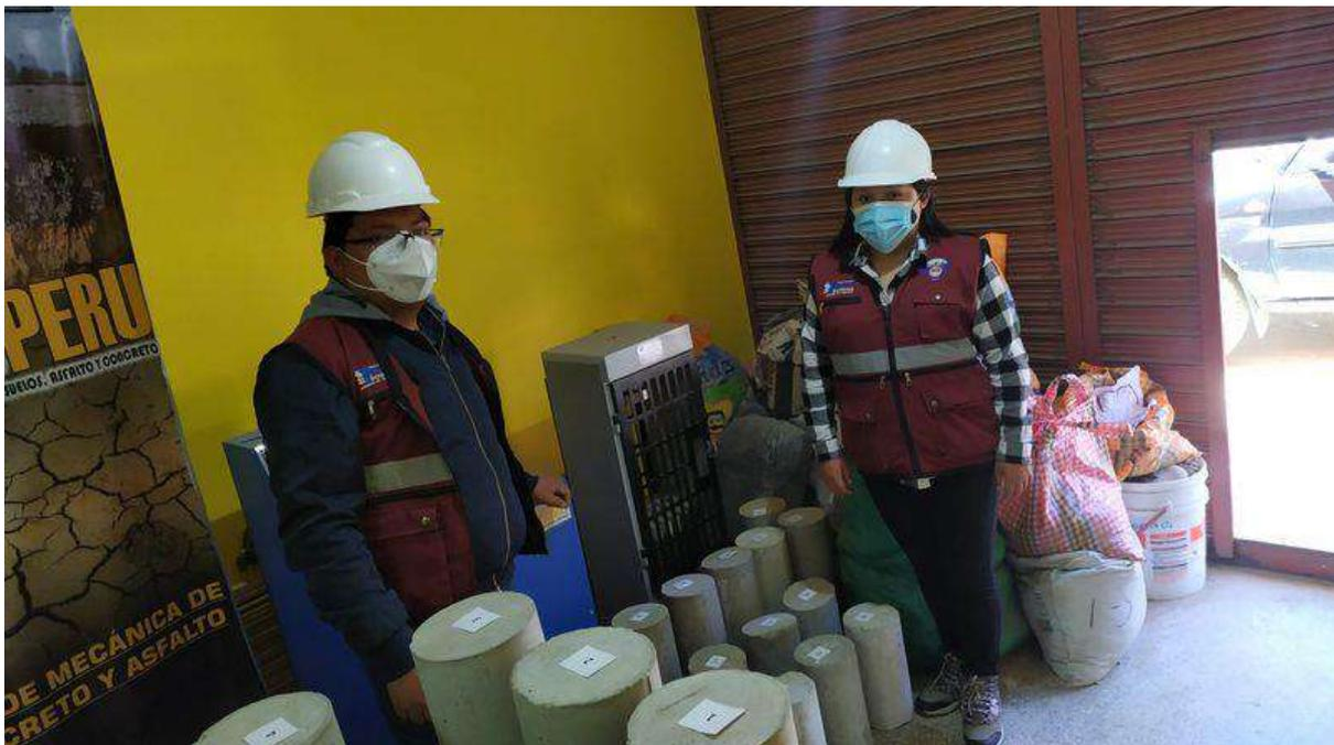
Figura 42. Ensayo de rotura de probetas de concreto cilíndricas con el equipo de prensa hidráulica
