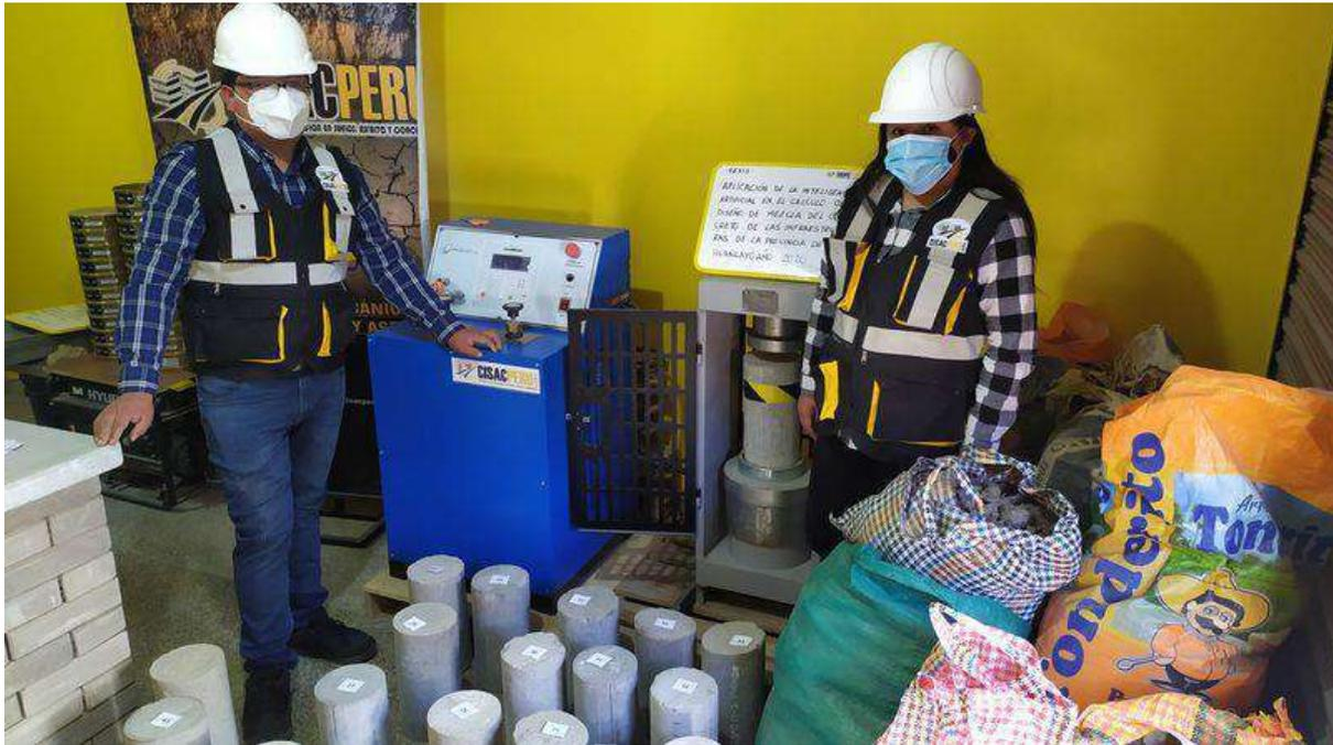
Figura 41. Tesistas en el Laboratorio de Concreto verificando el ensayo de rotura de probetas de concreto cilíndricas con el equipo de prensa hidráulica.
