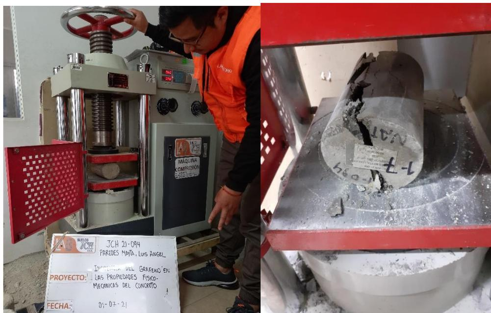
Figura 41. Prueba a tracción
