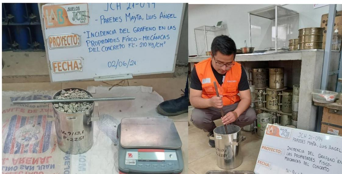
Figura 13. Peso unitario suelto y compactado del agregado grueso
