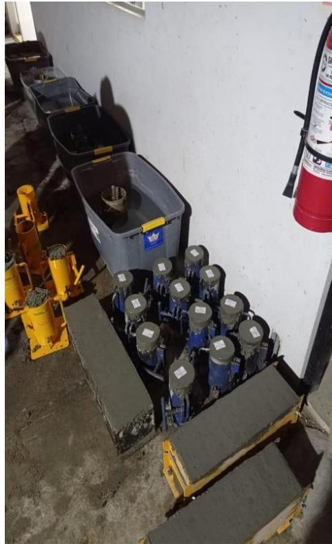
Fotografía 7. Elaboración de probetas cilíndricas y prismáticas (vigas)
