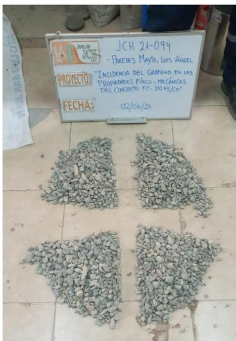
Fotografía 1. Muestreo del agregado grueso
