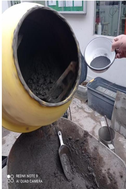
Fotografía 5. Elaboración del concreto con la incorporación de grafeno
