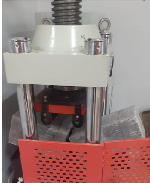
*Figura 5. Viga ensayada en la prueba a flexión*
