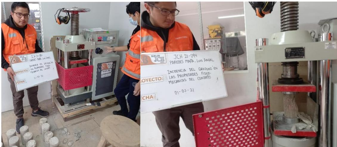
Figura 32. Prueba a compresión
