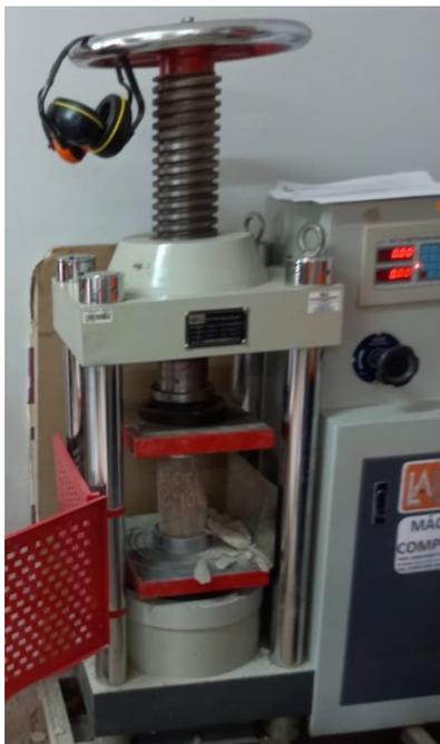
Figura 3. Ensayo a compresión
