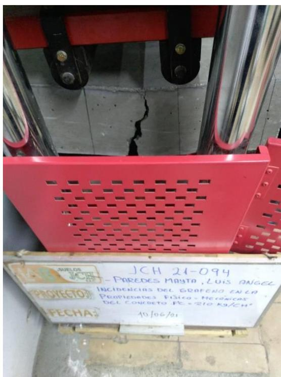
Fotografía 12. Ensayo a flexión de la viga
