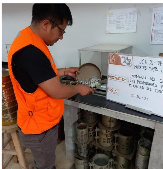
Fotografía 10. Granulometría del agregado grueso
