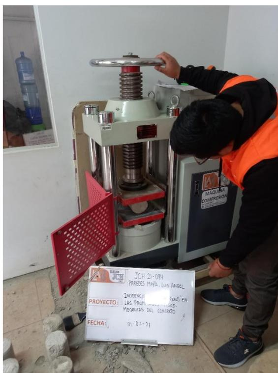
Fotografía 14. Ensayo a tracción por compresión diametral
