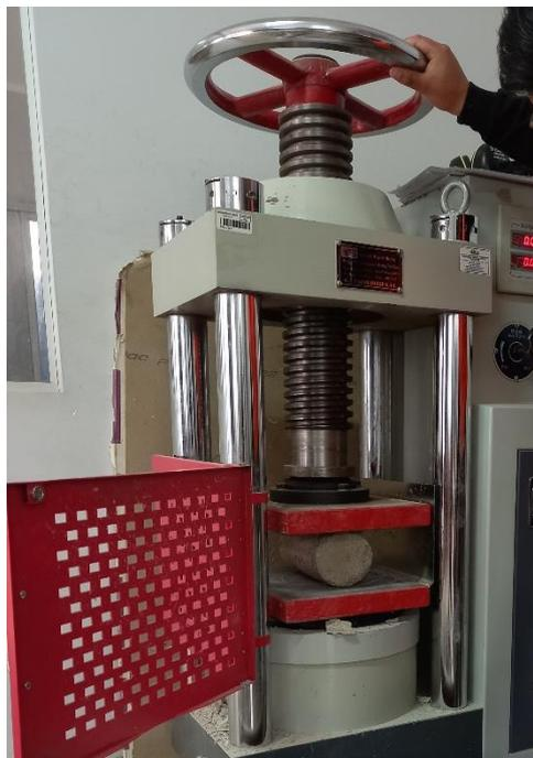
Figura 4. Ensayo de la prueba diametral
