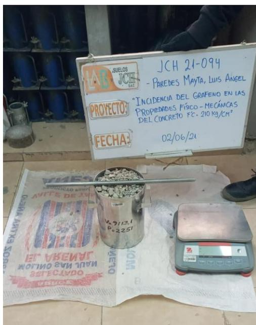
Fotografía 2. Peso unitario suelto del agregado grueso
