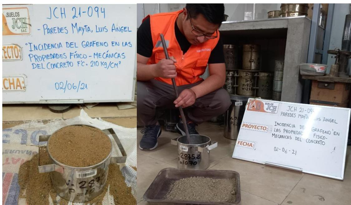
Figura 12. Peso unitario suelto y compactado de agregado fino
