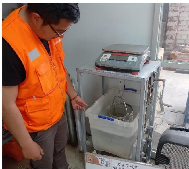
Fotografía 4. Peso en el agua del agregado grueso.
