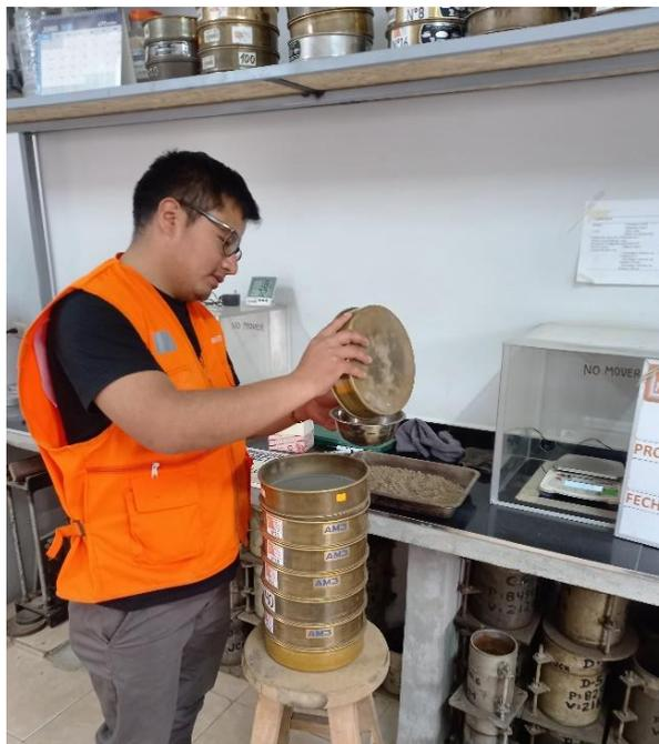
Fotografía 9. Granulometría del agregado fino, pesos retenidos.
