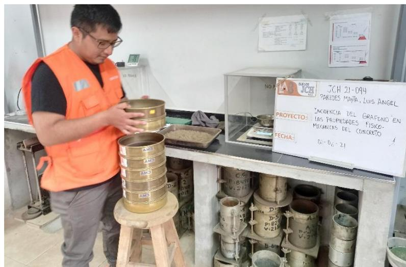
Fotografía 8. Granulometría del agregado fino
