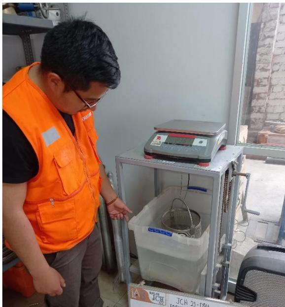
*Figura 15. Pesando la muestra en agua*
