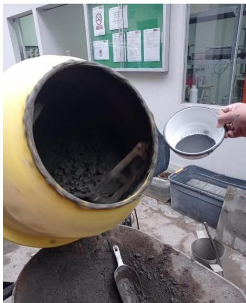
*Figura 16. Mezcladora para el concreto*
