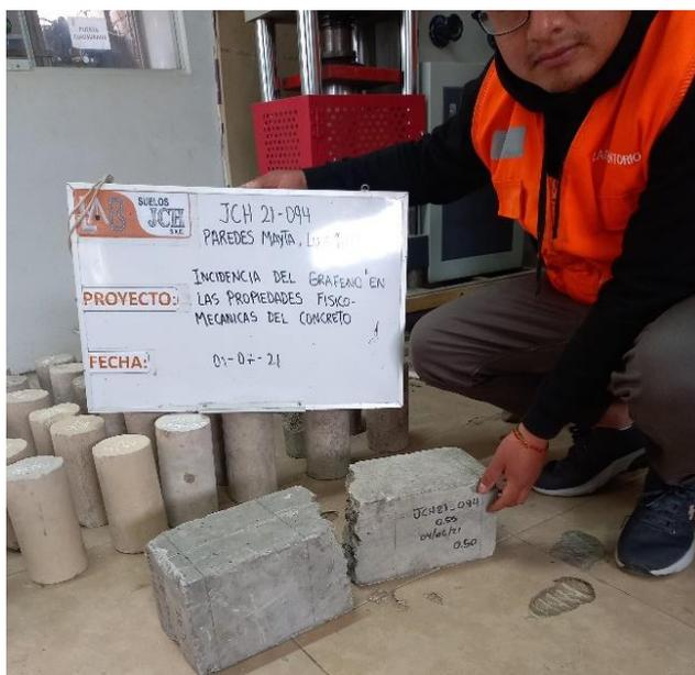
Fotografía 13. Viga ensayada a flexión
