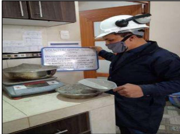
**Fotografía 2.** *Prueba de densidad de campo realizadas a las muestras*
