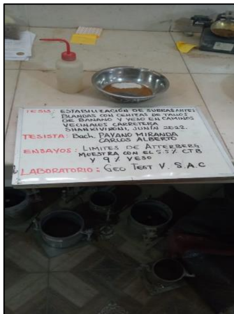
Fotografía N° 24: Ensayo de muestra de control con adición de 5.5% de ceniza más 9% de yeso, según referencia de la norma MTC E 110.
