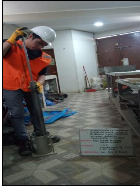
Fotografía N° 43: Apisonamiento del material dentro del molde en 5 capas, en un molde con 56 golpes, en el segundo molde por 25 golpes y en el tercer molde 12 golpes con 6% de ceniza más 10% de yeso, según referencia de la norma MTC E 132.
