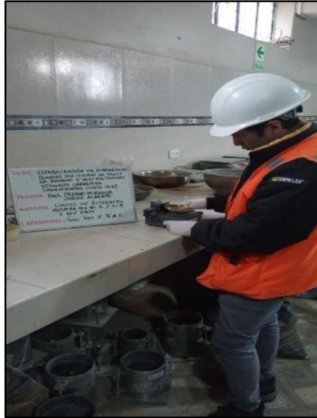
Fotografía N° 19: Ensayo de límite líquido con adición de 6% de ceniza más 10% de yeso, según referencia de la norma MTC E 110.
