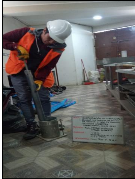
Fotografía N° 47: Apisonamiento del material dentro del molde en 5 capas, en un molde con 56 golpes, en el segundo molde por 25 golpes y en el tercer molde 12 golpes con 5.5% de ceniza más 11% de yeso, según referencia de la norma MTC E 132.
