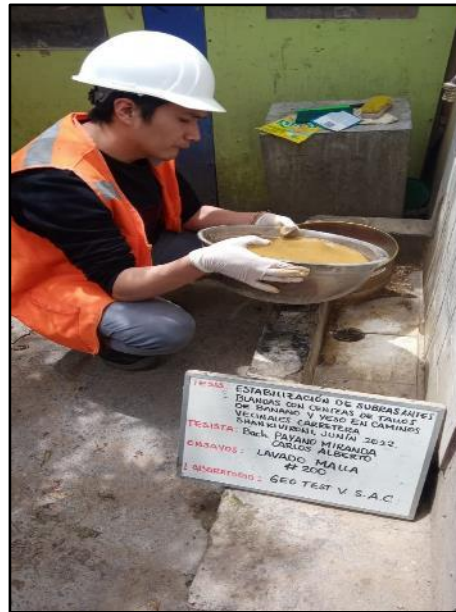
Fotografía N° 9: Ensayo del material más fino que pasa por el tamiz N°200, según referencia de la norma MTC E 202.
