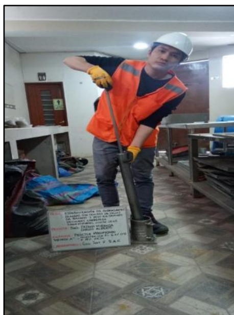
Fotografía N° 33: Apisonamiento del material con adición de 6% de ceniza más 10% de yeso dentro del molde en 5 capas, en un molde con 56 golpes, según referencia de la norma MTC E 115.
