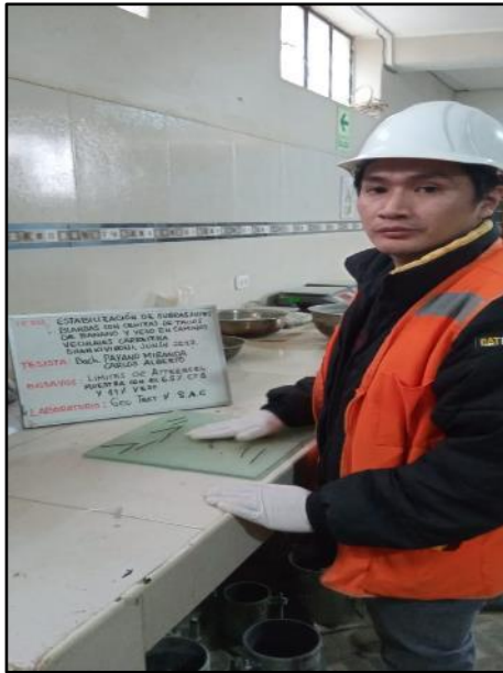
Fotografía N° 17: Ensayo de Limite plástico con adición de 6.5% de ceniza más 11% de yeso, según referencia de la norma MTC E 111.
