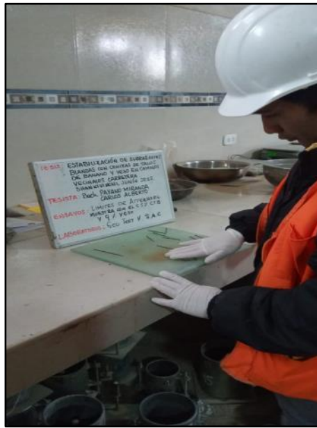
Fotografía N° 23: Ensayo de Límite plástico con adición de 5.5% de ceniza más 9% de yeso, según referencia de la norma MTC E 111.
