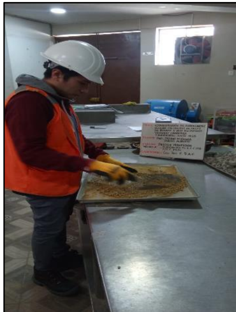
Fotografía N° 36: Homogenización del material con adición de 5.5% de ceniza más 11% de yeso, en un molde con 56 golpes, según referencia de la norma MTC E 115.
