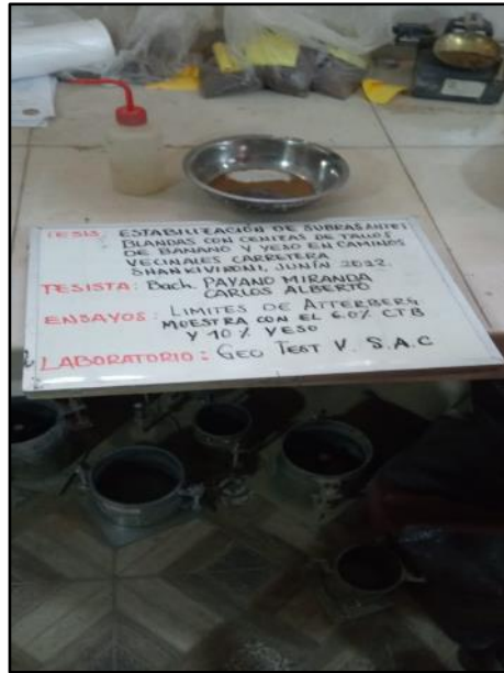
Fotografía N° 21: Ensayo de muestra de control con adición de 6% de ceniza más 10% de yeso, según referencia de la norma MTC E 110.
