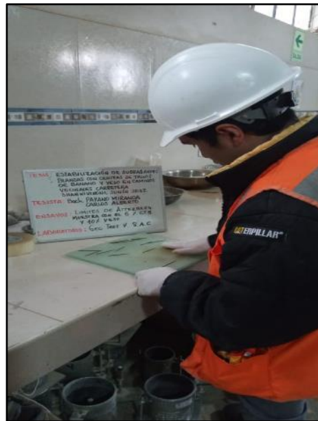
Fotografía N° 20: Ensayo de Límite plástico con adición de 6% de ceniza más 10% de yeso, según referencia de la norma MTC E 111.
