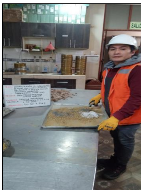
Fotografía N° 34: Homogenización del material con adición de 5.5% de ceniza más 9% de yeso, en un molde con 56 golpes, según referencia de la norma MTC E 115.
