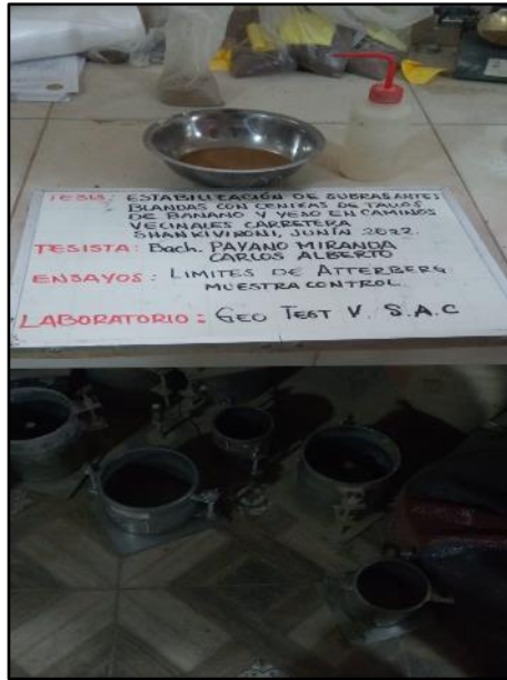
Fotografía N° 15: Ensayo de muestra de control, según referencia de la norma MTC E 110.
