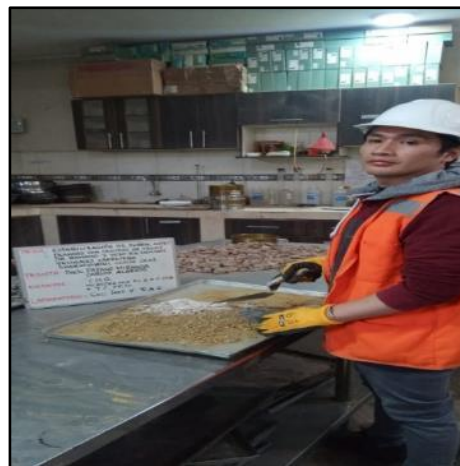
Fotografía N° 44: Homogenización con adición de 5.5% de ceniza más 9% de yeso del material dentro del molde en 5 capas, en un molde con 56 golpes, en el segundo molde por 25 golpes y en el tercer molde 12 golpes, según referencia de la norma MTC E 132.
