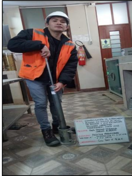
Fotografía N° 31: Apisonamiento del material con adición de 6.5% de ceniza más 11% de yeso dentro del molde en 5 capas, en un molde con 56 golpes, según referencia de la norma MTC E 115.
