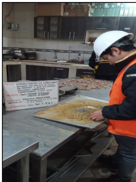
Fotografía N° 30: Homogenización del material con adición de 6.5% de ceniza más 11% de yeso, en un molde con 56 golpes, según referencia de la norma MTC E 115.
