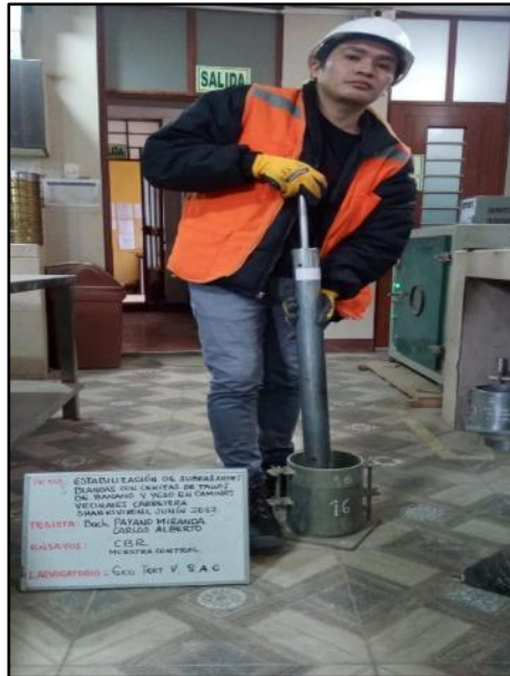
Fotografía N° 39: Apisonamiento convencional del material dentro del molde en 5 capas, en un molde con 56 golpes, en el segundo molde por 25 golpes y en el tercer molde 12 golpes, según referencia de la norma MTC E 132.
