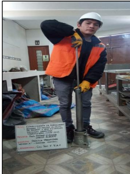
Fotografía N° 29: Apisonamiento del material convencional dentro del molde en 5 capas, en un molde con 56 golpes, según referencia de la norma MTC E 115.
