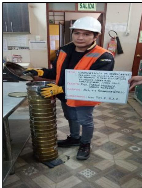
Fotografía N° 10: Ensayo de análisis granulométrico, separación de material por tamaño de partículas método de tamizado, según referencia de la norma MTC E 107.
