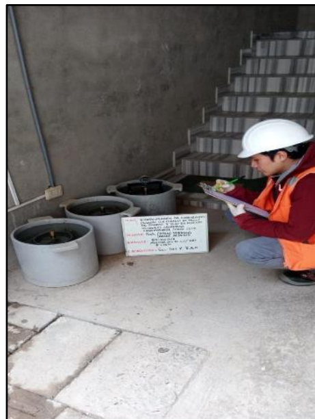
Fotografía N° 50: Sumergido de los moldes por 96 horas siendo medido la expansión cada 24 horas con adición de 6% de ceniza más 10% de yeso, según referencia de la norma MTC E 132.
