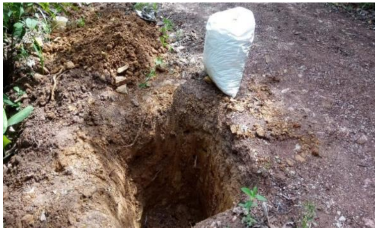
Fotografía N° 5: Extracción de la muestra de suelo de la calicata C-01
