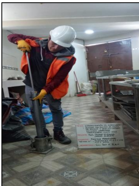
Fotografía N° 37: Apisonamiento del material con adiconamiento de 5.5% de ceniza más 11% de yeso dentro del molde en 5 capas, en un molde con 56 golpes, según referencia de la norma MTC E 115.
