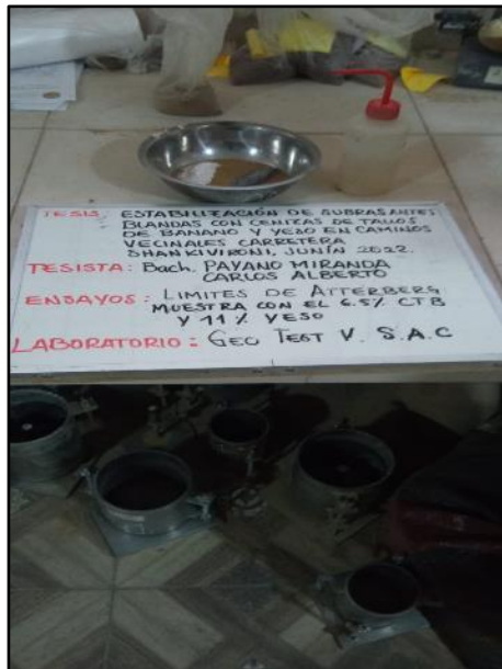
Fotografía N° 18: Ensayo de muestra de control con adición de 6.5% de ceniza más 11% de yeso, según referencia de la norma MTC E 110.
