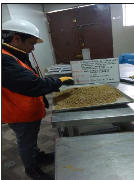
Fotografía N° 38: Homogenización convencional del material dentro del molde en 5 capas, en un molde con 56 golpes, en el segundo molde por 25 golpes y en el tercer molde 12 golpes, según referencia de la norma MTC E 132.
