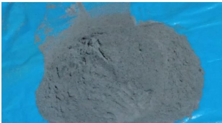
Fotografía N° 3: Obtención de las cenizas de tallos de banano
