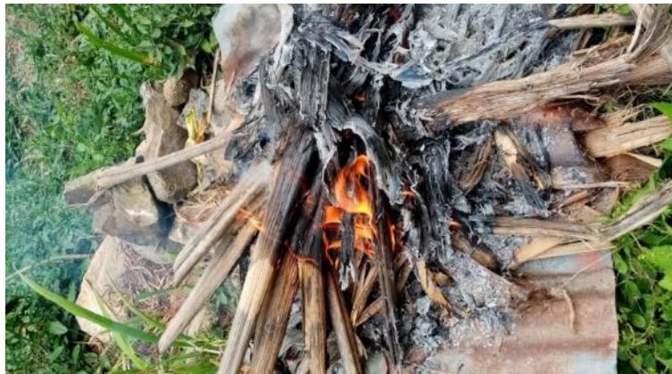
Fotografía N° 2: Proceso para la obtención de las cenizas de tallos de banano
