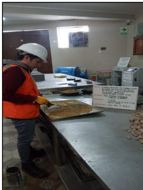
Fotografía N° 46: Homogenización con adición de 5.5% de ceniza más 11% de yeso del material dentro del molde en 5 capas, en un molde con 56 golpes, en el segundo molde por 25 golpes y en el tercer molde 12 golpes, según referencia de la norma MTC E 132.
