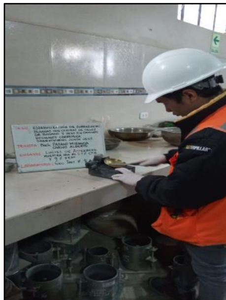
Fotografía N° 22: Ensayo de limite liquido con adición de 5.5% de ceniza más 9% de yeso, según referencia de la norma MTC E 110.
