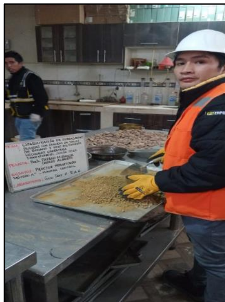
Fotografía N° 28: Homogenización del material convencional dentro del molde en 5 capas, en un molde con 56 golpes, según referencia de la norma MTC E 115.
