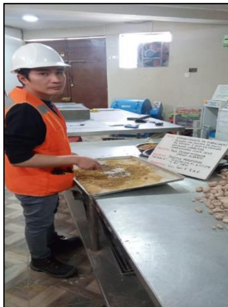
Fotografía N° 32: Homogenización del material con adición de 6% de ceniza más 10% de yeso, en un molde con 56 golpes, según referencia de la norma MTC E 115.
