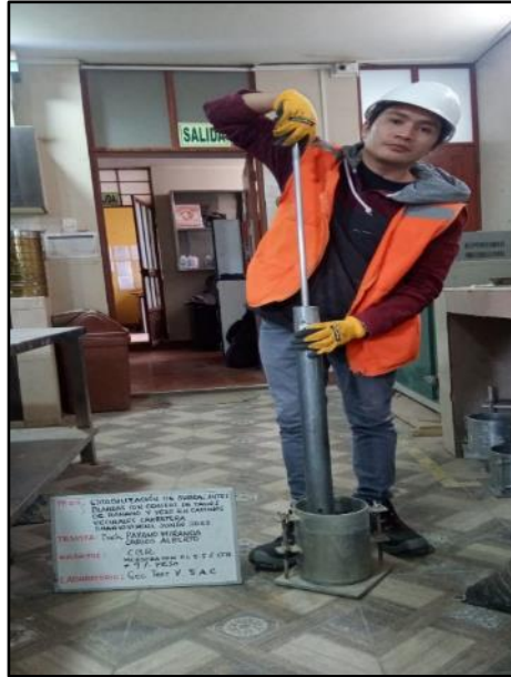
Fotografía N° 45: Apisonamiento del material dentro del molde en 5 capas, en un molde con 56 golpes, en el segundo molde por 25 golpes y en el tercer molde 12 golpes con 5.5% de ceniza más 9% de yeso, según referencia de la norma MTC E 132.
