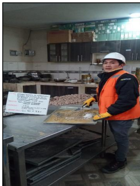
Fotografía N° 40: Homogenización con adición de 6.5% de ceniza más 11% de yeso del material dentro del molde en 5 capas, en un molde con 56 golpes, en el segundo molde por 25 golpes y en el tercer molde 12 golpes, según referencia de la norma MTC E 132.
