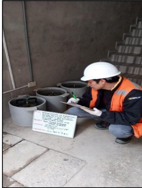
Fotografía N° 49: Sumergido de los moldes por 96 horas siendo medido la expansión cada 24 horas con adición de 6.5% de ceniza más 11% de yeso, según referencia de la norma MTC E 132.
