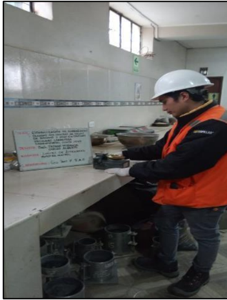
Fotografía N° 13: Ensayo de limite líquido con muestra de control, según referencia de la norma MTC E 110.
