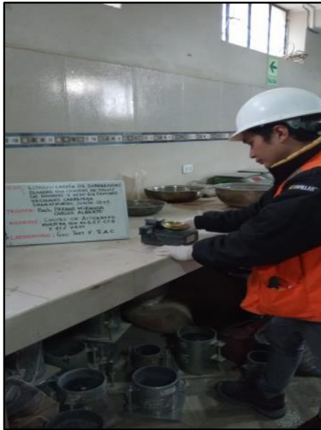
Fotografía N° 25: Ensayo de límite líquido con adición de 5.5% de ceniza más 11% de yeso, según referencia de la norma MTC E 110.
