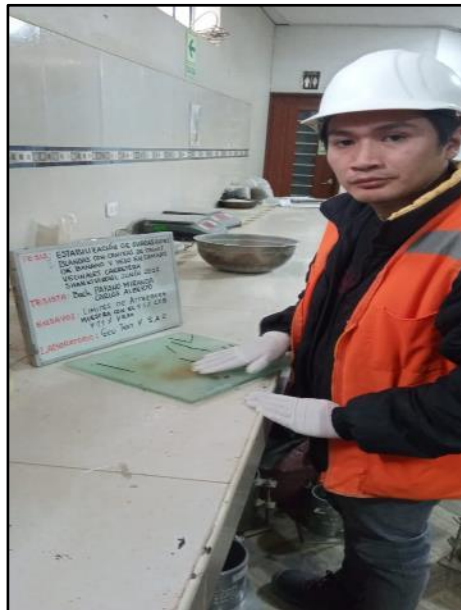
Fotografía N° 26: Ensayo de Límite plástico con adición de 5.5% de ceniza más 11% de yeso, según referencia de la norma MTC E 111.
