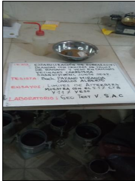
Fotografía N° 27: Ensayo de muestra de control con adición de 5.5% de ceniza más 11% de yeso, según referencia de la norma MTC E 110.
