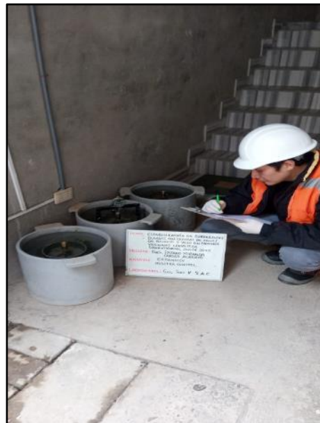
Fotografía N° 48: Sumergido de los moldes por 96 horas siendo medido la expansión cada 24 horas convencional, según referencia de la norma MTC E 132.
