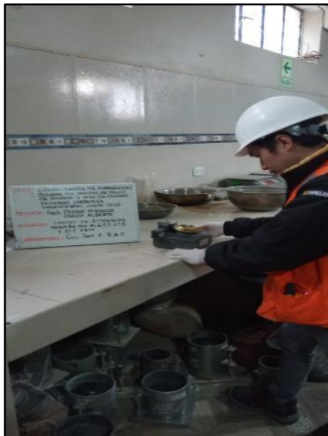
Fotografía N° 16: Ensayo de limite liquido con adición de 6.5% de ceniza más 11% de yeso, según referencia de la norma MTC E 110.
