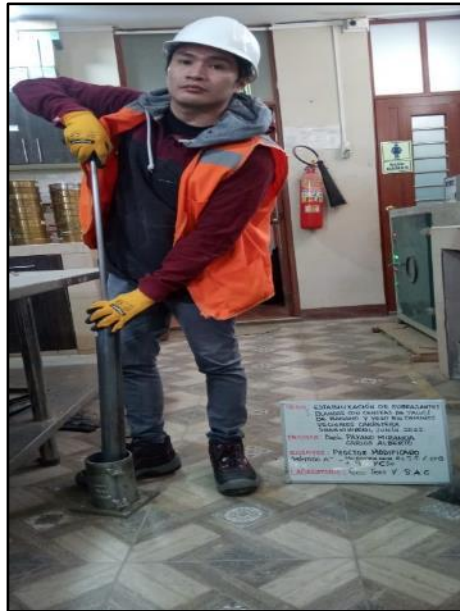
Fotografía N° 35: Apisonamiento del material con adición de 5.5% de ceniza más 9% de yeso dentro del molde en 5 capas, en un molde con 56 golpes, según referencia de la norma MTC E 115.
