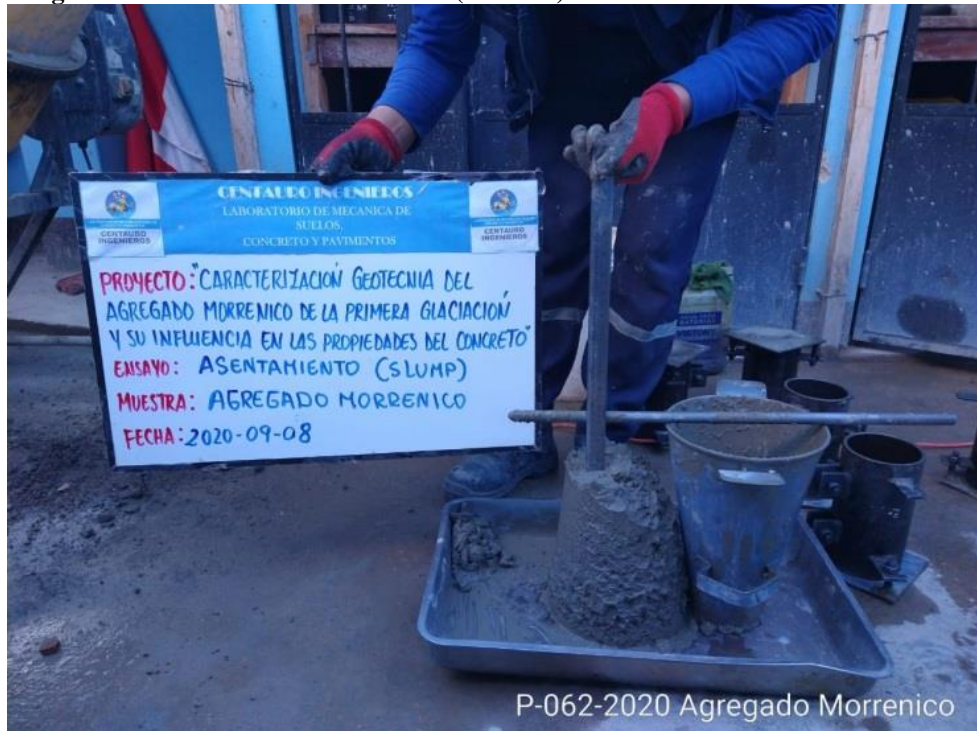
Figura 17: Asentamiento de concreto (SLUMP)
