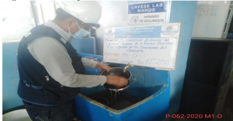
Figura 13: Material Que Pasa Por La Malla N°200
