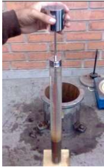
Figura 14: Ensayo equivalente de arena.
