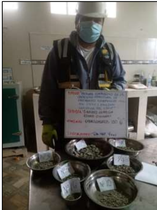
Fotografía 9: Determinar los rangos de gradación para tratamientos superficiales con el uso número "8" tamiz por tamiz según la norma (ASTM D448).
