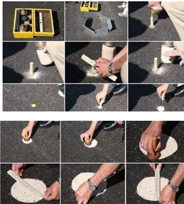
Figura 18: Procedimiento profundidad de textura método círculo de Arena
