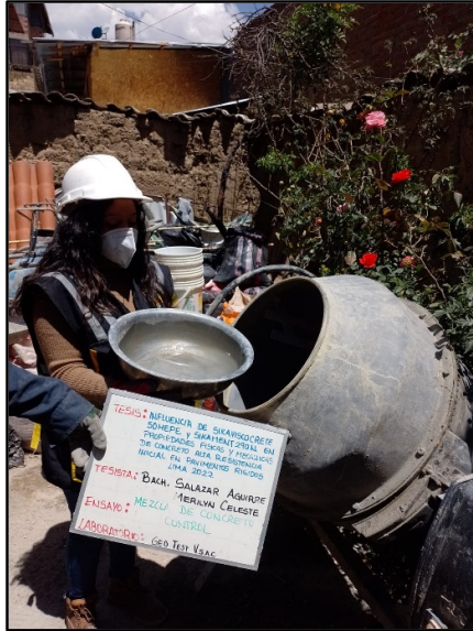
Figura 20: Vista de materiales tales como el agua para la elaboración del concreto convencional, según referencia de la norma NTP 339.183.
