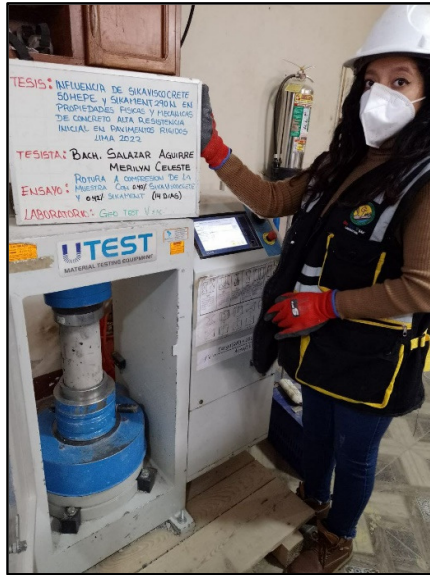
Figura 76: Testigos cilíndricos incorporados los aditivos 0.40% sikaviscocrete 50 HEPE y 0.42% sikament 290N para la resistencia a la compresión de los 14 días de edad, según referencia de la norma NTP 339.034 / ASTM C39.
