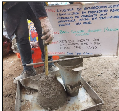
Figura 47: Medición del asentamiento del concreto con adición de los aditivos 0.64% de viscocrete 50 HEPE y 0.57% sikament 290N, según referencia de la norma NTP 339.035.
