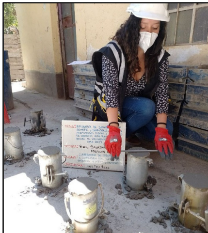
Figura 51: Elaboración de testigos cilíndricos con adición de los aditivos 0.64% de viscocrete 50 HEPE y 0.57% sikament 290N, según referencia de la norma NTP 339.034 / ASTM C39.
