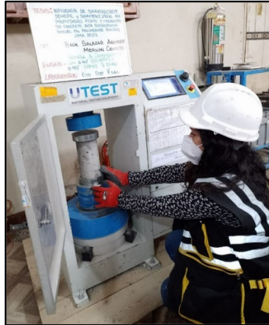
Figura 72: Testigos cilíndricos incorporados los aditivos 0.40% sikaviscocrete 50 HEPE y 0.42% sikament 290N para la resistencia la resistencia a la compresión de los 3 días de edad, según referencia de la norma NTP 339.034 / ASTM C39.
