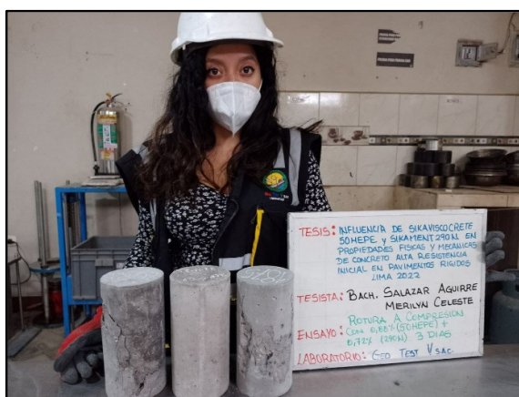
Figura 89: Testigos cilíndricos incorporados los aditivos 0.88% sikaviscocrete 50 HEPE y 0.72% sikament 290N para la resistencia la resistencia a la compresión de los 3 días de edad, según referencia de la norma NTP 339.034 / ASTM C39.
