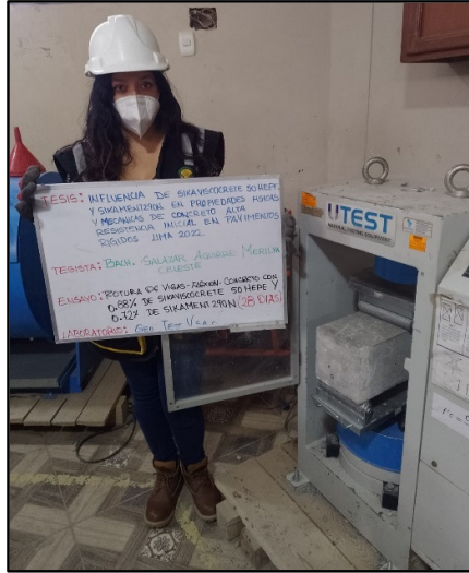
Figura 118: Testigos cilíndricos incorporados los aditivos 0.88% sikaviscoresete 50 HEPE y 0.72% sikament 290N para la resistencia a la flexión de los 28 días de edad, según referencia de la norma NTP 339.034 / ASTM C39.
