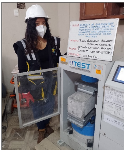
Figura 96: Testigos verticales convencionales para la resistencia a la flexión a los 7 días de edad, según referencia de la norma NTP 339.034 / ASTM C39.
