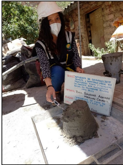
Figura 46: Medición de la temperatura del concreto saliendo de la mezcladora con adición de los aditivos 0.64% de viscocrete 50 HEPE y 0.57% sikament 290N, según referencia de la norma NTP 339.184.
