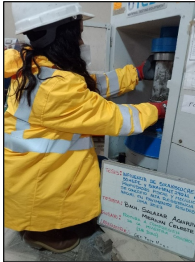
Figura 70: Testigos cilíndricos convencional para la resistencia la resistencia a la compresión de los 28 días de edad, según referencia de la norma NTP 339.034 / ASTM C39.
