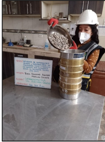
Figura 8: Ensayo de análisis granulométrico del agregado grueso, según referencia de la norma NTP 400.012.
