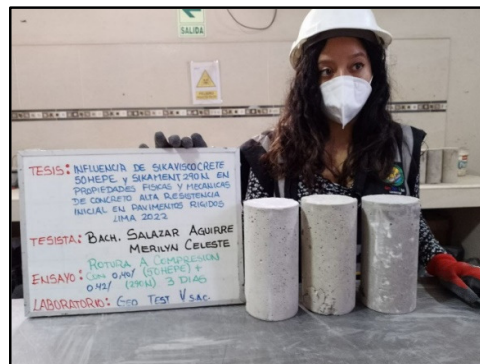
Figura 73: Testigos cilíndricos incorporados los aditivos 0.40% sikaviscocrete 50 HEPE y 0.42% sikament 290N para la resistencia la resistencia a la compresión de los 3 días de edad, según referencia de la norma NTP 339.034 / ASTM C39.
