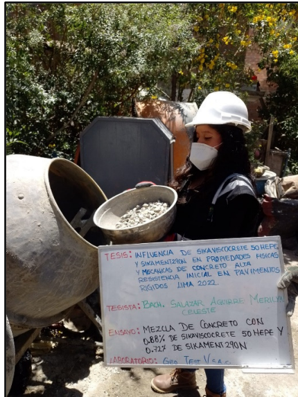
Figura 54: Vista de materiales tales como el agregado grueso para la elaboración del concreto con 0.88% de viscocrete 50 HEPE y 0.72% sikament 290N, según referencia de la norma NTP 339.183.
