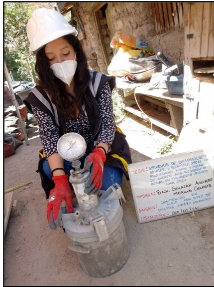
Figura 48: Control del contenido del aire del concreto fresco con adición de los aditivos 0.64% de viscocrete 50 HEPE y 0.57% sikament 290N, según referencia de la norma NTP 339.083.
