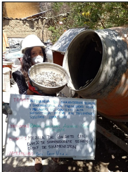
Figura 41: Vista de materiales tales como el agregado grueso para la elaboración del concreto con 0.64% de viscocrete 50 HEPE y 0.57% sikament 290N, según referencia de la norma NTP 339.183.
