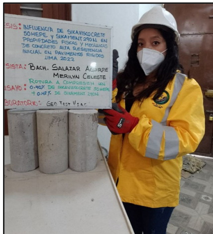
Figura 79: Testigos cilíndricos incorporados los aditivos 0.40% sikaviscocrete 50 HEPE y 0.42% sikament 290N para la resistencia la resistencia a la compresión de los 28 días de edad, según referencia de la norma NTP 339.034 / ASTM C39.
