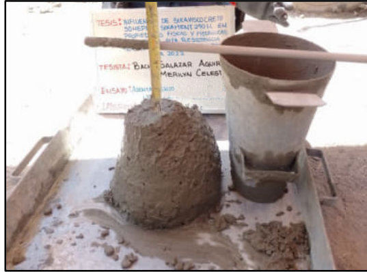
Figura 22: Medición del asentamiento del concreto convencional, según la norma NTP 339.035.
