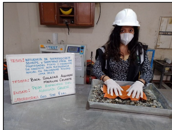
Figura 11: Realización del ensayo para determinar el Método de ensayo normalizado para peso específico y absorción del agregado grueso, según referencia de la norma NTP 400.022.
