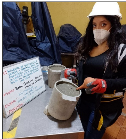
Figura 61: Control de la exudación del concreto con adición de los aditivos 0.88% de viscoscrete 50 HEPE y 0.72% sikament 290N, según referencia de la norma NTP 339.077.
