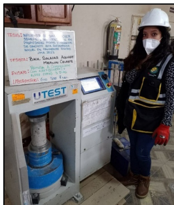
Figura 88: Testigos cilíndricos incorporados los aditivos 0.88% sikaviscocrete 50 HEPE y 0.72% sikament 290N para la resistencia la resistencia a la compresión de los 3 días de edad, según referencia de la norma NTP 339.034 / ASTM C39.
