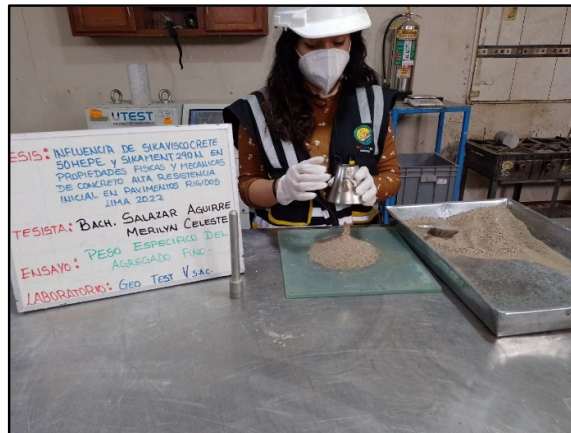
Figura 9: Ensayo con el molde cónico, metálico de 40\pm 3 mm de diámetro, y la varilla de apisonamiento de 340\pm 15 gr, normalizado peso específico y absorción del agregado fino, según su referencia de la normal NTP 400.022.
