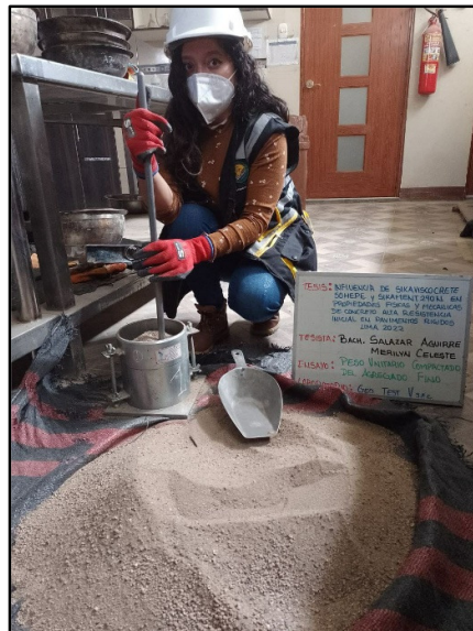
Figura 13: Determinación del Peso Unitario Compactado y el porcentaje de los vacíos del agregado fino, según la norma NTP 400.017.
