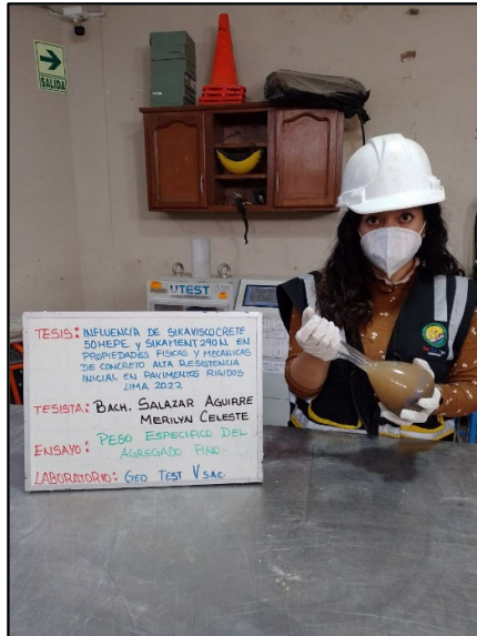
Figura 10: Fiola herramienta normalizado peso específico y absorción del agregado fino, según referencia de la norma NTP 400.022
