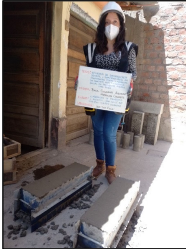
Figura 52: Elaboración de vigas con adición de los aditivos 0.40% de viscocrete 50 HEPE y 0.42% sikament 290N, según referencia de la norma NTP 339.034 / ASTM C39.
