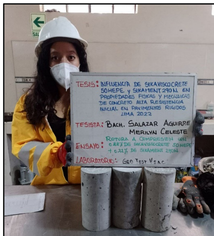
Figura 95: Testigos cilíndricos incorporados los aditivos 0.88% sikaviscocrete 50 HEPE y 0.72% sikament 290N para la resistencia a la compresión de los 28 días de edad, según referencia de la norma NTP 339.034 / ASTM C39.
