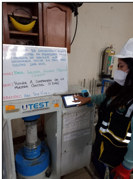
Figura 66: Testigos cilíndricos convencional para la resistencia a la resistencia a la compresión de los 7 días de edad, según referencia de la norma NTP 339.034 / ASTM C39
