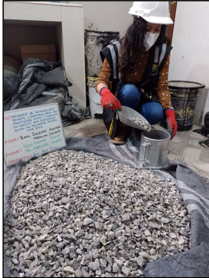
Figura 16: Determinación del Peso Unitario Suelto y el porcentaje de los vacíos del agregado grueso, según la norma NTP 400.017.
