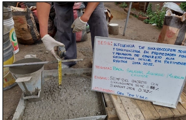
Figura 59: Medición del asentamiento del concreto con adición de los aditivos 0.88% de viscocrete 50 HEPE y 0.72% sikament 290N, según referencia de la norma NTP 339.035.
