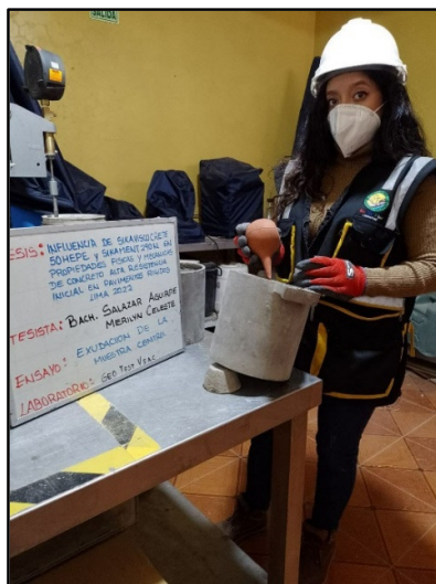
Figura 25: Control de la exudación del concreto convencional, según referencia de la norma NTP 339.077
