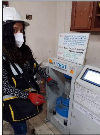
Figura 80: Testigos cilíndricos incorporados los aditivos 0.64% sikaviscocrete 50 HEPE y 0.57% sikament 290N para la resistencia la resistencia a la compresión de los 3 días de edad, según referencia de la norma NTP 339.034 / ASTM C39.
