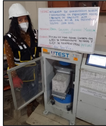
Figura 114: Testigos cilíndricos incorporados los aditivos 0.88% sikaviscocrete 50 HEPE y 0.72% sikament 290N para la resistencia la resistencia a la flexión de los 7 días de edad, según referencia de la norma NTP 339.034 / ASTM C39.
