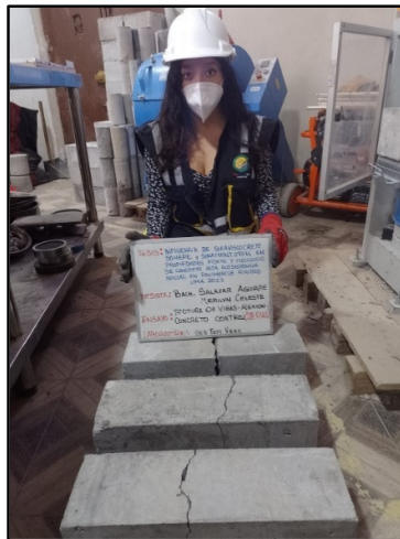
Figura 101: Testigos verticales convencionales para la resistencia a la flexión a los 28 días de edad, según referencia de la norma NTP 339.034 / ASTM C39.
