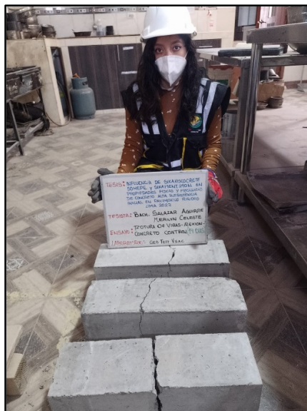
Figura 99: Testigos verticales convencionales para la resistencia a la flexión a los 14 días de edad, según referencia de la norma NTP 339.034 / ASTM C39.
