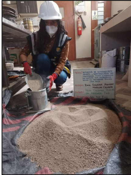
Figura 14: Determinación del Peso Unitario Suelto y el porcentaje de los vacíos del agregado fino, según la norma NTP 400.017.
