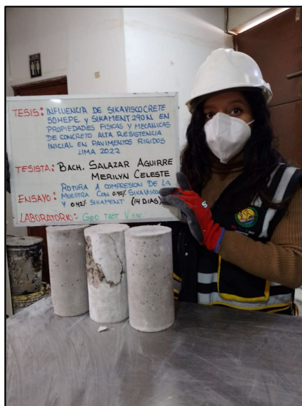
Figura 77: Testigos cilíndricos incorporados los aditivos 0.40% sikaviscocrete 50 HEPE y 0.42% sikament 290N para la resistencia a la compresión de los 14 días de edad, según referencia de la norma NTP 339.034 / ASTM C39.
