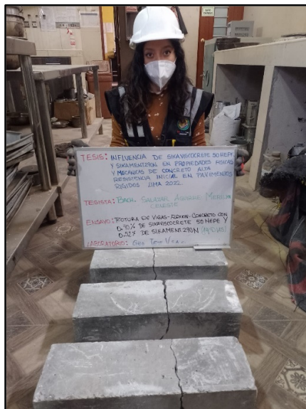
Figura 105: Testigos cilíndricos incorporados los aditivos 0.40% sikaviscocrete 50 HEPE y 0.42% sikament 290N para la resistencia la resistencia a la flexión de los 14 días de edad, según referencia de la norma NTP 339.034 / ASTM C39.
