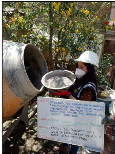
Figura 28: Vista de materiales tales como el cemento para la elaboración del concreto con 0.40% de viscocrete 50 HEPE y 0.42% sikament 290N, según referencia de la norma NTP 339.183.
