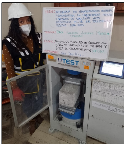
Figura 116: Testigos cilíndricos incorporados los aditivos 0.88% sikaviscocrete 50 HEPE y 0.72% sikament 290N para la resistencia la resistencia a la flexión de los 14 días de edad, según referencia de la norma NTP 339.034 / ASTM C39.
