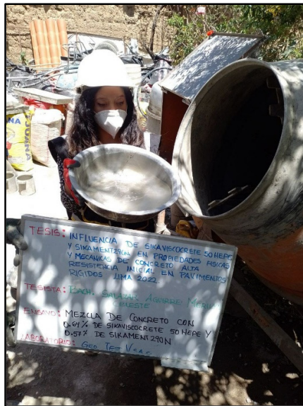
Figura 43: Vista de materiales tales como el agua para la elaboración del concreto con 0.64% de viscocrete 50 HEPE y 0.57% sikament 290N, según referencia de la norma NTP 339.183.
