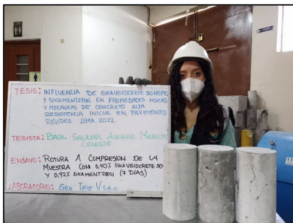
Figura 75: Testigos cilíndricos incorporados los aditivos 0.40% sikaviscocrete 50 HEPE y 0.42% sikament 290N para la resistencia la resistencia a la compresión de los 7 días de edad, según referencia de la norma NTP 339.034 / ASTM C39.
