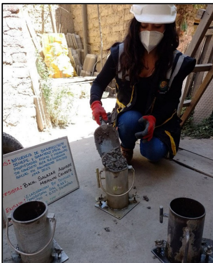
Figura 62: Elaboración de testigos cilíndricos con adición de los aditivos 0.88% de viscocrete 50 HEPE y 0.72% sikament 290N, según referencia de la norma NTP 339.034 / ASTM C39.
