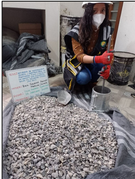
Figura 15: Determinación del Peso Unitario Compactado y el porcentaje de los vacíos del agregado grueso, según la norma NTP 400.017.
