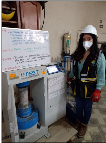
Figura 90: Testigos cilíndricos incorporados los aditivos 0.88% sikaviscocrete 50 HEPE y 0.72% sikament 290N para la resistencia la resistencia a la compresión de los 7 días de edad, según referencia de la norma NTP 339.034 / ASTM C39.
