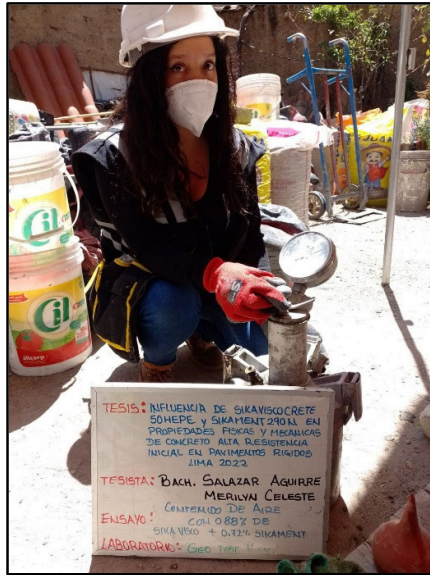
Figura 60: Control del contenido del aire del concreto fresco con adición de los aditivos 0.88% de viscoscrete 50 HEPE y 0.72% sikament 290N, según referencia de la norma NTP 339.083.
