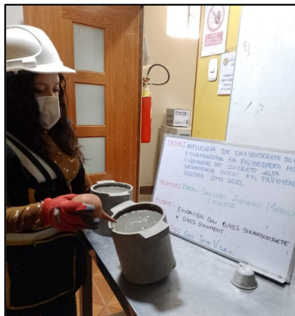
Figura 37: Control de la exudación del concreto con adición de los aditivos 0.40% de viscocrete 50 HEPE y 0.42% sikament 290N, según referencia de la norma NTP 339.077.
