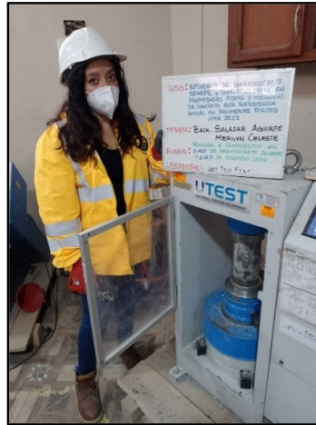
Figura 78: Testigos cilíndricos incorporados los aditivos 0.40% sikaviscocrete 50 HEPE y 0.42% sikament 290N para la resistencia la resistencia a la compresión de los 28 días de edad, según referencia de la norma NTP 339.034 / ASTM C39.
