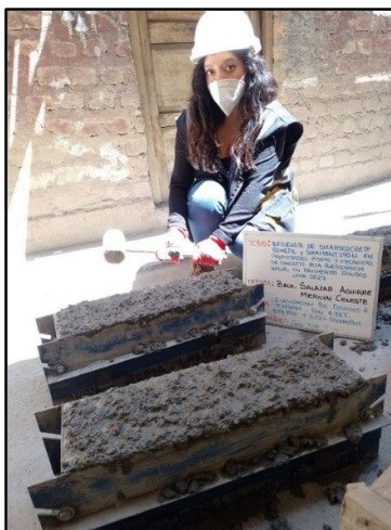
Figura 63: Elaboración de vigas con adición de los aditivos 0.88% de viscocrete 50 HEPE y 0.72% sikament 290N, según referencia de la norma NTP 339.034 / ASTM C39.
