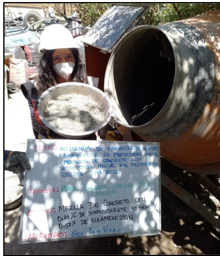
Figura 40: Vista de materiales tales como el cemento para la elaboración del concreto con 0.64% de viscocrete 50 HEPE y 0.57% sikament 290N, según referencia de la norma NTP 339.183.
