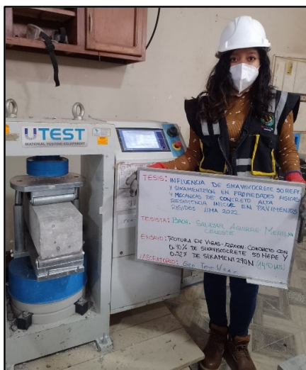
Figura 113: Testigos cilíndricos incorporados los aditivos 0.64% sikaviscocrete 50 HEPE y 0.57% sikament 290N para la resistencia la resistencia a la flexión de los 28 días de edad, según referencia de la norma NTP 339.034 / ASTM C39.
