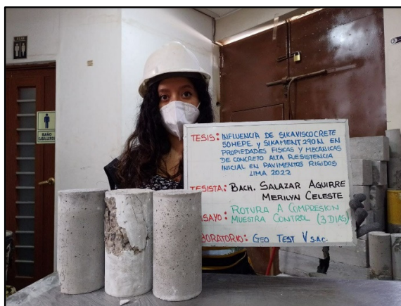
Figura 65: Testigos cilíndricos convencional para la resistencia la resistencia a la compresión de los 3 días de edad, según referencia de la norma NTP 339.034 / ASTM C39
