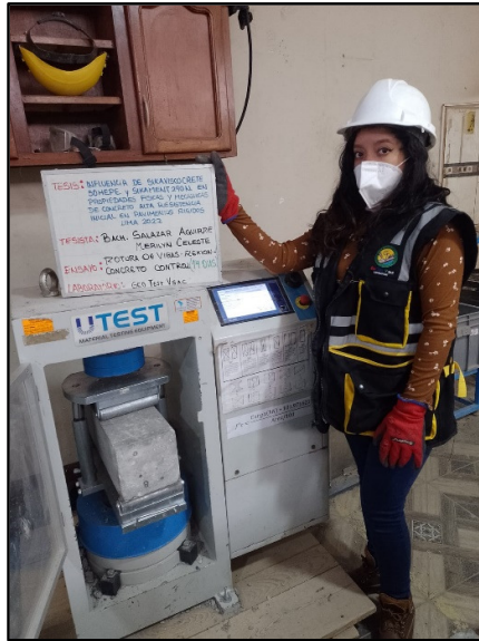
Figura 98: Testigos verticales convencionales para la resistencia a la flexión a los 14 días de edad, según referencia de la norma NTP 339.034 / ASTM C39.
