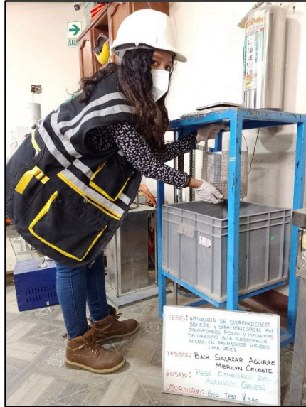
Figura 12: Peso del agregado sumergido en la canastilla normalizado, con la temperatura del agua de 23°C, según referencia de la norma NTP 400.022.
