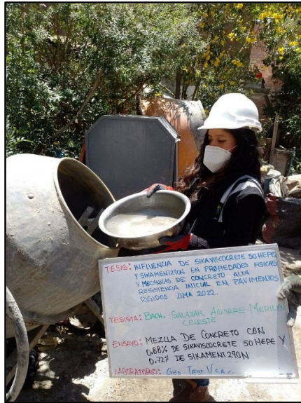
Figura 56: Vista de materiales tales como el agua para la elaboración del concreto con 0.88% de viscocrete 50 HEPE y 0.72% sikament 290N, según referencia de la norma NTP 339.183.
