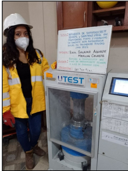
Figura 86: Testigos cilíndricos incorporados los aditivos 0.64% sikaviscocrete 50 HEPE y 0.57% sikament 290N para la resistencia la resistencia a la compresión de los 28 días de edad, según referencia de la norma NTP 339.034 / ASTM C39.
