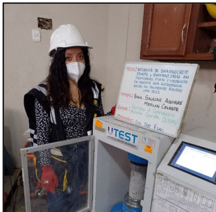
Figura 64: Testigos cilíndricos convencional para la resistencia la resistencia a la compresión de los 3 días de edad, según referencia de la norma NTP 339.034 / ASTM C39
