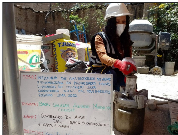
Figura 35: Control del contenido del aire del concreto fresco con adición de los aditivos 0.40% de visocrete 50 HEPE y 0.42% sikament 290N, según referencia de la norma NTP 339.083.
