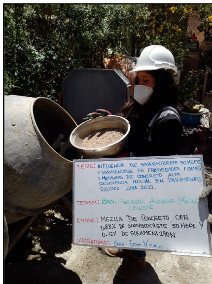
Figura 55: Vista de materiales tales como el agregado fino para la elaboración del concreto con 0.88% de viscocrete 50 HEPE y 0.72% sikament 290N, según referencia de la norma NTP 339.183.
