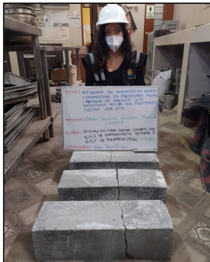
Figura 103: Testigos cilíndricos incorporados los aditivos 0.40% sikaviscocrete 50 HEPE y 0.42% sikament 290N para la resistencia la resistencia a la flexión de los 7 días de edad, según referencia de la norma NTP 339.034 / ASTM C39.
