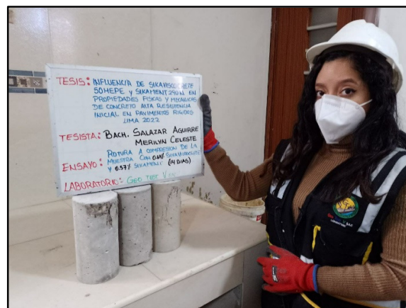
Figura 85: Testigos cilíndricos incorporados los aditivos 0.64% sikaviscocrete 50 HEPE y 0.57% sikament 290N para la resistencia a la resistencia a la compresión de los 14 días de edad, según referencia de la norma NTP 339.034 / ASTM C39.
