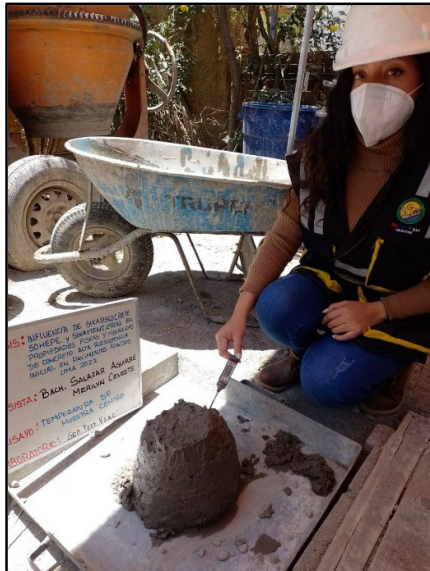
Figura 21: Medición de la temperatura del concreto convencional saliendo de la mezcladora, según la norma NTP 339.184.
