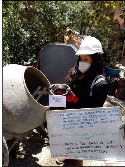
Figura 58: Vista particular del 0.88% de viscocrete 50 HEPE y 0.72% sikament 290N, según referencia de la norma NTP 339.183.
