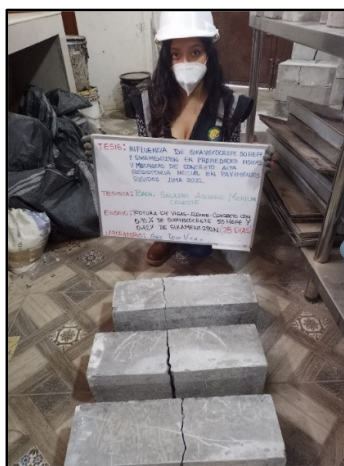
Figura 107: Testigos cilíndricos incorporados los aditivos 0.40% sikaviscocrete 50 HEPE y 0.42% sikament 290N para la resistencia la resistencia a la flexión de los 28 días de edad, según referencia de la norma NTP 339.034 / ASTM C39.
