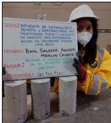
Figura 71: Testigos cilíndricos convencional para la resistencia la resistencia a la compresión de los 28 días de edad, según referencia de la norma NTP 339.034 / ASTM C39.
