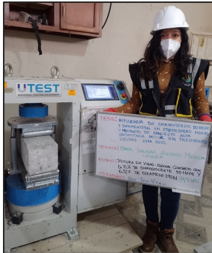
Figura 104: Testigos cilíndricos incorporados los aditivos 0.40% sikaviscocrete 50 HEPE y 0.42% sikament 290N para la resistencia la resistencia a la flexión de los 14 días de edad, según referencia de la norma NTP 339.034 / ASTM C39.
