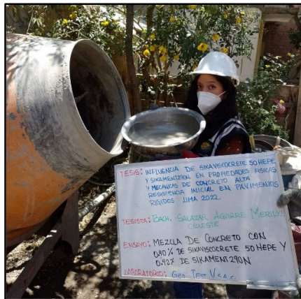
Figura 31: Vista de materiales tales como el agua para la elaboración del concreto con 0.40% de viscocrete 50 HEPE y 0.42% sikament 290N, según referencia de la norma NTP 339.183.
