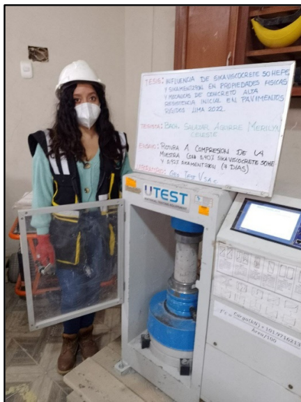
Figura 74: Testigos cilíndricos incorporados los aditivos 0.40% sikaviscocrete 50 HEPE y 0.42% sikament 290N para la resistencia la resistencia a la compresión de los 7 días de edad, según referencia de la norma NTP 339.034 / ASTM C39.
