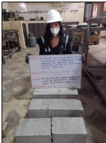
Figura 109: Testigos cilíndricos incorporados los aditivos 0.64% sikaviscocrete 50 HEPE y 0.57% sikament 290N para la resistencia la resistencia a la flexión de los 7 días de edad, según referencia de la norma NTP 339.034 / ASTM C39.
