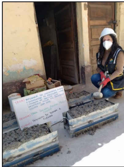
Figura 27: Elaboración de testigos rectangulares convencionales para sus respectivos tipos de ensayos, según referencia de la normal NTP 339.034 / ASTM C39.
