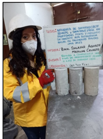
Figura 87: Testigos cilíndricos incorporados los aditivos 0.64% sikaviscocrete 50 HEPE y 0.57% sikament 290N para la resistencia la resistencia a la compresión de los 28 días de edad, según referencia de la norma NTP 339.034 / ASTM C39.
