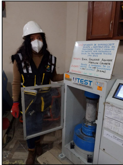
Figura 92: Testigos cilíndricos incorporados los aditivos 0.88% sikaviscocrete 50 HEPE y 0.72% sikament 290N para la resistencia la resistencia a la compresión de los 14 días de edad, según referencia de la norma NTP 339.034 / ASTM C39.
