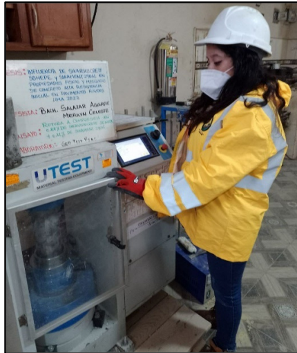
Figura 94: Testigos cilíndricos incorporados los aditivos 0.88% sikaviscocrete 50 HEPE y 0.72% sikament 290N para la resistencia a la compresión de los 28 días de edad, según referencia de la norma NTP 339.034 / ASTM C39.
