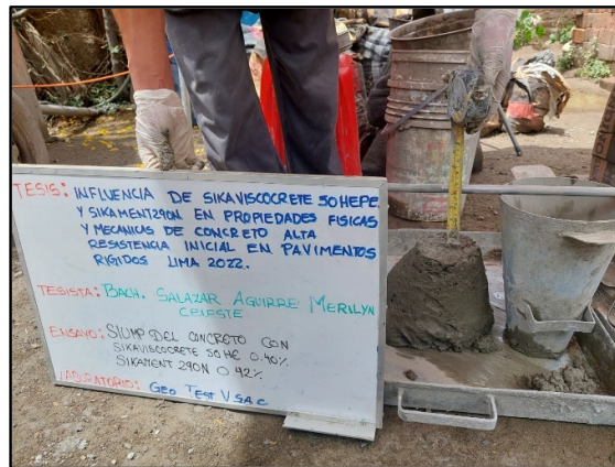
Figura 34: Medición del asentamiento del concreto con adición de los aditivos 0.40% de visocrete 50 HEPE y 0.42% sikament 290N, según referencia de la norma NTP 339.035.
