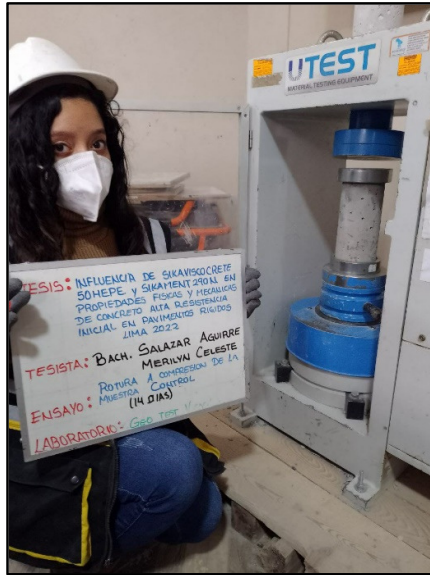
Figura 68: Testigos cilíndricos convencional para la resistencia la resistencia a la compresión de los 14 días de edad, según referencia de la norma NTP 339.034 / ASTM
