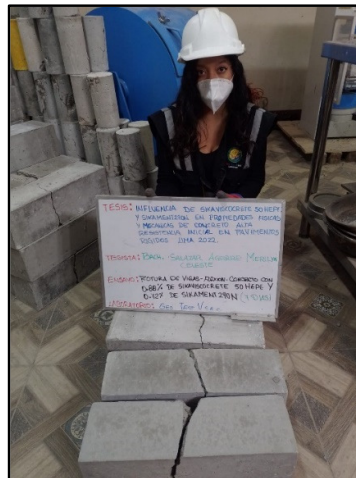
Figura 115: Testigos cilíndricos incorporados los aditivos 0.88% sikaviscocrete 50 HEPE y 0.72% sikament 290N para la resistencia la resistencia a la flexión de los 7 días de edad, según referencia de la norma NTP 339.034 / ASTM C39.
