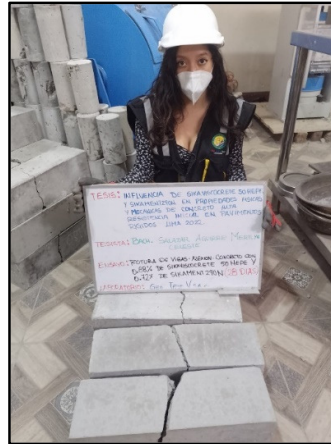
Figura 119: Testigos cilíndricos incorporados los aditivos 0.88% sikaviscoresete 50 HEPE y 0.72% sikament 290N para la resistencia a la flexión de los 28 días de edad, según referencia de la norma NTP 339.034 / ASTM C39.
