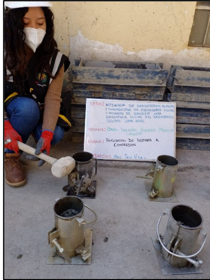
Figura 26: Elaboración de testigos cilíndricos convencionales para sus respectivos tipos de ensayos, según referencia de la normal NTP 339.034 / ASTM C39.
