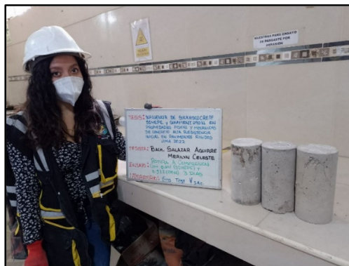
Figura 81: Testigos cilíndricos incorporados los aditivos 0.64% sikaviscocrete 50 HEPE y 0.57% sikament 290N para la resistencia la resistencia a la compresión de los 3 días de edad, según referencia de la norma NTP 339.034 / ASTM C39.
