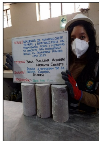
Figura 69: Testigos cilíndricos convencional para la resistencia la resistencia a la compresión de los 14 días de edad, según referencia de la norma NTP 339.034 / ASTM
