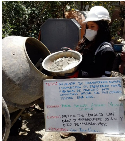
Figura 53: Vista de materiales tales como el cemento para la elaboración del concreto con 0.88% de viscocrete 50 HEPE y 0.72% sikament 290N, según referencia de la norma NTP 339.183.
