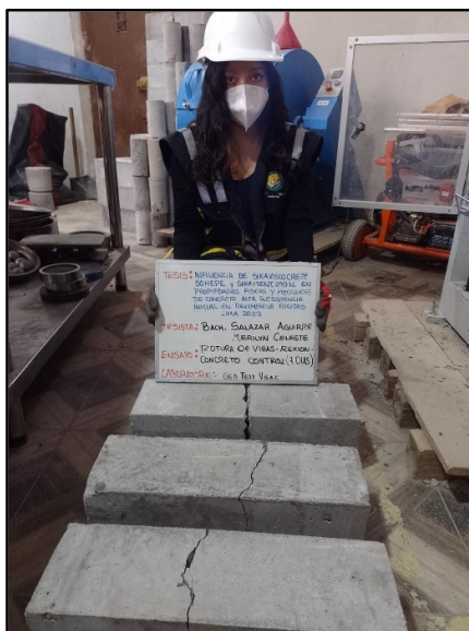
Figura 97: Testigos verticales convencionales para la resistencia a la flexión a los 7 días de edad, según referencia de la norma NTP 339.034 / ASTM C39.
