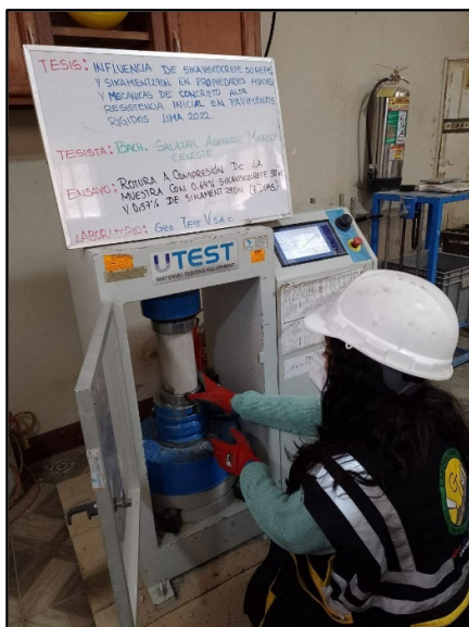
Figura 82: Testigos cilíndricos incorporados los aditivos 0.64% sikaviscocrete 50 HEPE y 0.57% sikament 290N para la resistencia la resistencia a la compresión de los 7 días de edad, según referencia de la norma NTP 339.034 / ASTM C39.
