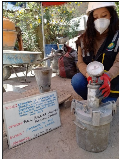
Figura 23: Control del contenido de aire del concreto fresco convencional por el método de presión, según la NTP 339.083.
