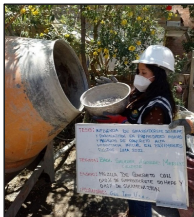
Figura 29: Vista de materiales tales como el agregado grueso para la elaboración del concreto con 0.40% de viscocrete 50 HEPE y 0.42% sikament 290N, según referencia de la norma NTP 339.183.
