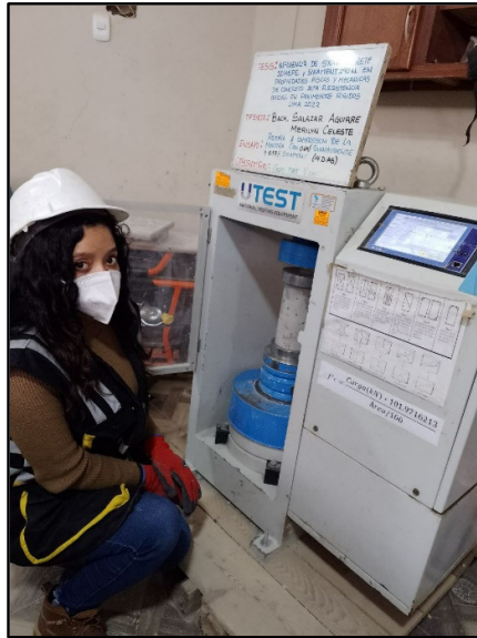
Figura 84: Testigos cilíndricos incorporados los aditivos 0.64% sikaviscocrete 50 HEPE y 0.57% sikament 290N para la resistencia a la resistencia a la compresión de los 14 días de edad, según referencia de la norma NTP 339.034 / ASTM C39.
