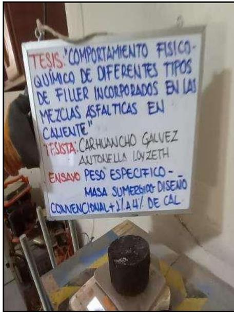
**Fotografía N° 61:** Masa de especímenes de diseño convencional añadiendo 1.00%, 2.00%, 3.00% y 4.00% de cal en estado saturado superficialmente seco, según la referencia de la norma (ASTM D 1188-07).
