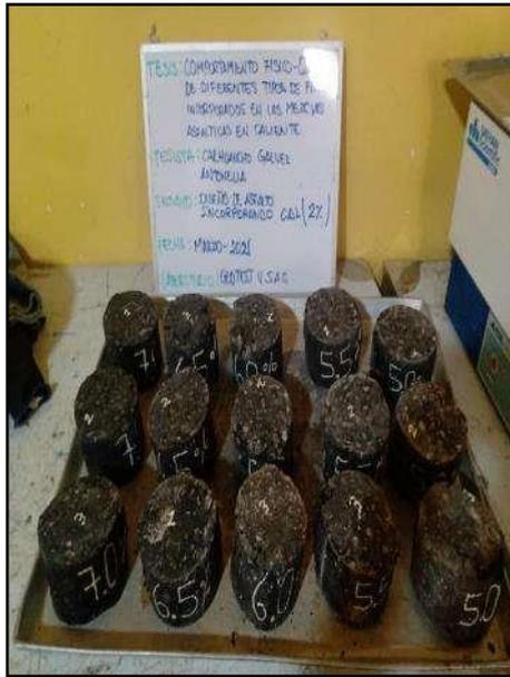
**Fotografía N° 67:** Especímenes ensayadas en equipo de rotura Marshall, datos requeridos estabilidad y flujo, según referencia de la norma (ASTM D 6926 -20).
