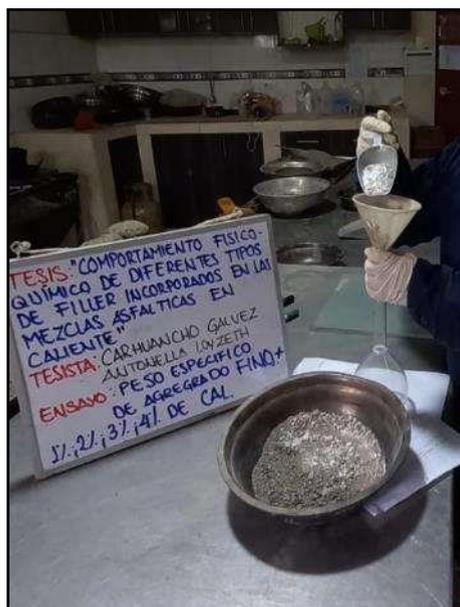
**Fotografía N° 35:** Eliminación de vacíos de aires del material fino con 1.00%, 2.00%, 3.00% y 4.00% de cal, material saturado superficialmente seco, mediante el ensayo de peso específico del agregado fino según referencia de la norma (ASTM C128).
