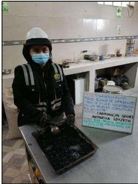
**Fotografía N° 69:** Mezcla asfáltica de diseños convencionales, diseño convencional con 1.00%, 2.00%, 3.00% y 4.00% de cal, diseño convencional con 1.00%, 2.00%, 3.00% y 4.00% de cemento portland, masa del material en temperatura ambiente, según referencia de la norma (ASTM D 2041).
