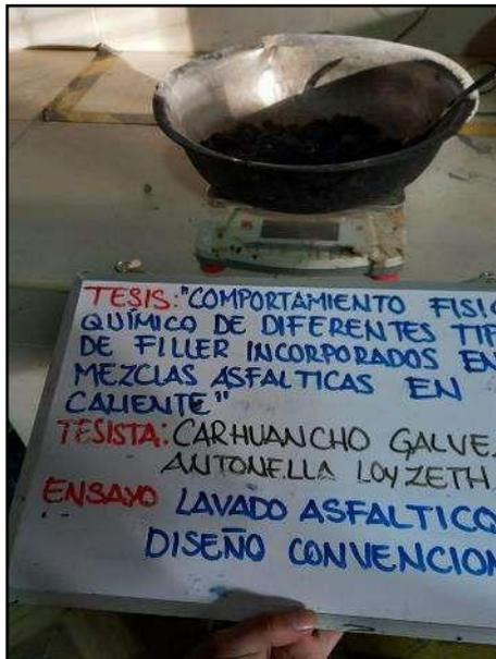
**Fotografía N° 71:** Extracción cuantitativa de asfalto en mezclas en los pavimentos convencional, masa de la mezcla asfáltica para el ensayo, según referencia de la norma (ASTM D 2172).
