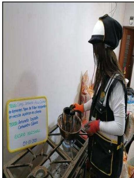
**Fotografía N° 42:** El pen 85/100 a utilizar debe de estar a un rango de temperatura de mezcla recomendada para producir una buena viscosidad, según referencia de la norma (ASTM D 6926 -20).
