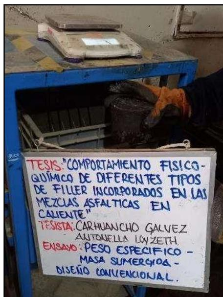
**Fotografía N° 48:** Saturación de especímenes en baño de agua por 10 min a una temperatura de agua 25 °C, seguido se lectura la masa sumergida en agua, según la referencia de la norma (ASTM D 1188-07).
