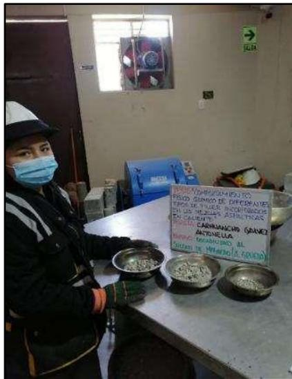
**Fotografía N° 12:** Determinar la resistencia de los agregados a la desintegración por medio de soluciones mediante el ensayo de Durabilidad al sulfato de magnesio, según referencia de la norma (ASTM C 88M-18)
