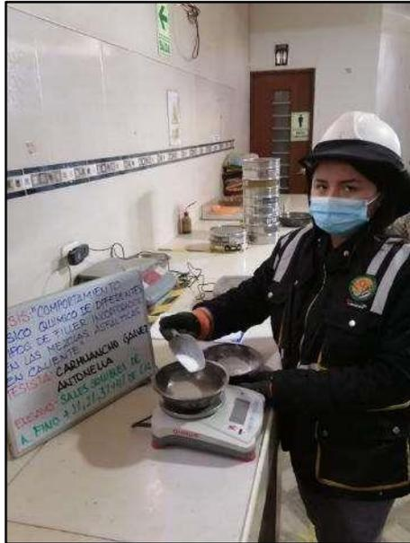
**Fotografía N° 21:** Elaboración del ensayo de sales solubles con el peso del material a ensayar, masa de material fino con 1.00%, 2.00%, 3.00% y 4.00% de cal, según referencia de la norma (ASTM D 1888).
