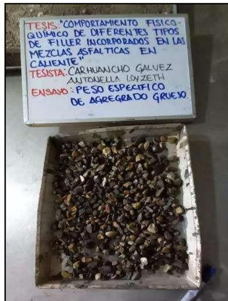
**Fotografía N° 28:** Determinar la densidad de la masa mediante el ensayo del peso específico partículas en un estado saturado superficialmente seco del agregado grueso, según referencia de la norma (ASTM C 127).
