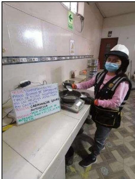
**Fotografía N° 34:** Masa de material fino con 1.00%, 2.00%, 3.00% y 4.00% de cal, material saturado superficialmente seco, mediante el ensayo de peso específico del agregado fino según referencia de la norma (ASTM C128).
