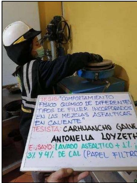
**Fotografía N° 75:** Equipo centrifuga, se vierte el material a ensayar, mezcla asfáltica convencional con 1.00%, 2.00%, 3.00% y 4.00% de cal para extraer el contenido de asfalto que contiene, según referencia de la norma (ASTM D 2172).
