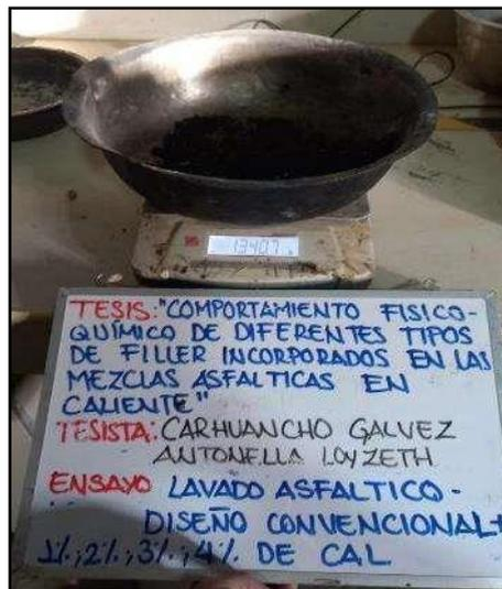
**Fotografía N° 74:** Extracción cuantitativa de asfalto en mezclas en los pavimentos convencional, masa de la mezcla asfáltica con diseño convencional con 1.00%, 2.00%, 3.00% y 4.00% de cal para el ensayo, según referencia de la norma (ASTM D 2172).
