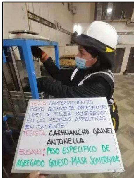
**Fotografía N° 30:** Determinar la densidad de la masa mediante el ensayo del peso específico, masa del material saturado superficialmente seco en canastilla sumergida, según la norma (ASTM C 127).
