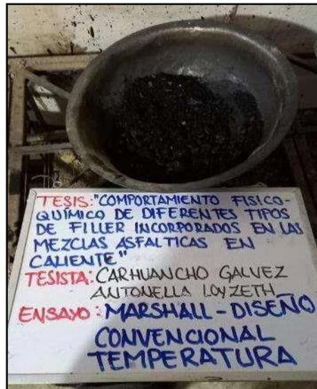
**Fotografía N° 44:** Mezcla del agregado y el cemento asfaltico hasta que todas las partículas del agregado estén revestidas con una temperatura de 140°C, según referencia de la norma (ASTM D 6926 -20).
