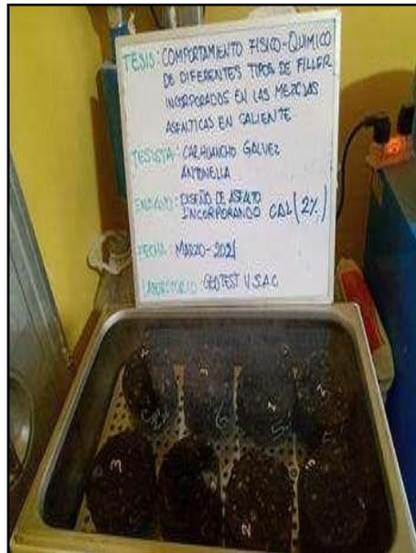
**Fotografía N° 65:** Baño en agua de especímenes de diseño convencional añadiendo el 1.00%, 2.00%, 3.00% y 4.00% de cal y cemento portland a temperatura de 60°C por 40 min para luego ser ensayada en el equipo de rotura Marshall, según referencia de la norma (ASTM D 6926 -20).
