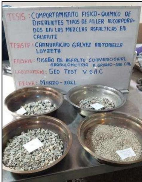
**Fotografía N° 5:** Determinar la clasificación de los materiales propuestos para uso como agregados con la selección de los tamices adecuados para la Granulometría global de agregado, según referencia de la norma (ASTM C 136).
