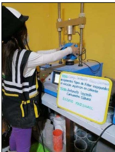
**Fotografía N° 52:** Equipo de rotura Marshall, datos requeridos estabilidad y flujo, según referencia de la norma (ASTM D 6926 -20).
