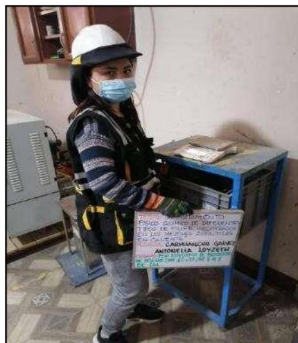
**Fotografía N° 60:** Saturación de especímenes de diseño convencional añadiendo 1.00%, 2.00%, 3.00% y 4.00% de cal, en baño de agua por 10 min a una temperatura de agua 25 °C, seguido se lectura la masa sumergida en agua, según la referencia de la norma (ASTM D 1188-07).
