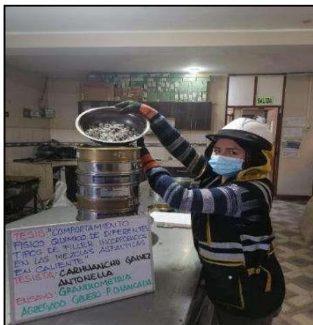
**Fotografía N° 2:** Determinar la clasificación de los materiales propuestos para uso como agregados con la selección de los tamices adecuados para la Granulometría del agregado grueso, según referencia de la norma (ASTM C 136).
