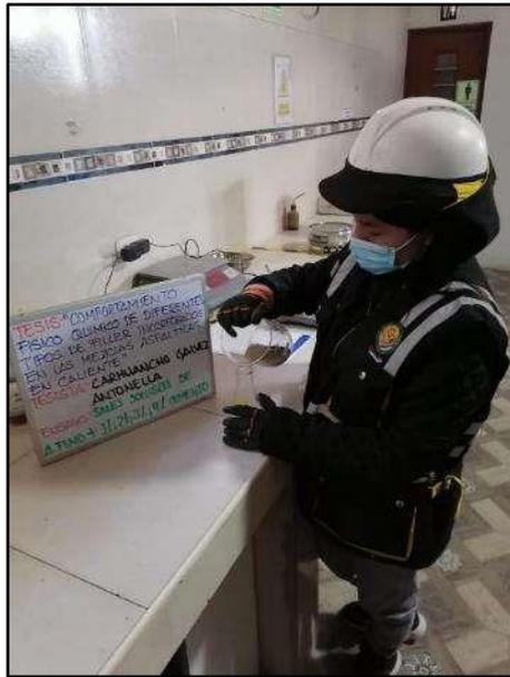
**Fotografía N° 27:** Determinar los cloruros y sulfatos con el ensayo de sales solubles, masa total de sales solubles encontrado en el ensayo, según referencia de la norma (ASTM D 1888).
