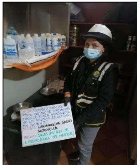
**Fotografía N° 16:** Determinar el contenido de cloruros y sulfatos con el ensayo de sales solubles, peso del Baker, aforo total de agua y el volumen utilizado de agua destilada, según referencia de la norma (ASTM D 1888).
