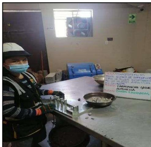
**Fotografía N° 8:** Método de determinación de los porcentajes de partículas chatas en el agregado grueso, según referencia de la norma (ASTM D 4791).
