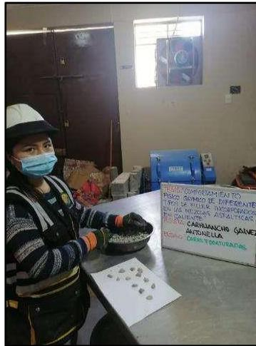
**Fotografía N° 11:** Determinar el porcentaje de masa del agregado grueso con más de una cara fracturada, según referencia de la norma (ASTM D5821).
