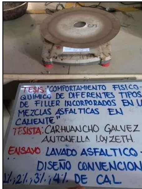
**Fotografía N° 76:** Masa del papel filtro en el ensayo después del ensayo en el equipo centrifuga, según referencia de la norma (ASTM D 2172).
