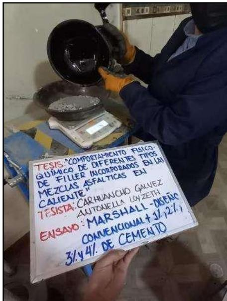
**Fotografía N° 56:** Adicionando PEN 85/100 a agregados para la mezcla asfáltica con adición de 1.00%, 2.00%, 3.00%, 4.00% de cemento portland, hasta un peso constante en un horno a temperatura de 110°C±5°C, con referencia de la norma (ASTM D 6926 - 20).
