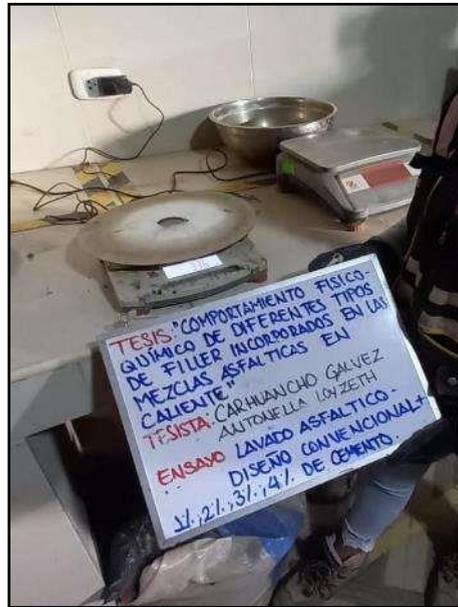
**Fotografía N° 79:** Masa del papel filtro en el ensayo después del ensayo en el equipo centrífuga, según referencia de la norma (ASTM D 2172).
