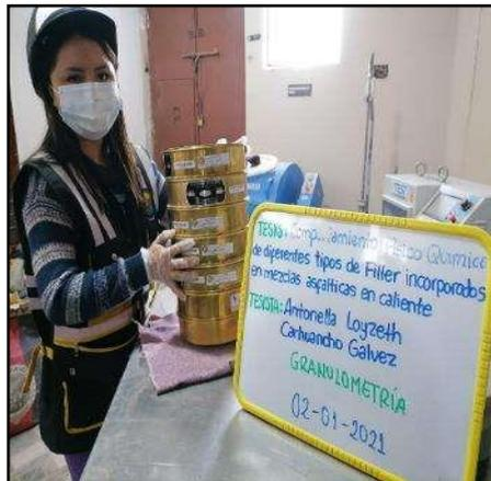
**Fotografía N° 1:** Determinar la clasificación de los materiales propuestos para uso como agregados con la selección de los tamices adecuados para la Granulometría del agregado grueso, según referencia de la norma (ASTM C 136).
