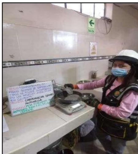
**Fotografía N° 36:** Masa de material fino con 1.00%, 2.00%, 3.00% y 4.00% de cemento portland, material seco, mediante el ensayo de peso específico del agregado fino según referencia de la norma (ASTM C128).
