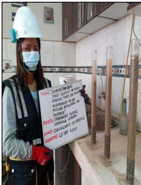
**Fotografía N° 40:** Decantación y lectura de arena y finos, agregado fino con 1.00%, 2.00%, 3.00% y 4.00% de cal y agregado fino con 1.00%, 2.00%, 3.00% y 4.00% de cemento portland, mediante el ensayo de equivalente de arena la hora de saturación y decantación según referencia de la norma (ASTM D 2419).
