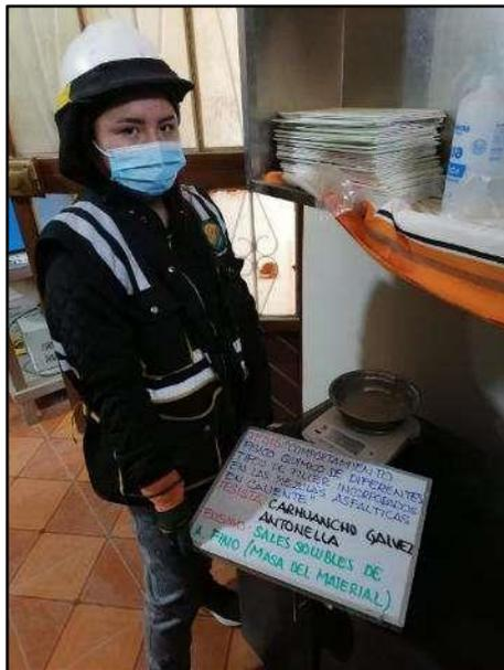
**Fotografía N° 18:** Elaboración del ensayo de sales solubles, masa del material a ensayar, según referencia de la norma (ASTM D 1888).
