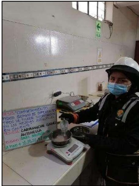
**Fotografía N° 25:** Elaboración del ensayo de sales solubles, masa de material fino con 1.00%, 2.00%, 3.00% y 4.00% de cemento portland, según referencia de la norma (ASTM D 1888).
