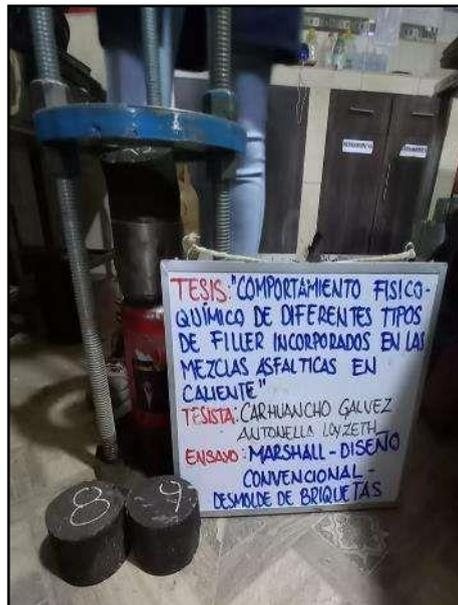
**Fotografía N° 46:** Después de completar la compactación las briquetas esperamos un día para poder desmoldar las briquetas que fueron extraídas de los moldes, según referencia de la norma (ASTM D 6926 -20).
