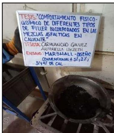
**Fotografía N° 54:** Mezcla asfáltica con adición de 1.00%, 2.00%, 3.00%, 4.00% de cal, a temperatura de  $140^{\circ}\text{C}$ , según con referencia de la norma (ASTM D 6926 -20).
