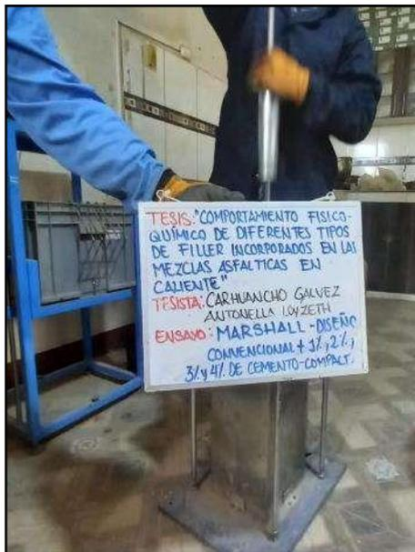
**Fotografía N° 58:** Compactación a 75 golpes por ambos extremos de la mezcla asfáltica con adición de 1.00%, 2.00%, 3.00%, 4.00% de cemento portland, a temperatura de 140 °C, según con referencia de la norma (ASTM D 6926 -20).
