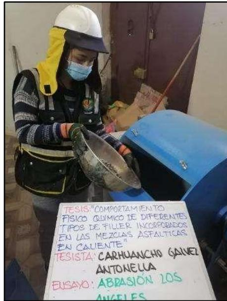
**Fotografía N° 7:** Determinar la resistencia a la degradación por el método “B” utilizando 11 esferas con la máquina de los ángeles mediante el ensayo de abrasión los ángeles, según referencia de la norma (ASTM C 131).
