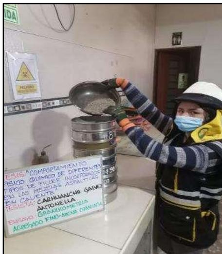
**Fotografía N° 3:** Determinar la clasificación de los materiales propuestos para uso como agregados con la selección de los tamices adecuados para la Granulometría del agregado fino (arena triturada) según referencia de la norma (ASTM C 136).
