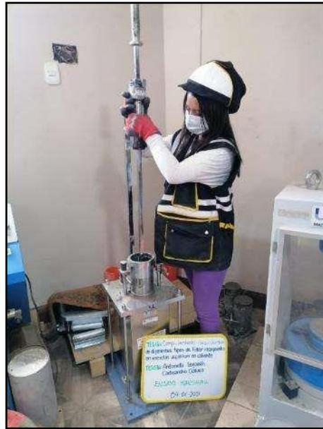
**Fotografía N° 45:** Compactación del espécimen convencional, por cara 75 golpes, según referencia de la norma (ASTM D 6926 -20).
