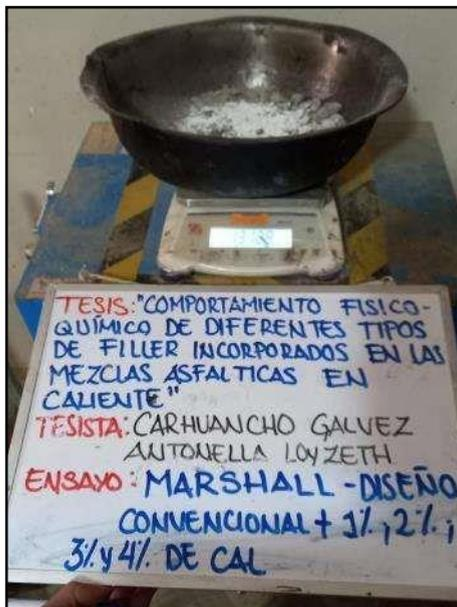
**Fotografía N° 53:** Preparación del agregado para la mezcla asfáltica con adición de 1.00%, 2.00%, 3.00%, 4.00% de cal, hasta un peso constante en un horno a temperatura de  $110^{\circ}\text{C} \pm 5^{\circ}\text{C}$ , con referencia de la norma (ASTM D 6926 -20).
