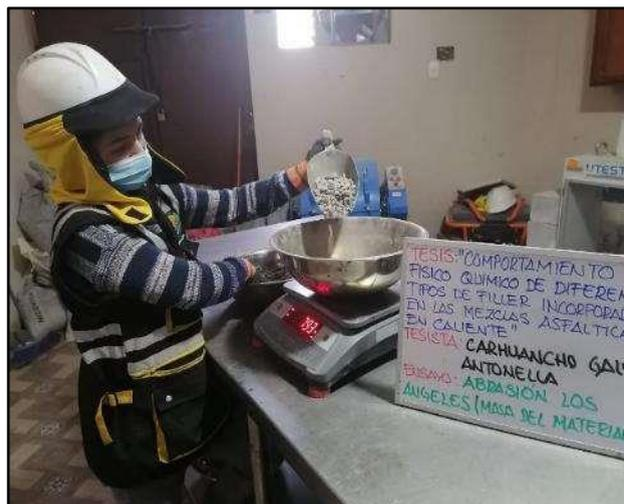
**Fotografía N° 6:** Determinar la resistencia a la degradación por el método “B” utilizando 11 esferas con la máquina de los ángeles mediante el ensayo de abrasión los ángeles, según referencia de la norma (ASTM C 131)
