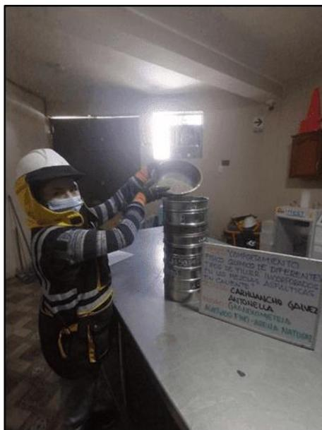
**Fotografía N° 4:** Determinar la clasificación de los materiales propuestos para uso como agregados con la selección de los tamices adecuados para la Granulometría del agregado fino según referencia de la norma (ASTM C 136).
