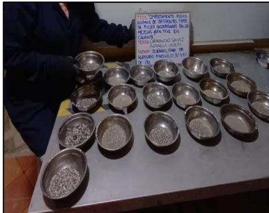
**Fotografía N° 14:** Determinar la resistencia de los agregados a la desintegración por medio de soluciones mediante el ensayo de Durabilidad al sulfato de magnesio, agregado fino con 1.00%, 2.00%, 3.00% y 4.00% de cal, según referencia de la norma (ASTM C 88M-18).
