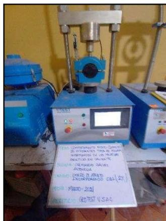
**Fotografía N° 66:** Equipo de rotura Marshall, datos requeridos estabilidad y flujo, según referencia de la norma (ASTM D 6926 -20).
