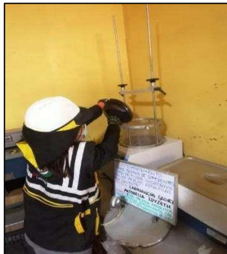
**Fotografía N° 70:** Equipo de picnómetro de vacíos, por 15 min la mezcla asfáltica de diseños convencionales, diseño convencional con 1.00%, 2.00%, 3.00% y 4.00% de cal, diseño convencional con 1.00%, 2.00%, 3.00% y 4.00% de cemento portland es sometida para desaparecer el vacío de aire que contiene el material para luego ser llevado y pesado con el frasco, según referencia de la norma (MTC D 2041).
