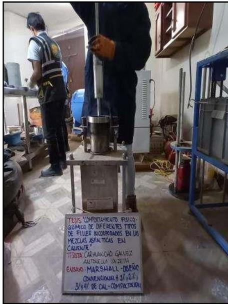
**Fotografía N° 55:** Compactación a 75 golpes por ambos extremos de la mezcla asfáltica con adición de 1.00%, 2.00%, 3.00%, 4.00% de cal, a temperatura de 140 °C, según con referencia de la norma (ASTM D 6926 -20).
