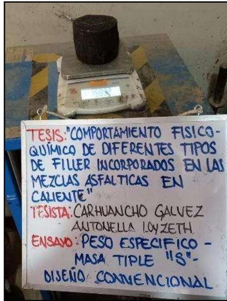
**Fotografía N° 49:** Masa de especímenes en estado saturado superficialmente seco, según la referencia de la norma (ASTM D 1188-07).
