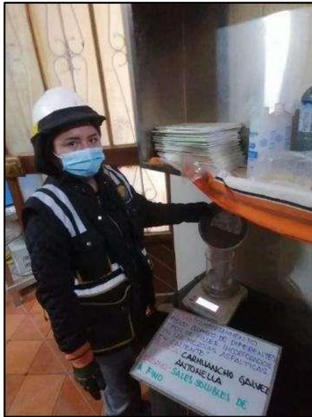
**Fotografía N° 19:** Elaboración del ensayo de sales solubles, muestra del material con agua destilada, según referencia de la norma (ASTM D 1888).
