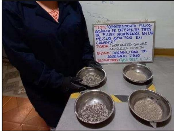
**Fotografía N° 13:** Determinar la resistencia de los agregados a la desintegración por medio de soluciones mediante el ensayo de Durabilidad al sulfato de magnesio, según referencia de la norma (ASTM C 88M-18).
