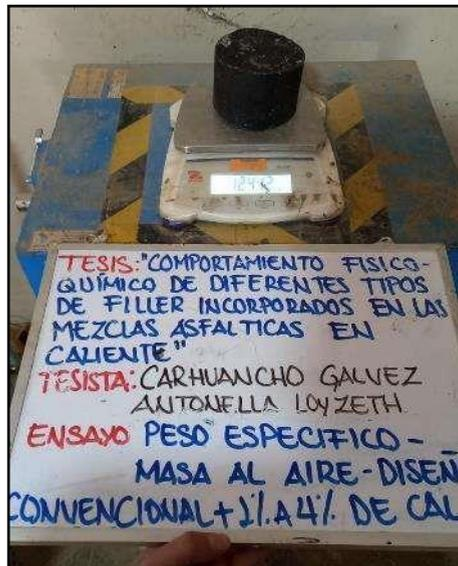
**Fotografía N° 59:** Masa al aire libre de especímenes convencionales con 1.00%, 2.00%, 3.00% y 4.00% de cal, para poder conservar el peso con los vacíos libres, según la referencia de la norma (ASTM D 1188-07).
