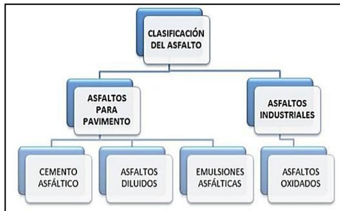
Figura 9. Clases de los asfaltos.
