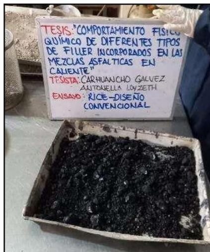
**Fotografía N° 68:** Mezcla asfáltica de diseños convencionales, diseño convencional con 1.00%, 2.00%, 3.00% y 4.00% de cal, diseño convencional con 1.00%, 2.00%, 3.00% y 4.00% de cemento portland, el estado del material debe tener la temperatura ambiente, según referencia de la norma (ASTM D 2041).
