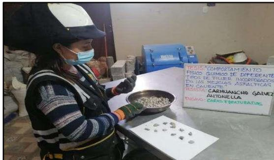
**Fotografía N° 10:** Determinar el porcentaje de masa del agregado grueso con una cara fracturada, según referencia de la norma (ASTM D5821).
