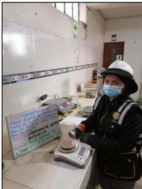
**Fotografía N° 22:** Elaboración del ensayo de sales solubles, masa del material a ensayar más agua destila, según referencia de la norma (ASTM D 1888).
