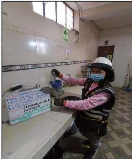
**Fotografía N° 37:** Eliminación de vacíos de aires del material fino con 1.00%, 2.00%, 3.00% y 4.00% de cemento portland, material saturado superficialmente seco, mediante el ensayo de peso específico del agregado fino según referencia de la norma (ASTM C128).
