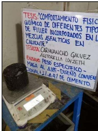
**Fotografía N° 62:** Masa al aire libre de especímenes convencionales con 1.00%, 2.00%, 3.00% y 4.00% de cemento portland, para poder conservar el peso con los vacíos libres, según la referencia de la norma (ASTM D 1188-07).
