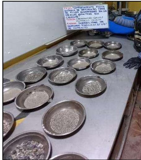
**Fotografía N° 15:** Determinar la resistencia de los agregados a la desintegración por medio de soluciones mediante el ensayo de Durabilidad al sulfato de magnesio, agregado fino con 1.00%, 2.00%, 3.00% y 4.00% de cemento portland, según referencia de la norma (ASTM C 88M-18).
