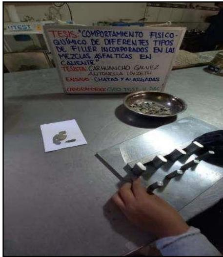
**Fotografía N° 9:** Método de determinación de los porcentajes de partículas alargadas en el agregado grueso, según referencia de la norma (ASTM D 4791)
