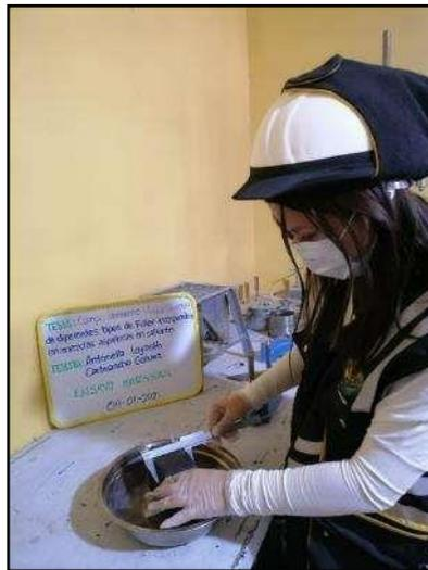
**Fotografía N° 50:** Medición de ancho de especímenes a ser ensayado en el equipo de rotura Marshall para la determinación de estabilidad y flujo, según referencia de la norma (ASTM D 6926 -20).
