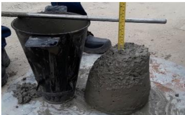
Figura 7 Ensayo de asentamiento o revenimiento según normatividad vigente E0.60/NTP 339.034. Fuente: Elaboración propia.
