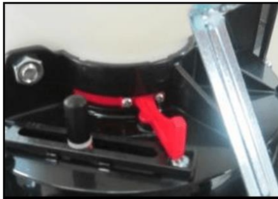
FIGURA 18. Se muestra el sistema del dispensador de abrir/cerrar.
