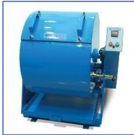
FIGURA 11. Máquina de Abrasión los Ángeles usada para la determinación de la resistencia de los agregados y su fragmentación. Tomada de Máquina de Abrasión Los Ángeles, por (UTEEST, 2023).
