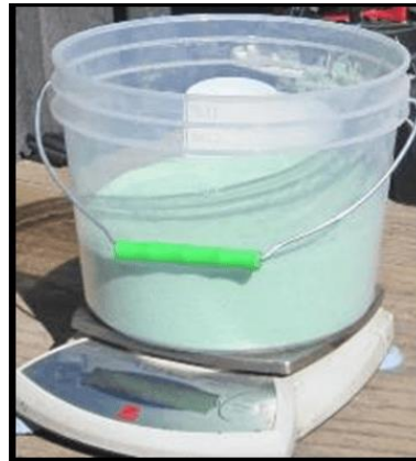
FIGURA 21. Peso del producto polímero megasoil para su posterior mezcla.
