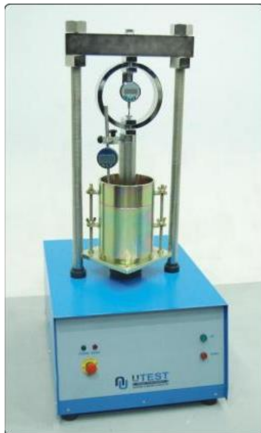
FIGURA 4. Máquina para Ensayos de CBR con Anillo de Carga de 50 kN de Capacidad. Tomada de, máquinas para pruebas de CBR, por (UTEST, 2023).
