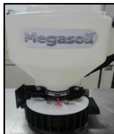
FIGURA 16. Equipo de dispensador, para realizar la mezcla en diferentes dosificaciones con el polímero Megasoil.
