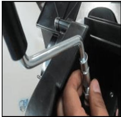
FIGURA 17. Equipo dispensador, se muestra la manecilla para poder realizar una mezcla adecuada.
