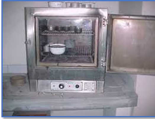
FIGURA 12. Horno de laboratorio elaborado para secar asfalto, suelo, roca, concreto, agregado o materiales similares. Tomado de Horno de laboratorio, por (UTEST, 2023).
