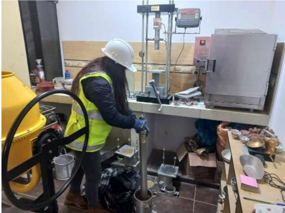
Fotografía 07: Proceso de ensayo de Proctor modificado tipo C, según norma NTP 339.14, ASTM D 1557 y el MTC E 115.
