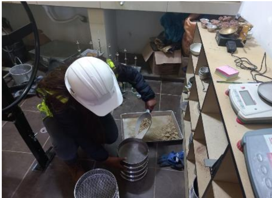
Fotografía 04: La imagen evidencia el proceso de ensayo granulométrico de la muestra obtenida de la cantera B (arena), según norma ASTM D 422.
