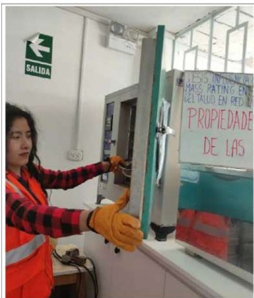
FOTO 03.- ENSAYO DE PROPIEDADES FÍSICAS DE LAS ROCAS, "INFLUENCIA DEL ÍNDICE SLOPE MASS RATING (SMR) EN EL COMPORTAMIENTO DEL TALUD EN RED VIAL VECINAL (JU - 816)"- SECADO DE MUESTRAS EN HORNO
