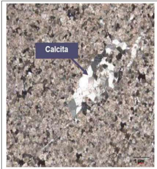
VISTA MICROSCÓPICA 01.- EXAMEN PETROGRÁFICO EN TESIS "APLICACIÓN DE LAS CONDICIONES GEOMECÁNICAS DEL ÍNDICE SLOPE MASS RATING EN LA ESTABILIDAD DEL TALUD CARRETERA PUENTE COLLPA – YANACANCHA": Los cristales de calcita, presentan forma lenticular, subhedrales a anhedrales.
