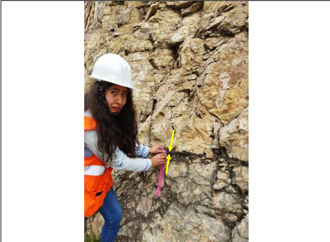
PANEL FOTOGRÁFICO OCTUBRE 2021 FOTOGRAFÍA 28 Distinción y medición de aberturas e identificación del material de relleno: materiales finos suaves mayor a 5 mm, entre discontinuidades con una regla graduada al milímetro en EG 01 .
