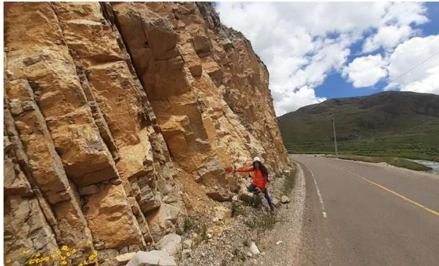
Figura 23. Deslizamiento planar de bloques de roca. Nota: Material a deslizar planos de falla planar compuestos por rocas sedimentaria tipo caliza grainstone. Fuente: Elaboración propia.
