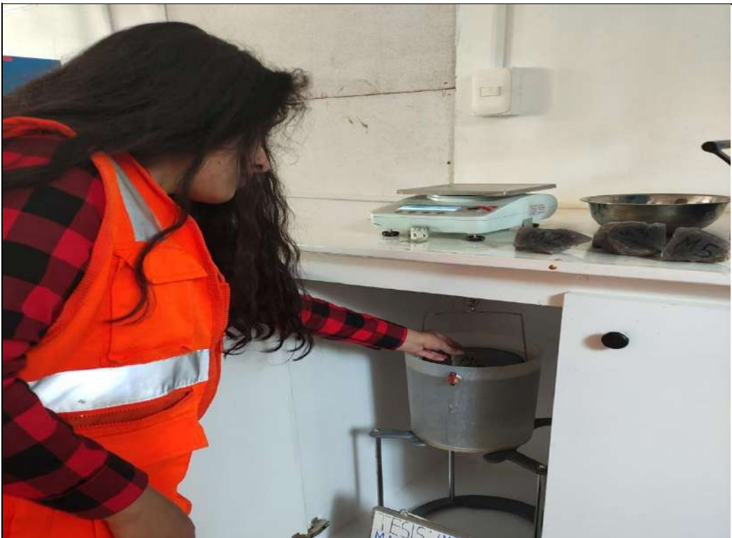
PANEL FOTOGRÁFICO OCTUBRE 2021 FOTOGRAFÍA 16 Registro del peso de los especímenes saturados y sumergidos en agua destilada, para cálculo de la gravedad específica de las rocas según normativa internacional ASTM C97-18.
