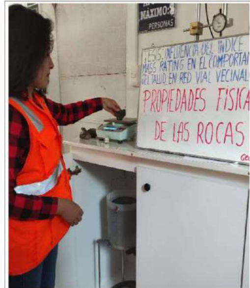
FOTO 02.- ENSAYO DE PROPIEDADES FÍSICAS DE LA ROCA, "INFLUENCIA DEL ÍNDICE SLOPE MASS RATING (SMR) EN EL COMPORTAMIENTO DEL TALUD EN RED VIAL VECINAL (JU - 816)"- PESADO DE MUESTRAS SUPERFICIALMENTE SATURADA
