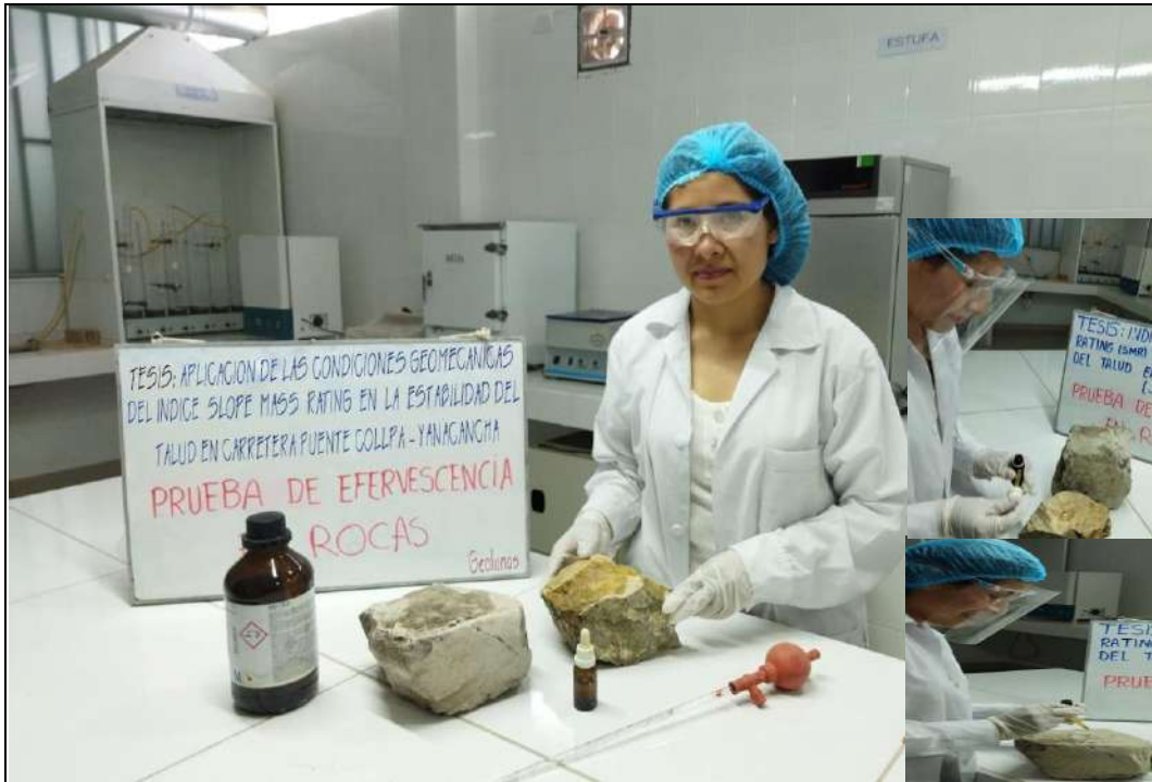
PANEL FOTOGRÁFICO OCTUBRE 2021 FOTOGRAFÍA 37 Prueba en laboratorio de efervescencia en rocas calizas mediante aplicación directa del ácido clorhídrico a los bloques rocosos extraídos del talud en estudio.
