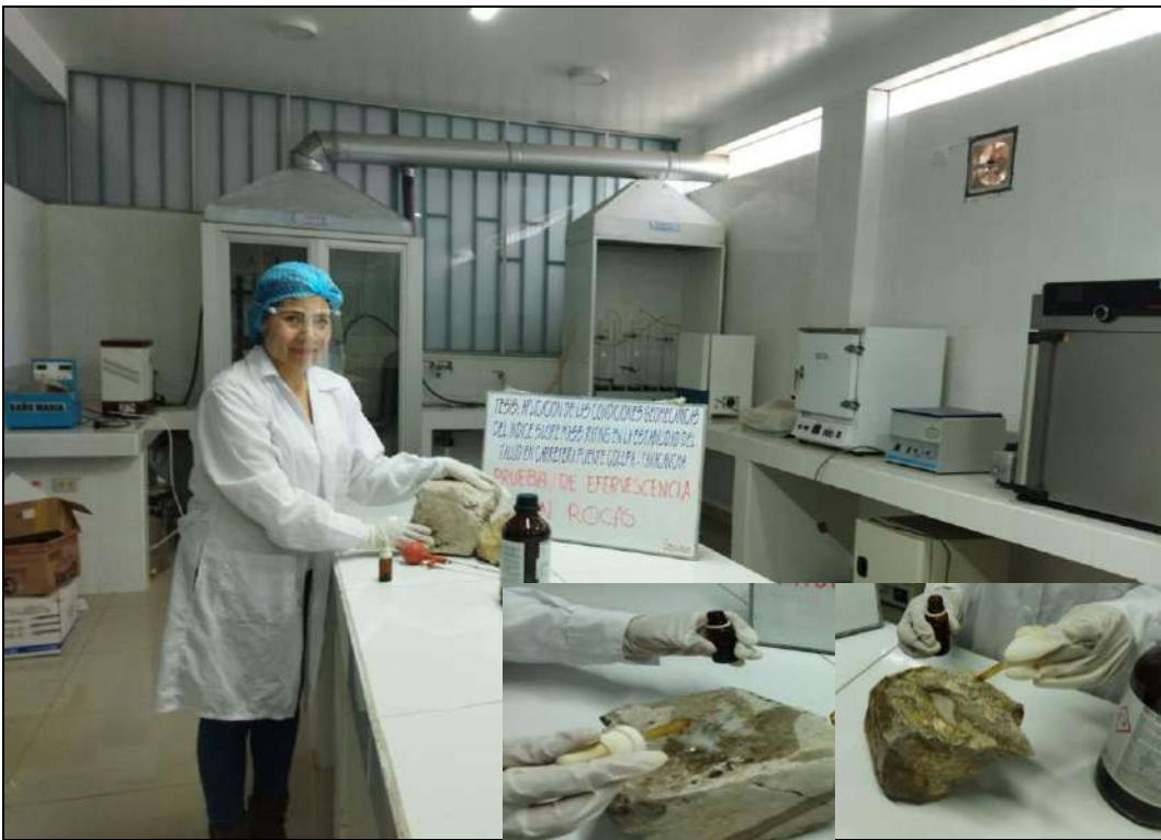
PANEL FOTOGRÁFICO OCTUBRE 2021 FOTOGRAFÍA 36 Prueba en laboratorio de efervescencia en rocas calizas mediante aplicación directa del ácido clorhídrico a los bloques rocosos extraídos del talud en estudio.
