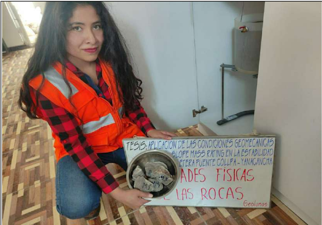
PANEL FOTOGRÁFICO OCTUBRE 2021 FOTOGRAFÍA 12 Especímenes para ensayo de propiedades físicas de roca en laboratorio según norma ASTM C97-18, obtenidas a partir de las muestras de fragmentos rocosos tomados en campo; se aprecian muestras de dimensiones entre 2 cm a 3 cm.
