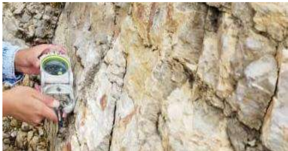
Figura 15. Medición del rumbo en las discontinuidades con brújula. Tomada de «Usos de la brújula en una medición de campo», por Bongiorno, Francisco 2018. P. 6.
