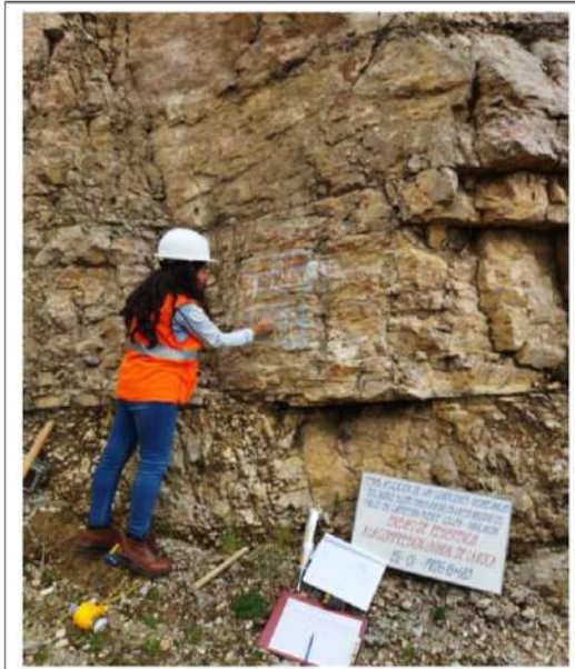
FOTO 01.- ENSAYO DE ESCLEROMETRIA, "APLICACIÓN DE LAS CONDICIONES GEOMECÁNICAS DEL ÍNDICE SLOPE MASS RATING EN LA ESTABILIDAD DEL TALUD CARRETERA PUENTE COLLPA - YANACANCHA"- ESTACIÓN GEOMECÁNICA 01
