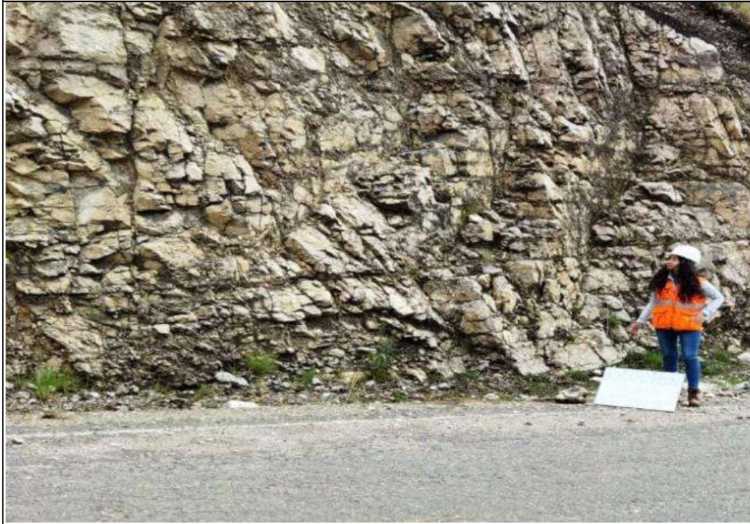
PANEL FOTOGRÁFICO OCTUBRE 2021 FOTOGRAFÍA 31 Identificación de rugosidades en la superficie del talud: Se visualiza la superficie moderadamente rugosa perteneciente a la estación geomecánica EG 03 .
