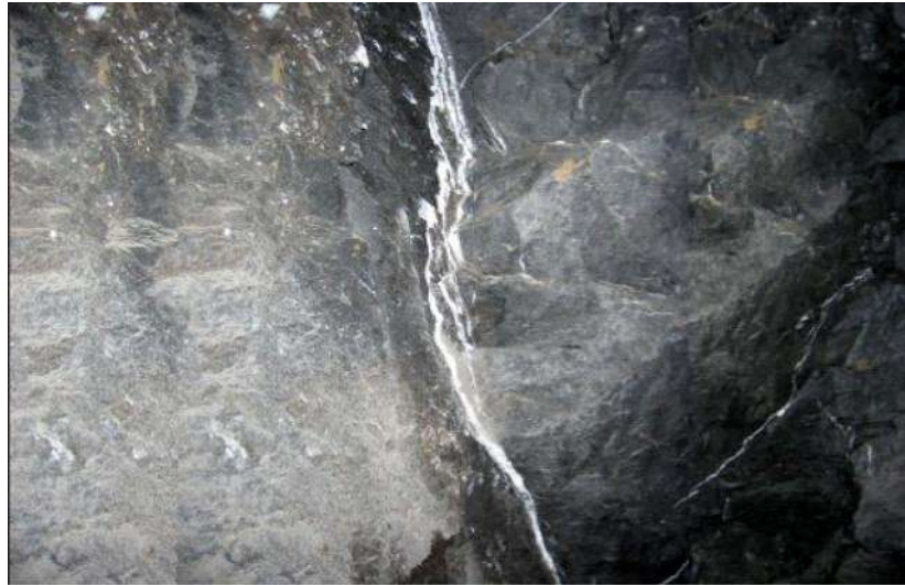
Figura 11. Relleno entre discontinuidades. Tomada de «Curso: geología aplicada Capítulo I: introducción a la mecánica de rocas», por Morales, Wilver, 2014. Diapositiva 57.
