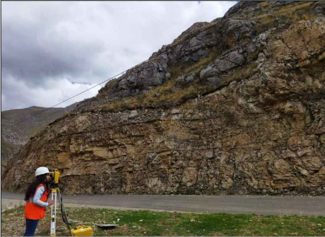
PANEL FOTOGRÁFICO OCTUBRE 2021 FOTOGRAFÍA 07 Visamiento de puntos topográficos con la estación total en el área de estudio, desde el primer cambio de estación.
