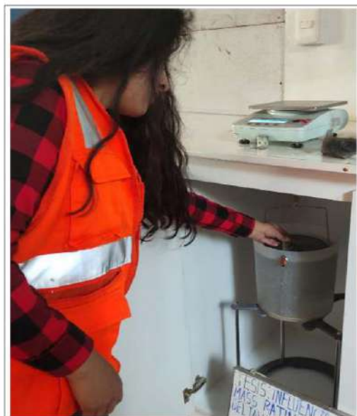
FOTO 04.- ENSAYO DE PROPIEDADES FÍSICAS DE LAS ROCAS, "INFLUENCIA DEL ÍNDICE SLOPE MASS RATING (SMR) EN EL COMPORTAMIENTO DEL TALUD EN RED VIAL VECINAL (JU - 816)"- PESADO DE MUESTRA SATURADA SUMERGIDA
