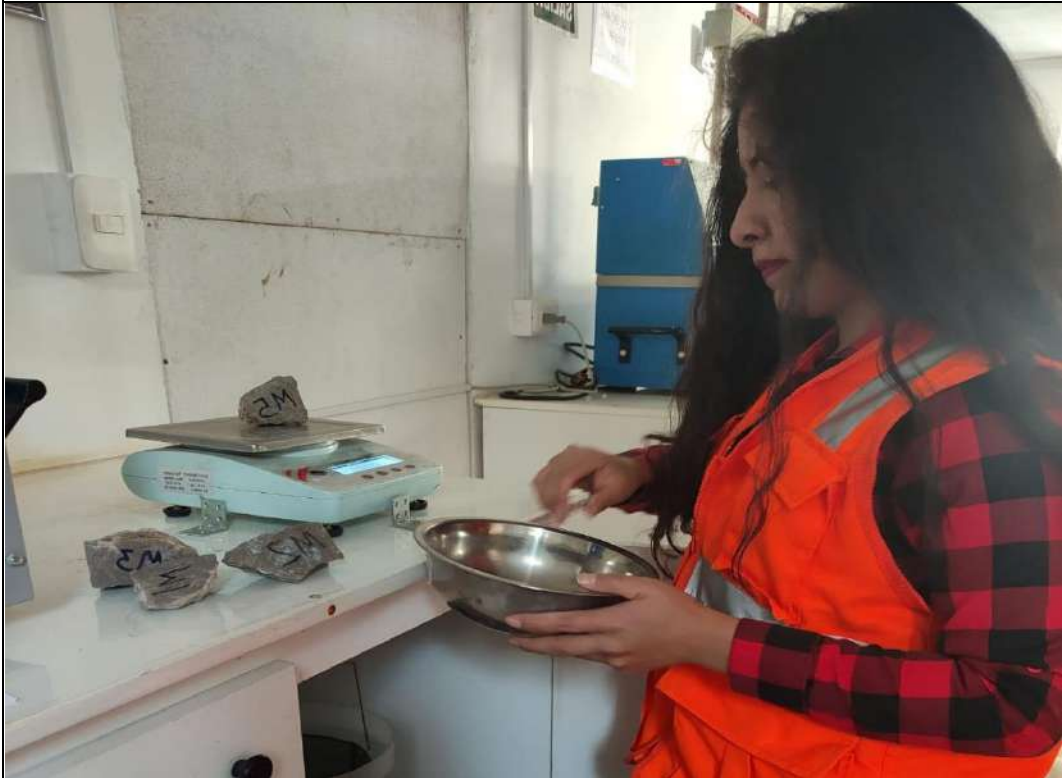
PANEL FOTOGRÁFICO OCTUBRE 2021 FOTOGRAFÍA 15 Registro del peso de los especímenes saturados superficialmente secos, para cálculo de la gravedad específica de las rocas según normativa internacional ASTM C97-18.
