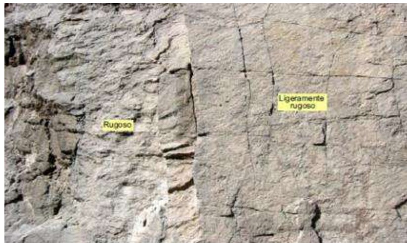
Figura 9. Rugosidad de una superficie de discontinuidad. Tomada de «Curso: geología aplicada Capítulo I: introducción a la mecánica de rocas», por Morales, Wilver, 2014. Diapositiva 55.
