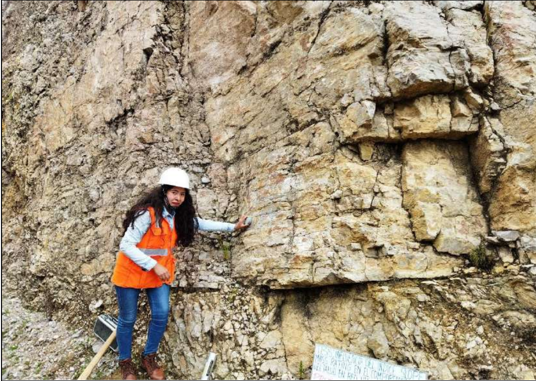
PANEL FOTOGRÁFICO OCTUBRE 2021 FOTOGRAFÍA 17 Ensayo en campo de esclerometría en rocas según normativa internacional ISRM – 2009: Se observa la preparación de la superficie planas y lisas al lijarlas con la piedra abrasiva.
