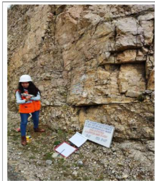
FOTO 03.- ENSAYO DE ESCLEROMETRIA, "APLICACIÓN DE LAS CONDICIONES GEOMECÁNICAS DEL ÍNDICE SLOPE MASS RATING EN LA ESTABILIDAD DEL TALUD CARRETERA PUENTE COLLPA - YANACANCHA"- ESTACIÓN GEOMECÁNICA 03
