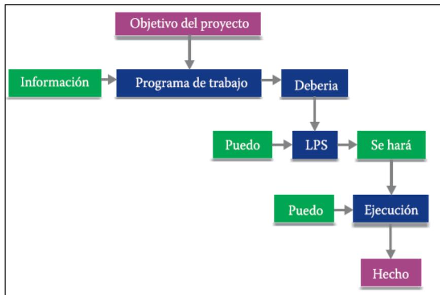
Figura N° 8. Sistema de planificación con el modelo lean
