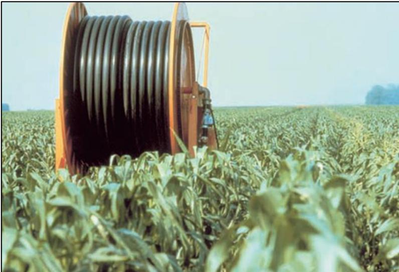
*Figura 8. "Sistema de riego de cañón enrollador"*
