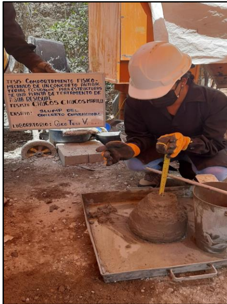
Fotografía 15: Medición del asentamiento del concreto fresco convencional. Según NTP 339.035.
