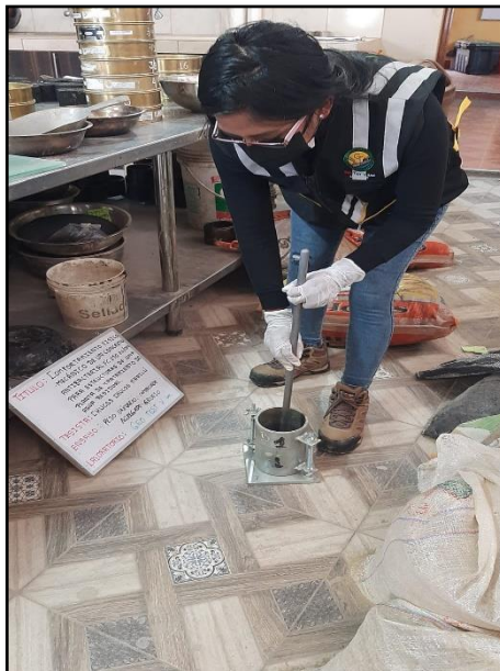
Fotografía 6: Llenar hasta las \frac{3}{4} partes del recipiente para finalmente compactarlo el todo con la varilla, según la NTP 400.017.
