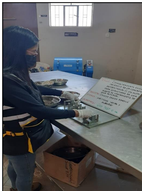
Fotografía 8: Ensayo de partículas chatas: Ajustar la abertura entre el brazo mayor y el poste, al ancho de las partículas. La partícula es chata si su espesor pasa por la abertura menor, según la NTP 400.040.
