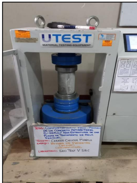
Fotografía 40: Introducción de probetas al equipo de compresión. Según la NTP 339.034 / ASTM C39.
