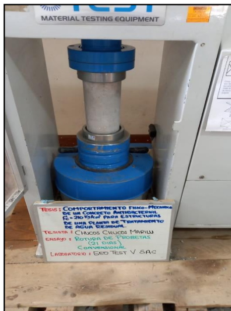
Fotografía 36: Introducción de probetas al equipo de compresión. Según la NTP 339.034 / ASTM C39.
