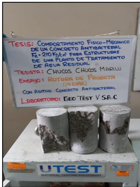
Fotografía 47: Testigos cilíndricos con sus respectivos tipos de fallas. Según la NTP 339.034 / ASTM C39
