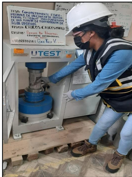
Fotografía 44: Introducción de probetas al equipo de compresión. Según la NTP 339.034 / ASTM C39.
