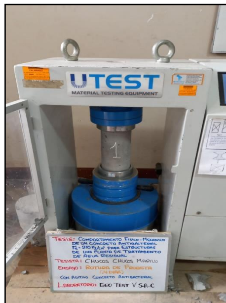
Fotografía 46: Introducción de probetas al equipo de compresión. Según la NTP 339.034 / ASTM C39.
