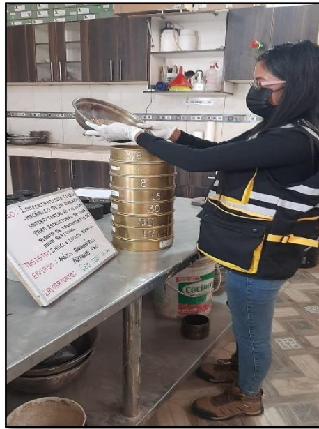
Fotografía 1: Ensayo de granulometría del agregado fino, de acuerdo al módulo de finura (MF) 3.14 de acuerdo a la NTP 400.012.
