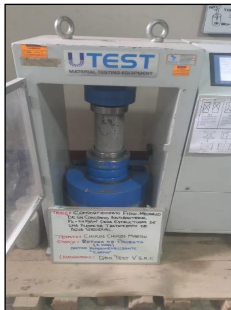
Fotografía 42: Introducción de probetas al equipo de compresión. Según la NTP 339.034 / ASTM C39.
