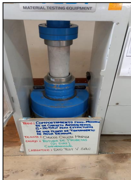
Fotografía 34: Introducción de probetas al equipo de compresión. Según la NTP 339.034 / ASTM C39.
