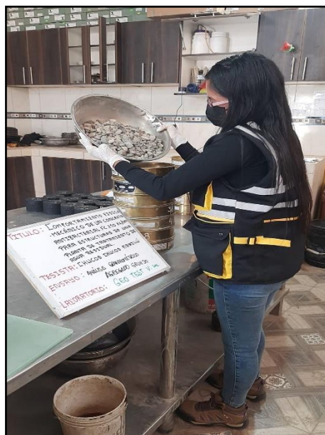
Fotografía 2: Ensayo de granulometría del agregado grueso, Tamaño Máximo Nominal (TMN) \frac{1}{2} "', Huso 6 de acuerdo a la NTP 400.012.
