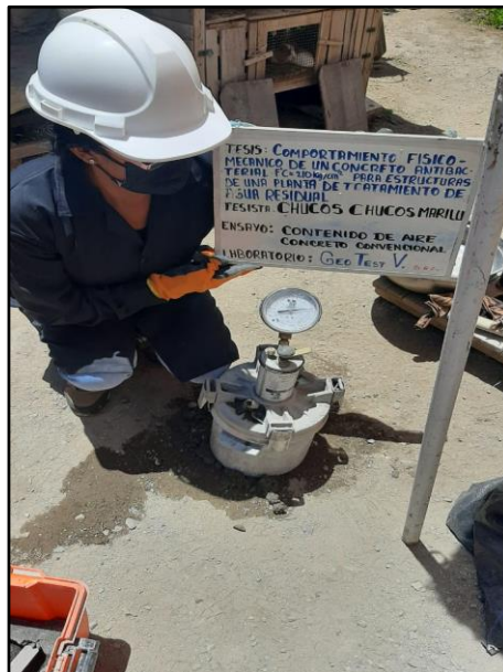
Fotografía 16: Control del contenido de aire del concreto fresco convencional por el método de presión. Según NTP 339.083.
