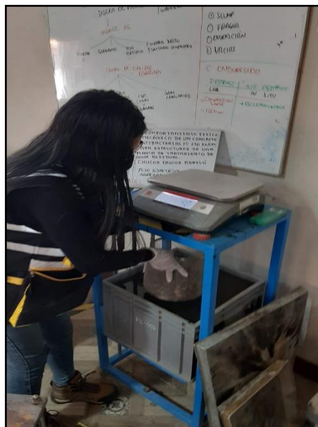
Fotografía 4: Realización del ensayo para determinar el Método de ensayo normalizado para peso específico y absorción del agregado grueso, según la NTP 400 021.
