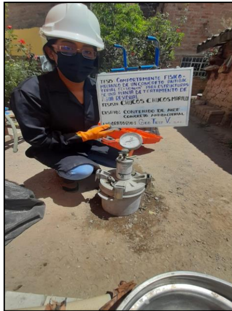
Fotografía 25: Control del contenido de aire del concreto fresco antibacterial por el método de presión. Según NTP 339.083.
