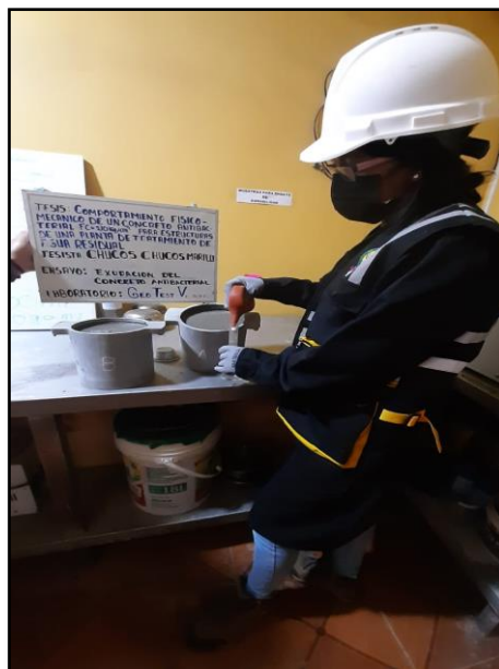
Fotografía 26: Control de la exudación del concreto antibacterial. Según NTP 339.077.
