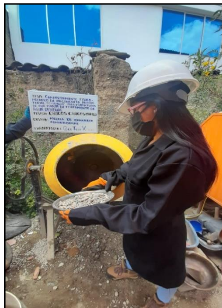
Fotografía 10: Vista de materiales tales como agregado grueso para la elaboración del concreto convencional. Según NTP 339.183.
