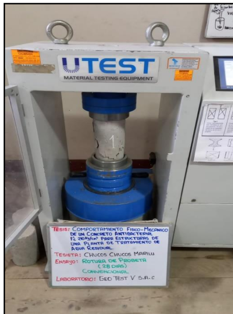
Fotografía 38: Introducción de probetas al equipo de compresión. Según la NTP 339.034 / ASTM C39.
