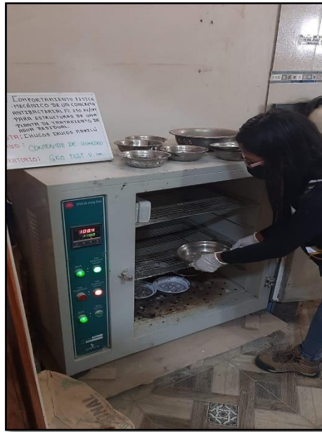
Fotografía 9: Desarrollo del ensayo para determinar el contenido de humedad del agregado según la NTP 339-185.
