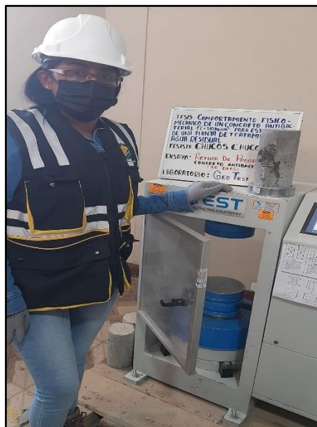
Fotografía 48: Introducción de probetas al equipo de compresión. Según la NTP 339.034 / ASTM C39.
