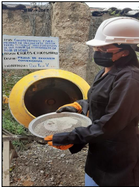
Fotografía 11: Vista de materiales tales como agregado fino para la elaboración del concreto convencional. Según NTP 339.183.
