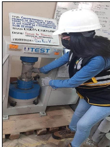
Fotografía 54: Introducción de probetas al equipo de compresión. Según la NTP 339.034 / ASTM C39
