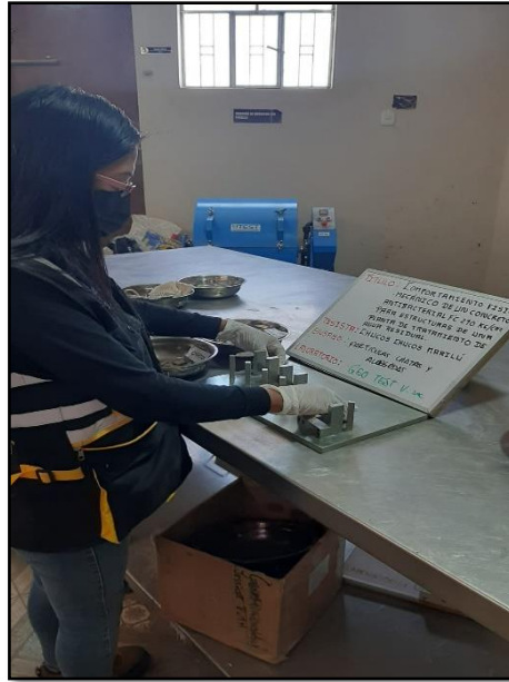
Fotografía 7: Realización Partículas Chatas o Alargadas en el Agregado. Grueso NTP 400.040.
