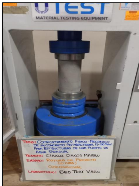
Fotografía 30: Introducción de probetas al equipo de compresión. Según la NTP 339.034 / ASTM C39.
