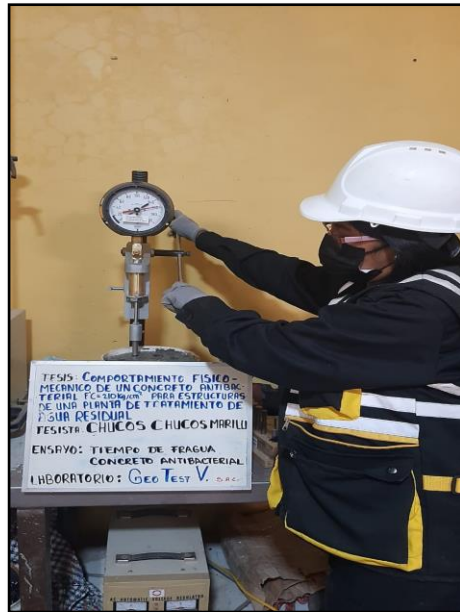
Fotografía 27: Lectura del tiempo de fraguado del concreto antibacterial. Según NTP 339.082.
