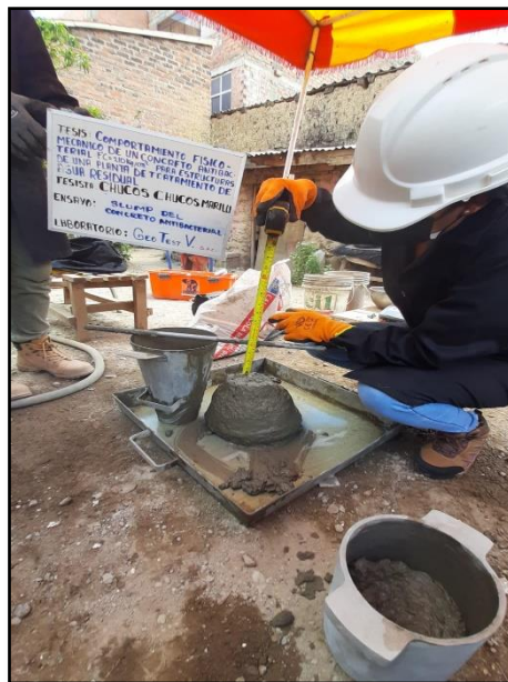
Fotografía 24: Medición del asentamiento del concreto fresco antibacterial. Según NTP 339.035.
