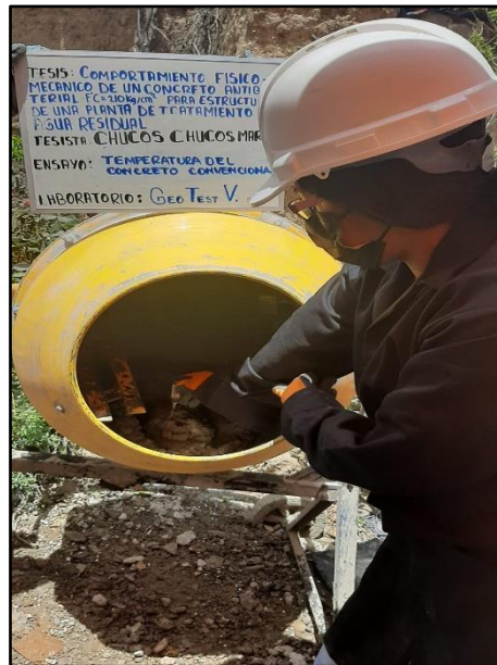
Fotografía 14: Medición de la temperatura del concreto convencional. Según NTP 339.184.
