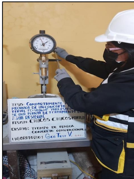
Fotografía 18: Lectura del tiempo de fraguado del concreto convencional. Según NTP 339.082.
