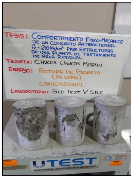
Fotografía 33: Testigos cilíndricos con sus respectivos tipos de fallas. Según la NTP 339.034 / ASTM C39
