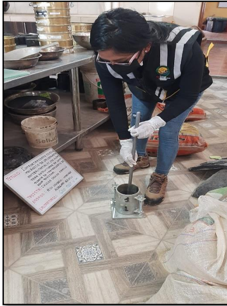
Fotografía 5: Realización del ensayo para determinar PUS-PUC del agregado grueso según la NTP 400.017.
