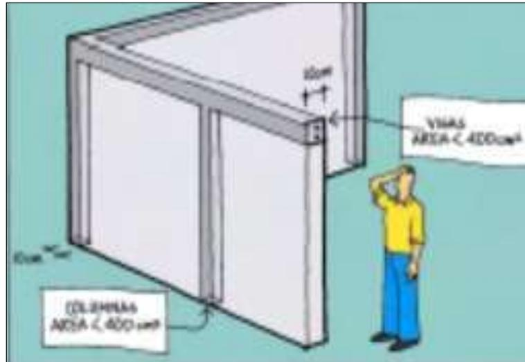
Figura 31. Los elementos de confinamiento no son de las dimensiones adecuadas
