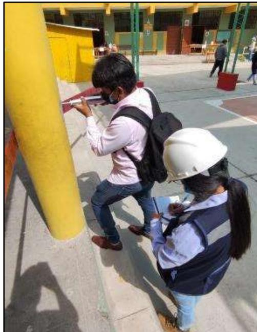
Fotografía N° 14. Toma de apuntes de los diferentes índices de rebote realizados en la columna circular CC-3, “Pabellón E”.
