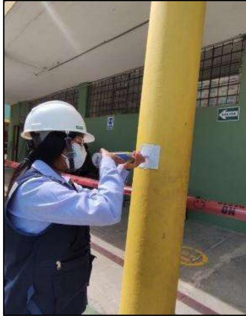
Fotografía N° 13. Toma de muestras según la norma ASTM C805 (Ensayo de Esclerometría), para la estimación de resistencia del concreto en la columna circular CC-3, “Pabellón E”.
