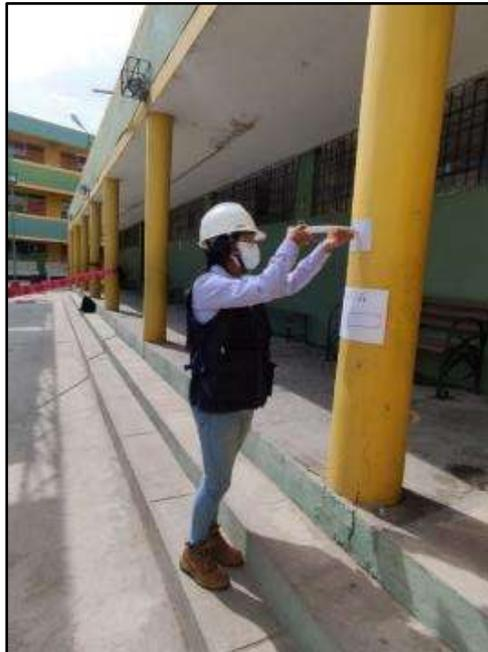
Fotografía N° 16. Toma de muestras según la norma ASTM C805 (Ensayo de Esclerometría), para la estimación de la resistencia del concreto en la columna circular CC-7, “Pabellón E”.
