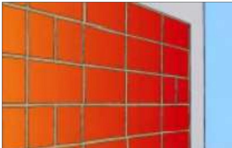
Figura 22. Unidades de albañilería con una mala distribución, falta de conexión
