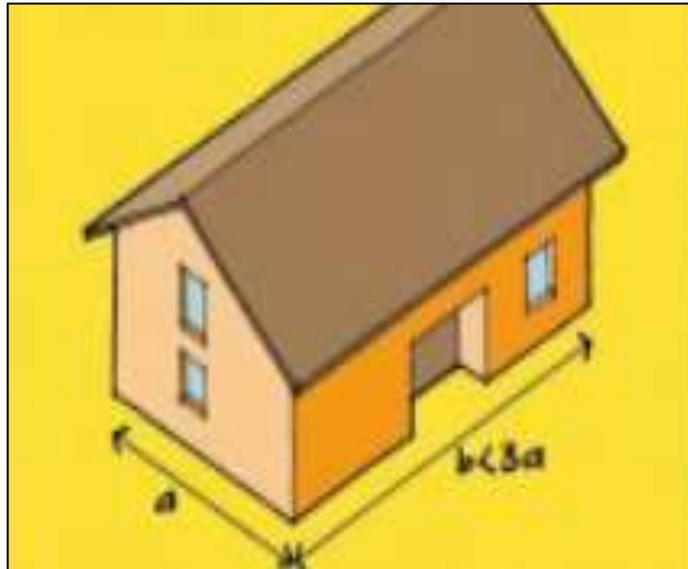
Figura 9. Representación de una edificación de la vulnerabilidad baja con una irregularidad en Planta
