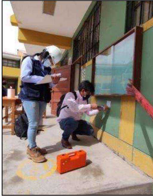
Fotografía N° 27. Registro de lectura de los índices de rebote según la norma ASTM C805 (Ensayo de Esclerometría), para la estimación de la resistencia del concreto en la columna C-6, “Pabellón D”.
