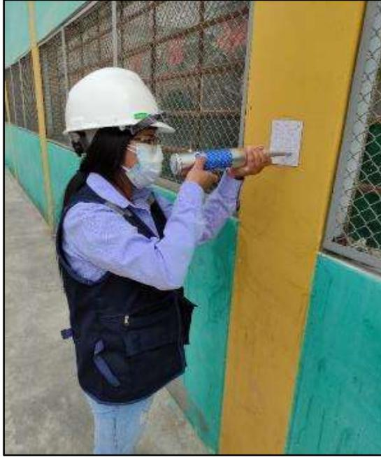
Fotografía N° 17. Toma de muestras según la norma ASTM C805 (Ensayo de Esclerometría), para la estimación de la resistencia del concreto en la columna C-9, “Pabellón E”.
