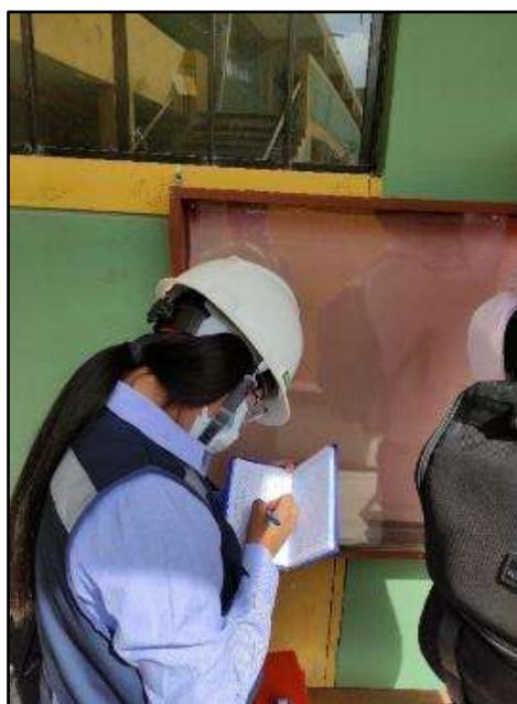
Fotografía N° 24. Registro de lectura de los índices de rebote según la norma ASTM C805 (Ensayo de Esclerometría), para la estimación de la resistencia del concreto en la columna C-2, “Pabellón D”.
