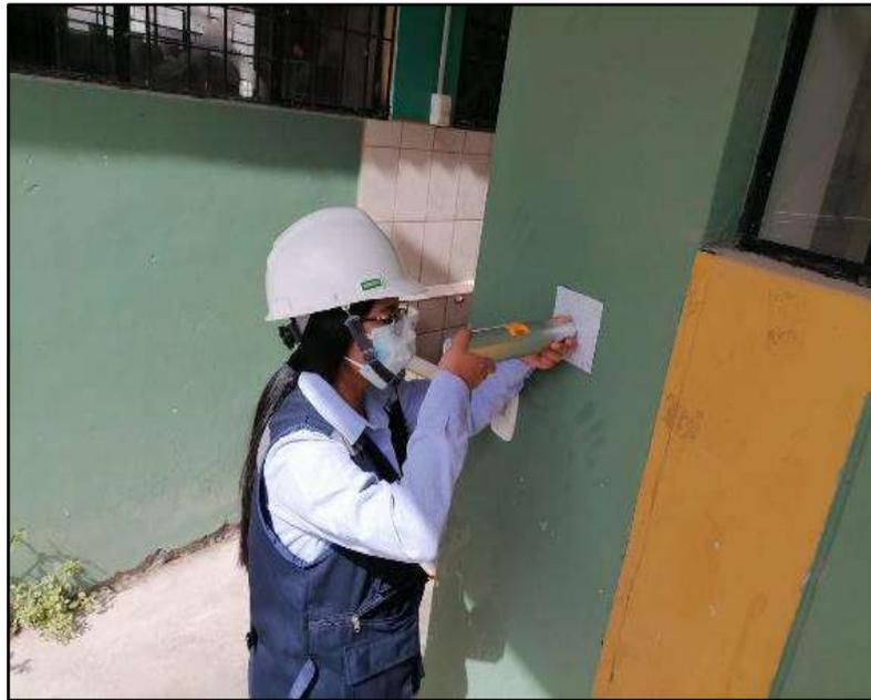
Fotografía N° 21. Toma de muestras según la norma ASTM C805 (Ensayo de Esclerometría), para la estimación de la resistencia del concreto en la columna C-1, “Pabellón D”.
