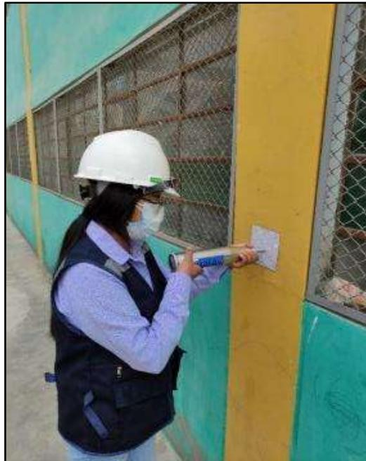
Fotografía N° 18. Toma de muestras según la norma ASTM C805 (Ensayo de Esclerometría), para la estimación de la resistencia del concreto en la columna C-11, “Pabellón E”.
