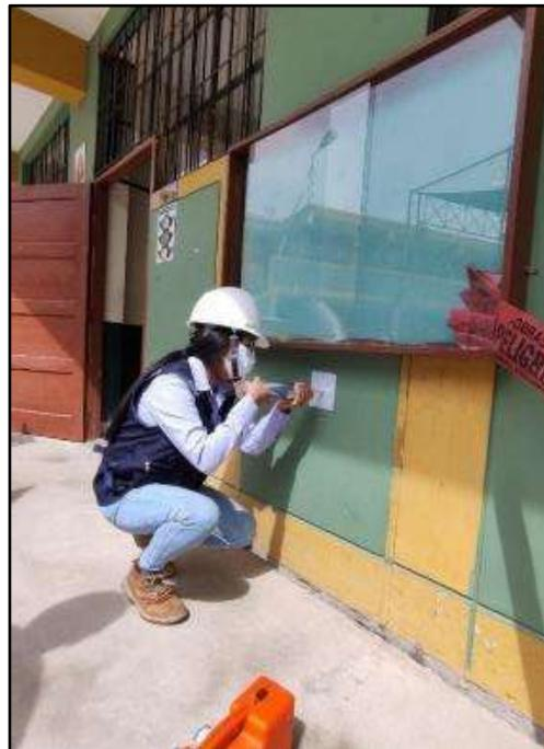
Fotografía N° 28. Toma de muestras según la norma ASTM C805 (Ensayo de Esclerometría), para la estimación de la resistencia del concreto en la columna C-6, “Pabellón D”.
