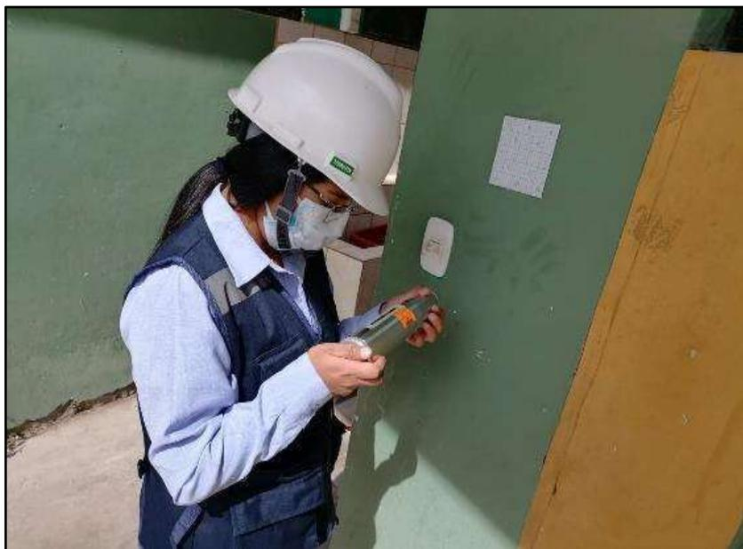
Fotografía N° 22. Lectura de los índices de rebote según la norma ASTM C805 (Ensayo de Esclerometría), para la estimación de la resistencia del concreto en la columna C-1, “Pabellón D”.
