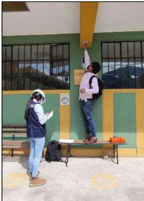
Fotografía N° 26. Toma de muestras según la norma ASTM C805 (Ensayo de Esclerometría), para la estimación de la resistencia del concreto en la viga VP-102, “Pabellón D”.
