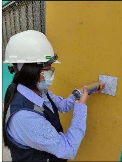
Fotografía N° 19. Toma de muestras según la norma ASTM C805 (Ensayo de Esclerometría), para la estimación de la resistencia del concreto en la columna C-14, “Pabellón E”.
