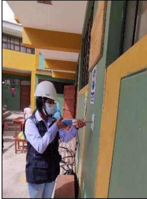
Fotografía N° 25. Toma de muestras según la norma ASTM C805 (Ensayo de Esclerometría), para la estimación de la resistencia del concreto en la columna C-4, “Pabellón D”.
