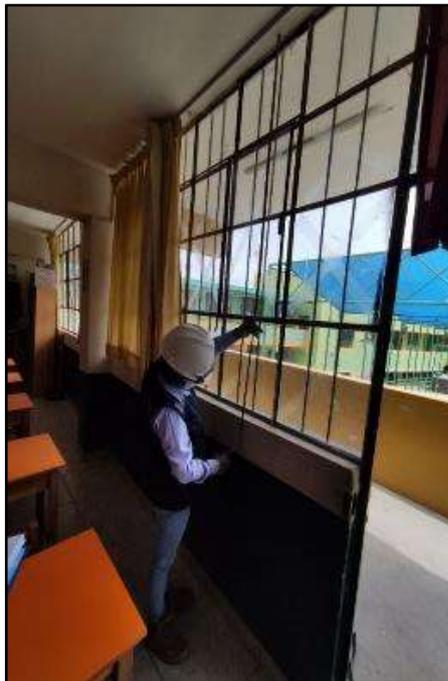
Fotografía N° 66. Registro y medición de altura de ventana, ubicado en el eje 2, aula N°5 – 2do piso, Pabellón “E”.
