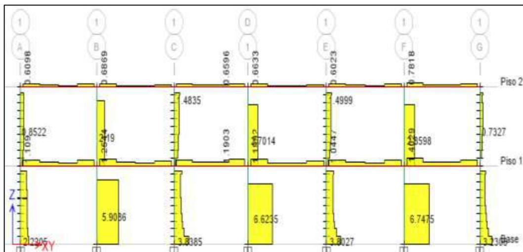
Figura 96. Diagrama de cortante Columna Corta Eje 1
