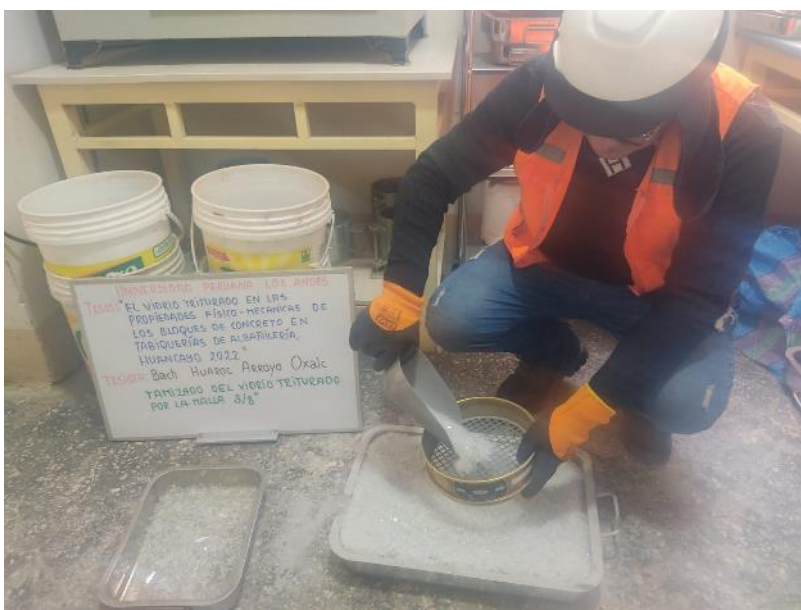
Figura 15. Tamizado del vidrio triturado por la malla #4.
