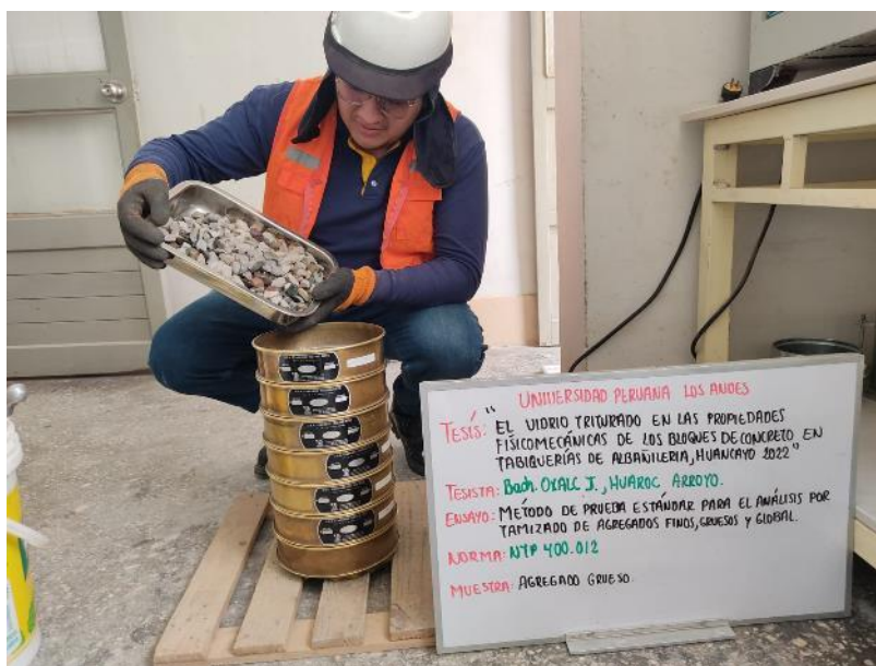
Figura 17. Granulometría de los agregados por tamizado.
