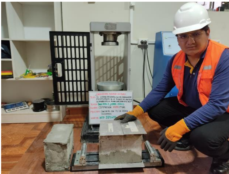
Figura 26. Colocado de placas metálicas en el bloque de concreto.
