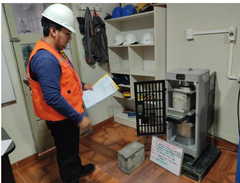
Figura 27. Ensayo de rotura a compresión de bloques de concreto.
