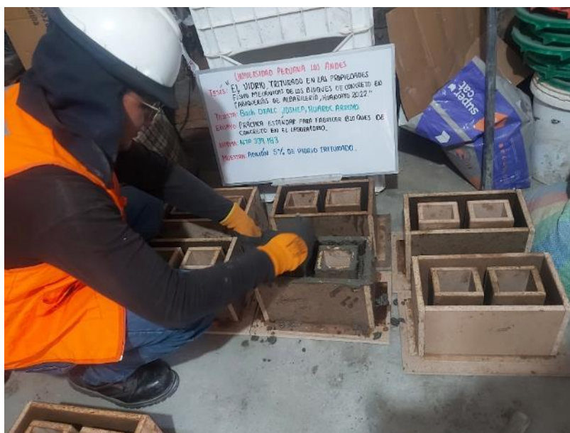
Figura 21. Moldeado de los bloques de concreto con adición.
