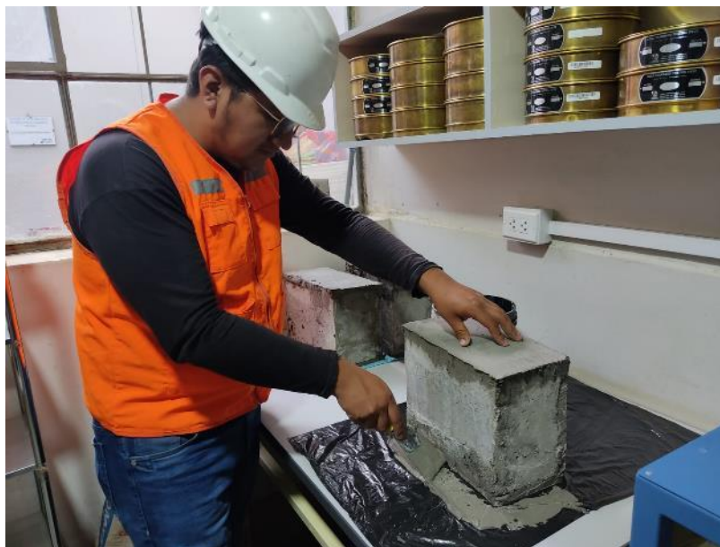
Figura 25. Refrentado de los bloques de concreto.
