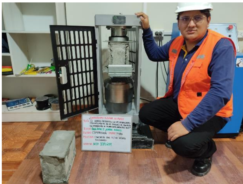
Figura 28. Resistencia máxima a compresión del bloque de concreto.
