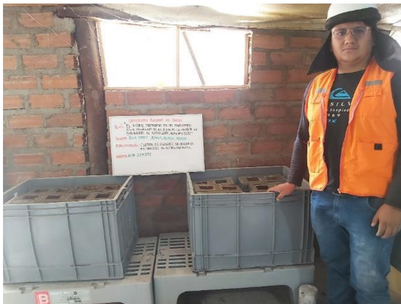
Figura 23. Curado de los bloques de concreto.
