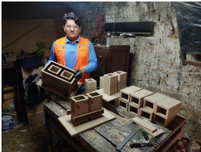
Figura 20. Fabricación de moldes de los bloques de concreto.
