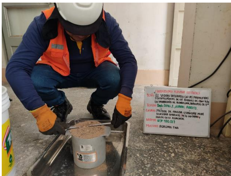
Figura 19. Ensayo de peso unitario de los agregados.
