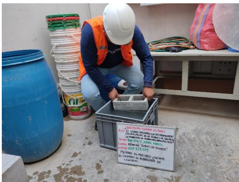
Figura 29. Saturación del bloque de concreto para el ensayo de absorción.
