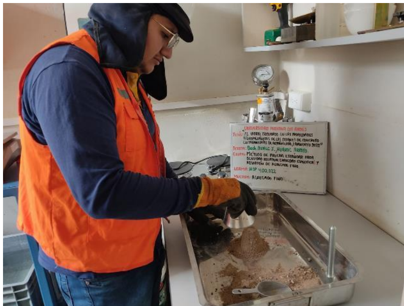
Figura 18. Ensayo de peso específico del agregado fino.
