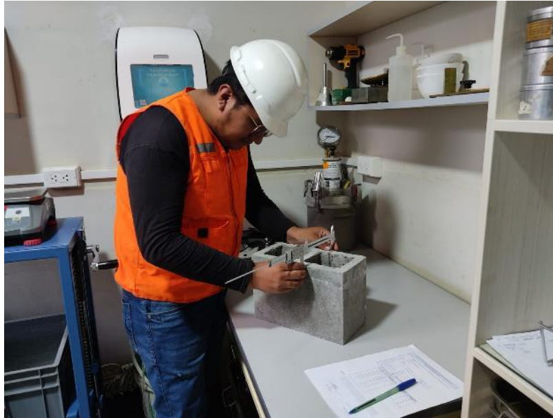
Figura 24. Toma de medidas de los bloques de concreto.
