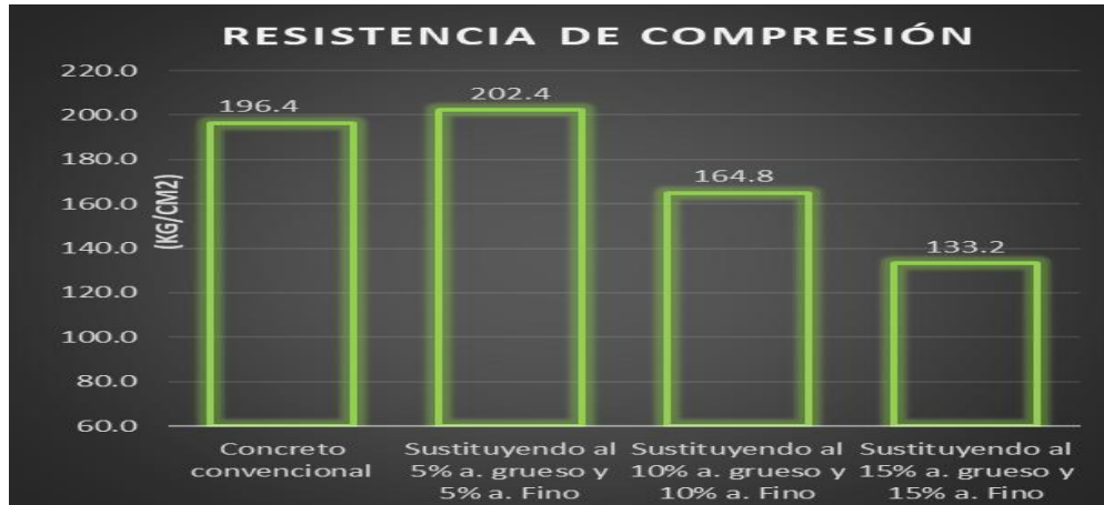
Figura 26: Resistencia a la compresión del Teknoblok
