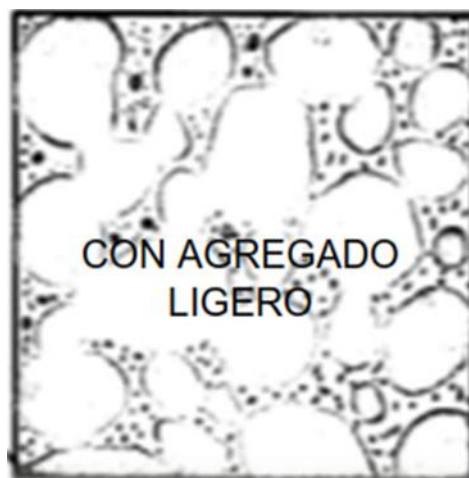
Figura 9: Concreto con agregado ligero
