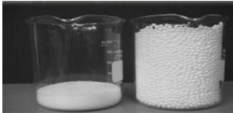
Figura 15: Pre-expansión del poliestireno antes y después
