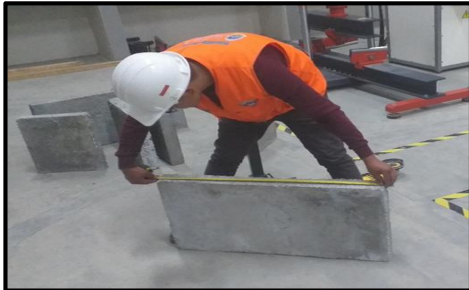
Fotografía N° 15. Medición del Teknoblok, la variación dimensional se realiza para poder ver qué clase de bloque y para que se puede utilizar, se realiza midiendo al milímetro todas las caras del bloque
