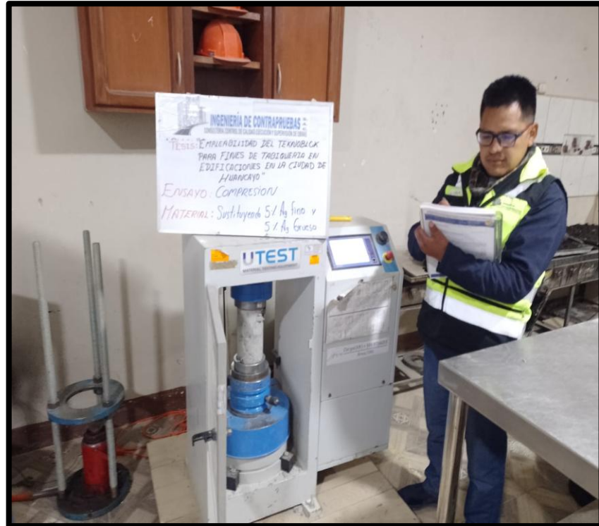
Fotografía N° 14. Resistencia a la compresión
